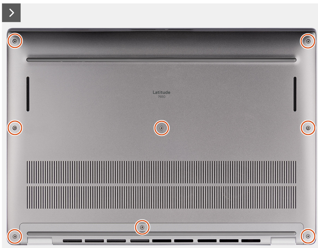
איור 12. הסרת כיסוי הבסיס
