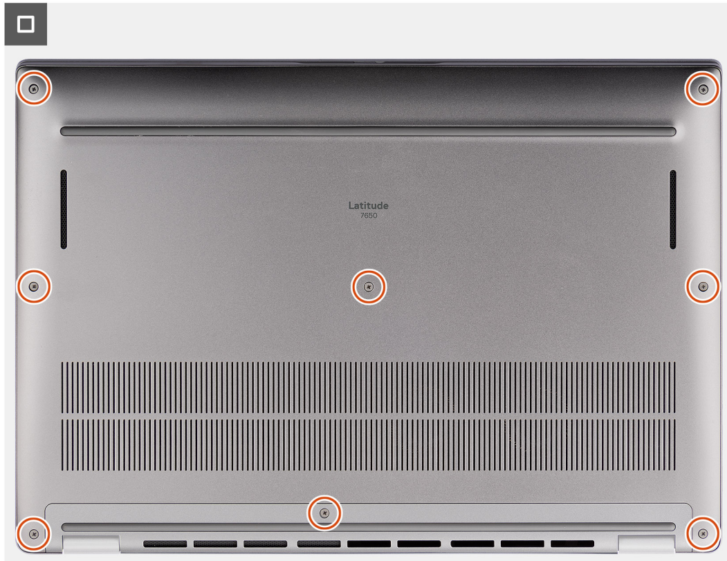
איור 17. התקנת כיסוי הבסיס
