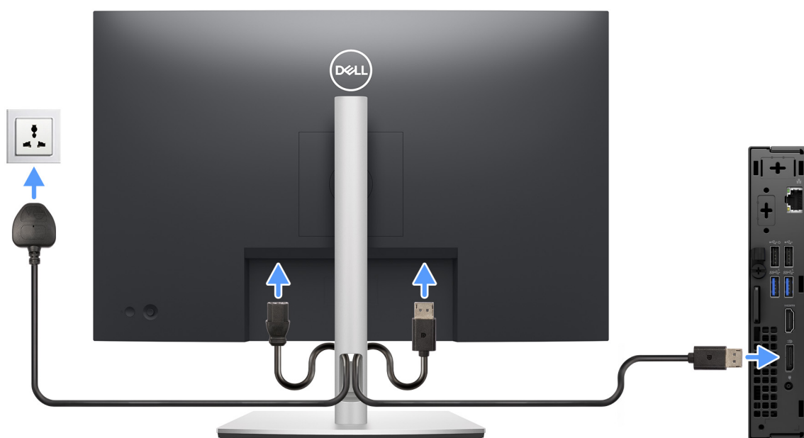
Rysunek 5. Podłączanie monitora
