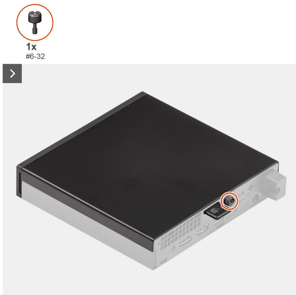
Rysunek 9. Wymontowywanie pokrywy bocznej
