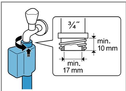
2. Aprire con precauzione il rubinetto dell'acqua e controllare la tenuta dei collegamenti.
