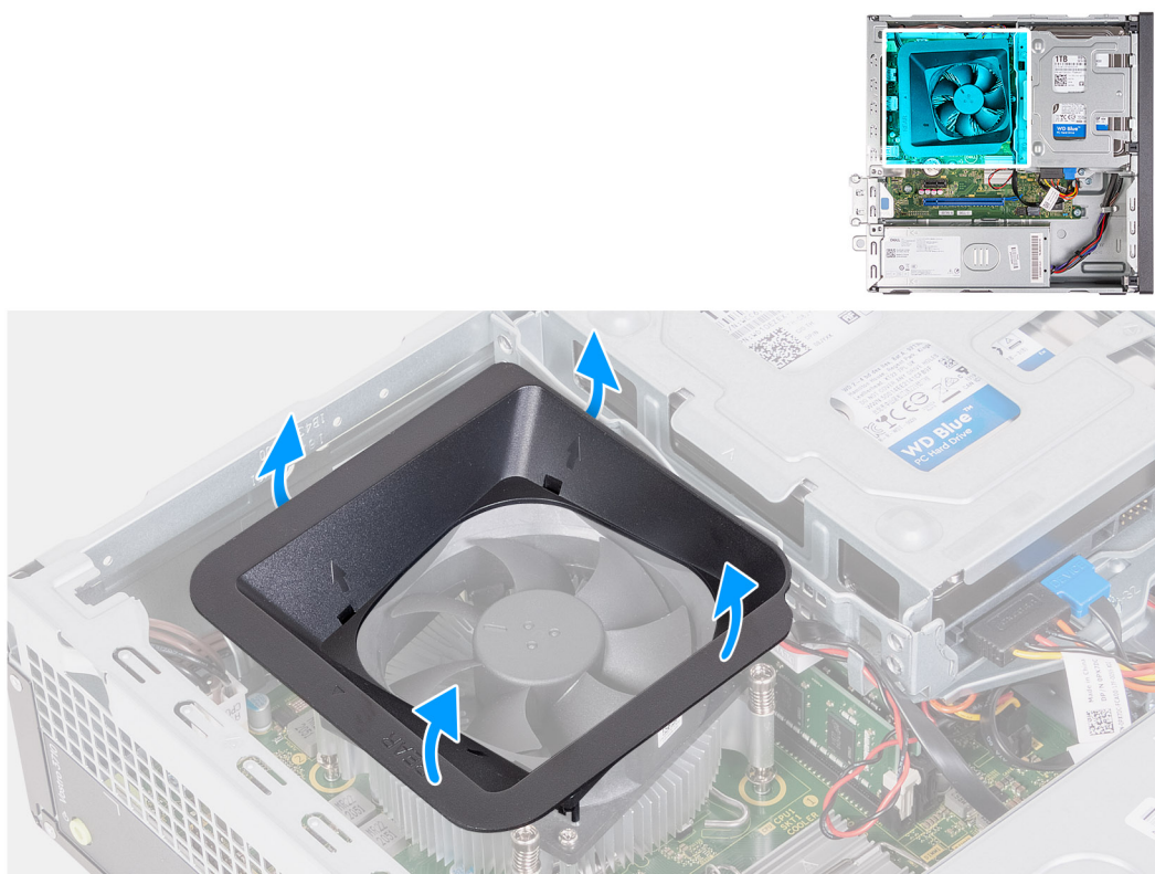
Figure 34. Retrait du carénage du ventilateur
