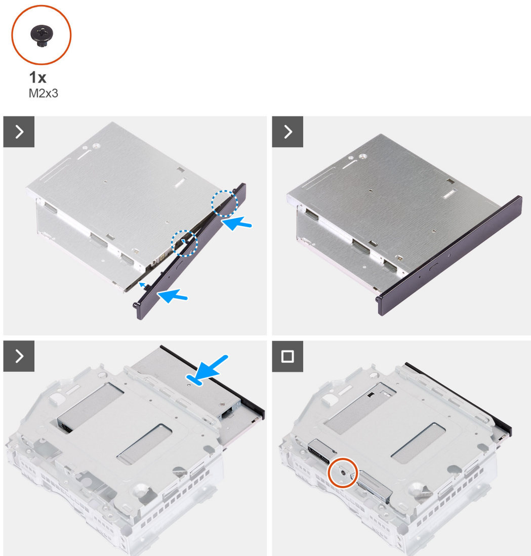
Figure 21. Installation du lecteur optique
