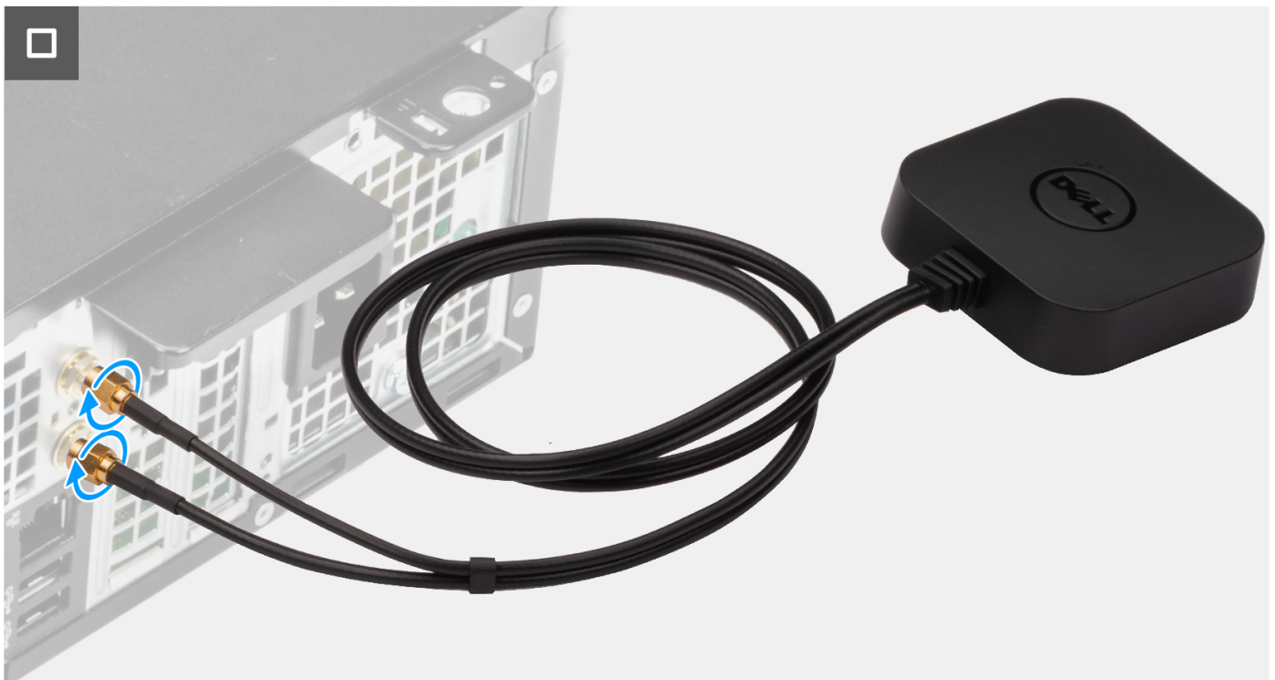
Afbeelding 39. De externe antenne plaatsen
