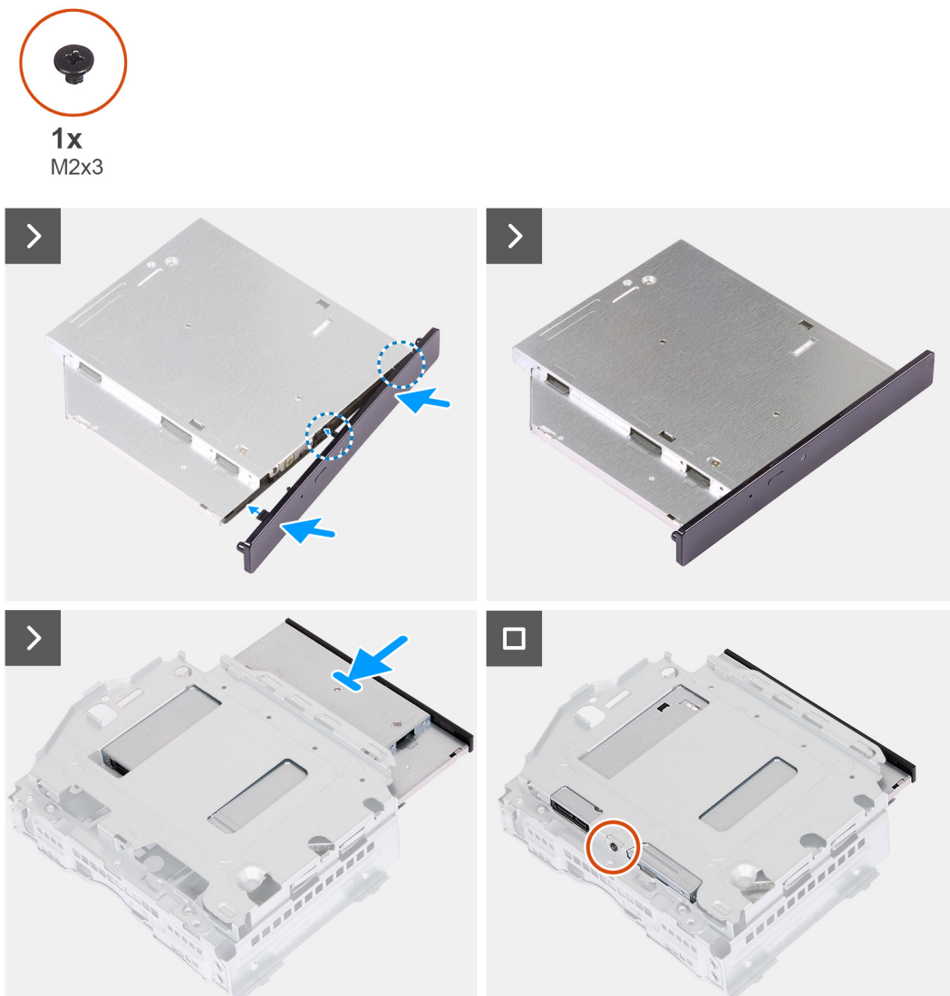
Afbeelding 21. Het optisch station plaatsen
