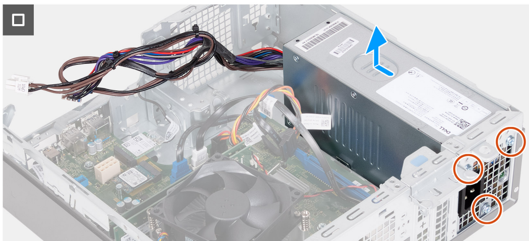
Figure 41. Retrait du bloc d'alimentation
