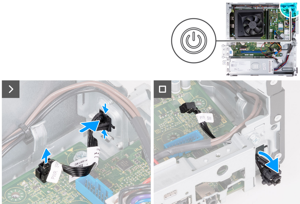
Figure 22. Retrait du bouton d'alimentation
