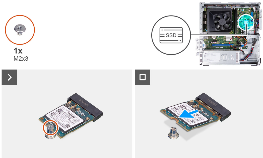
Figure 26. Retrait du disque SSD M.2 2230
