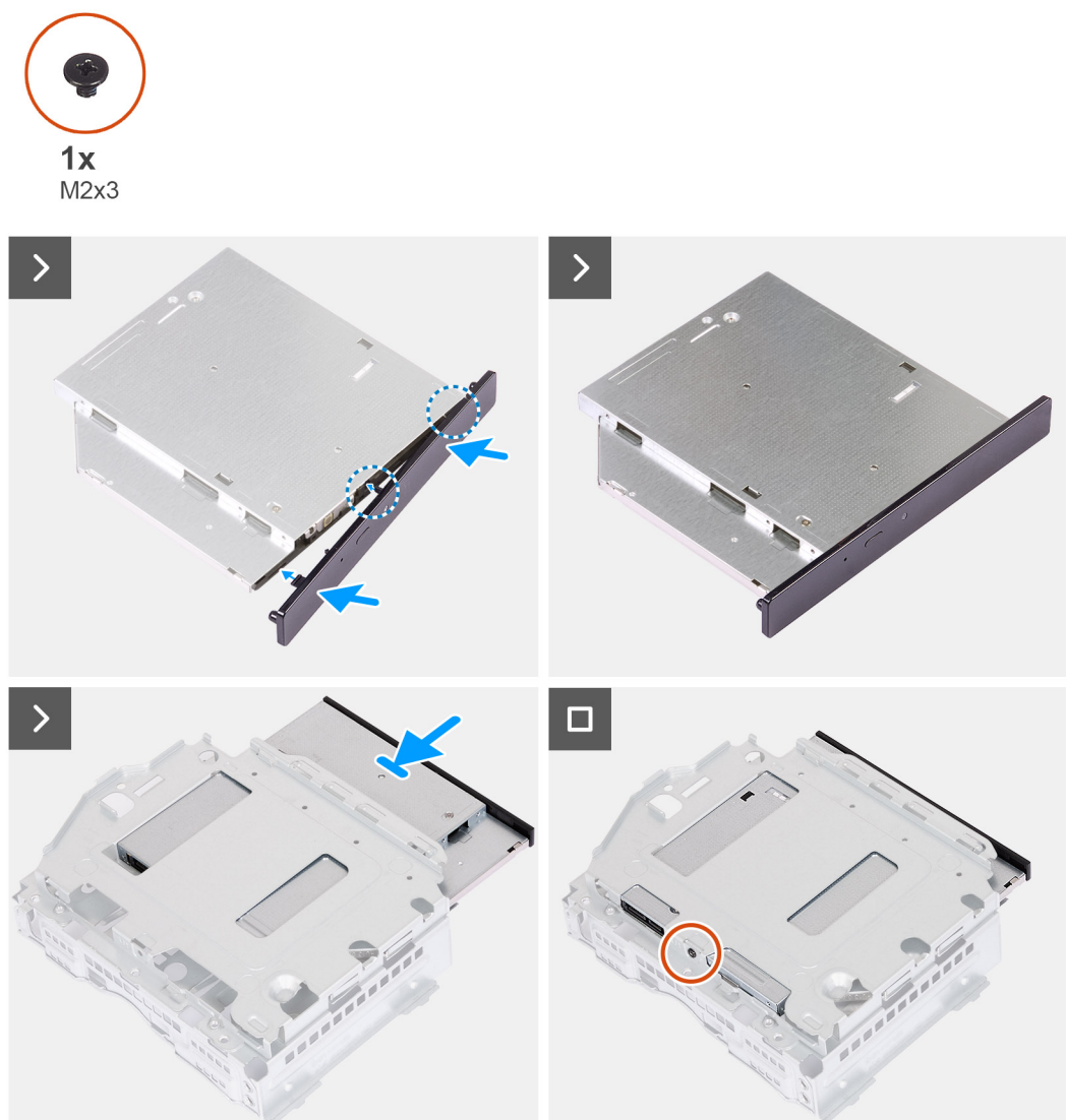
Figure 21. Installation du lecteur optique
