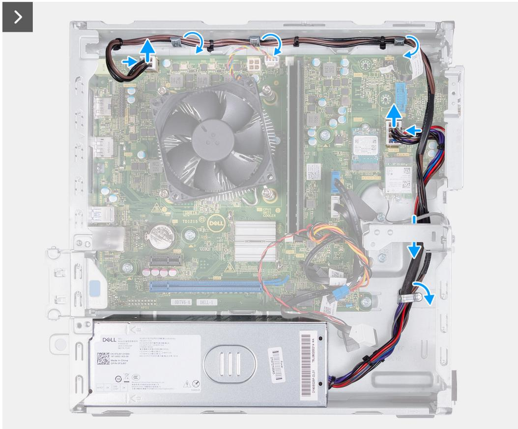
Abbildung 40. Entfernen aller Kabel aus den Kabelführungen
