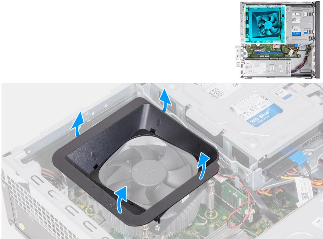
Abbildung 34. Entfernen der Lüfterverkleidung
