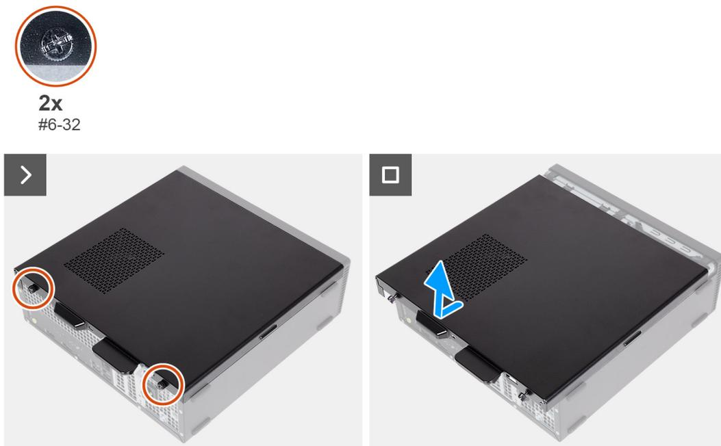
Abbildung 12. Entfernen der linken Abdeckung
