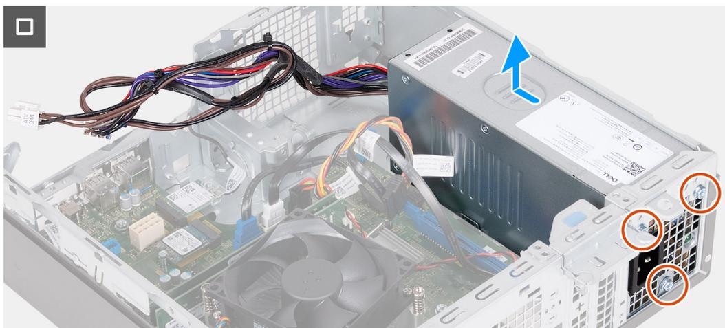
Abbildung 41. Entfernen des Netzteils
