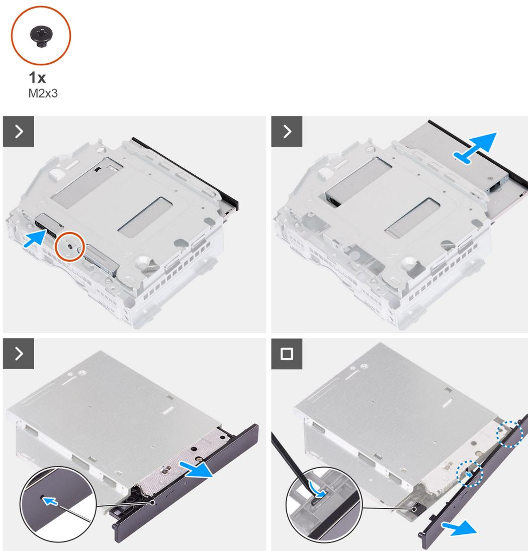
Abbildung 20. Entfernen des optischen Laufwerks
