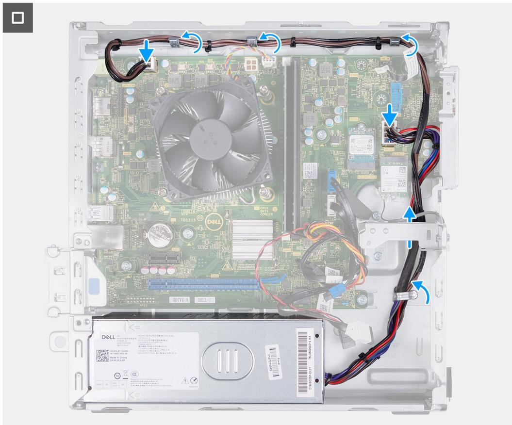
**Abbildung 43. Verlegen der Kabel durch die Kabelführungen**
