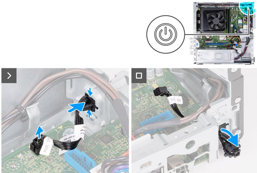
Abbildung 22. Entfernen des Netzschalters
