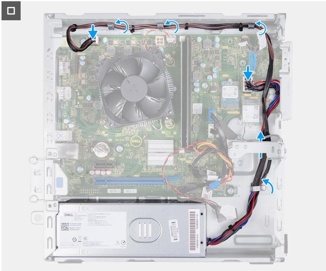
**Figura43. Encaminhar os cabos através das guias de encaminhamento**
