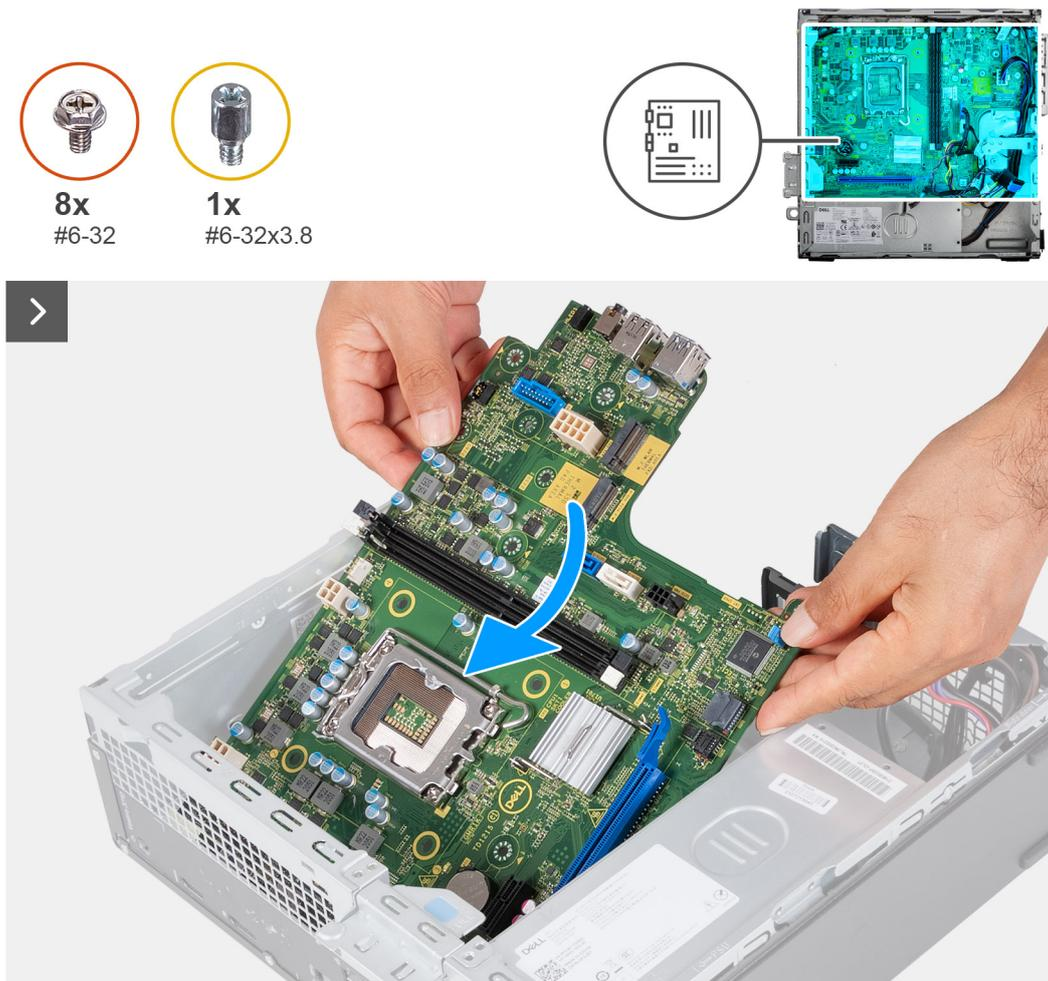
**Figura57. Colocar a placa de sistema no chassis**
