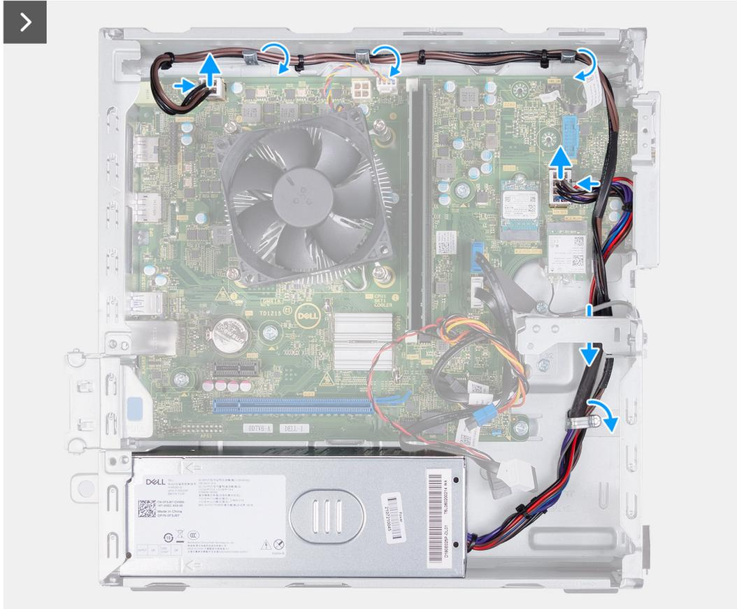
Figura40. Retirar os cabos das guias de encaminhamento
