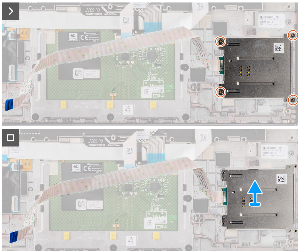
Figur 46. Ta bort smartkortläsaren
