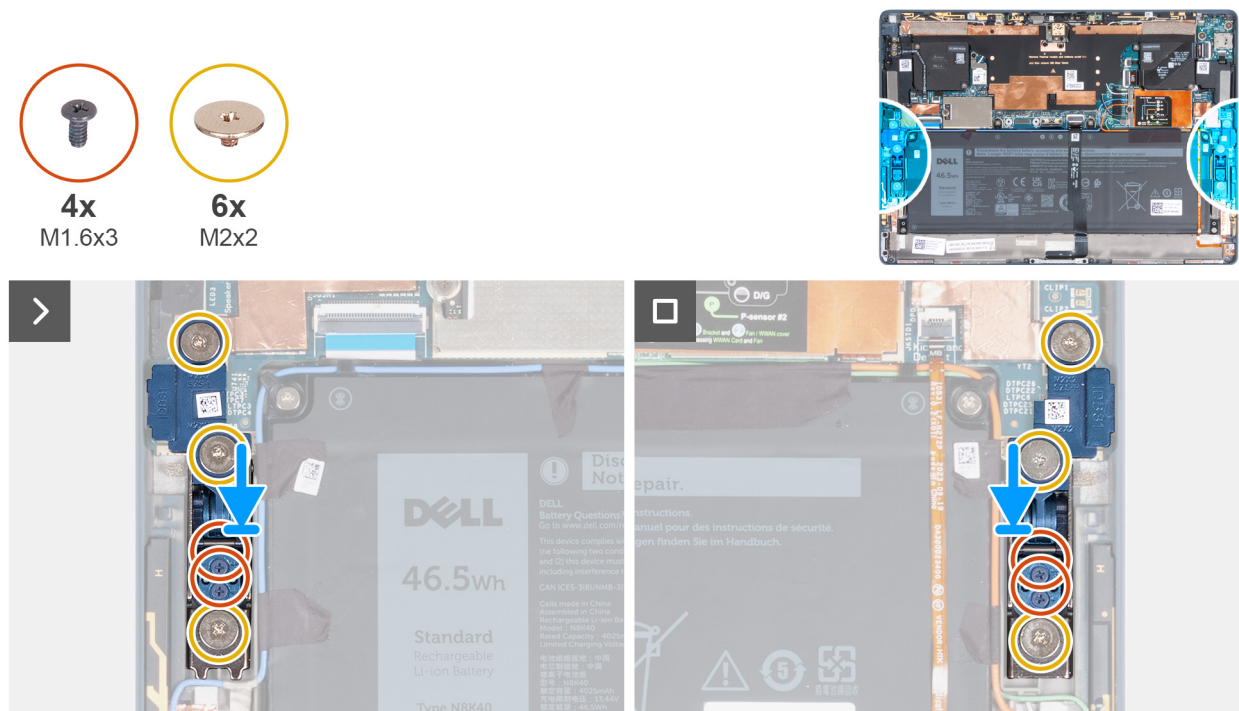
Figur 56. Installera gångjärnen på det utfällbara stödet
