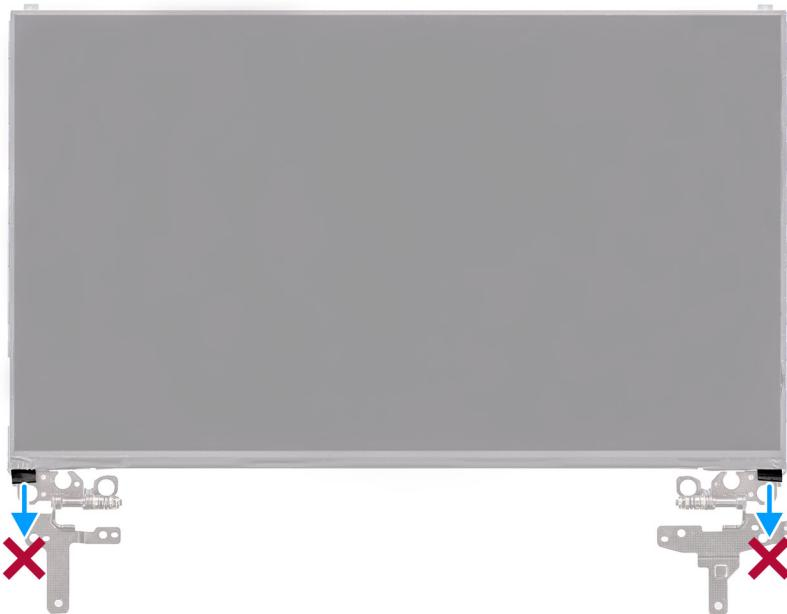
1. Ta bort de sex skruvarna (M2,5x2,5) som håller fast det vänstra och högra skärmgångjärnet på skärmens baksida.
