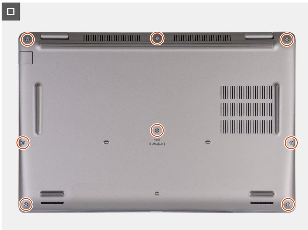
Figure 18. Serrage des vis imperdables
