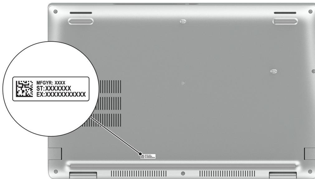
Figure 7. Image : emplacement de l'étiquette de service
