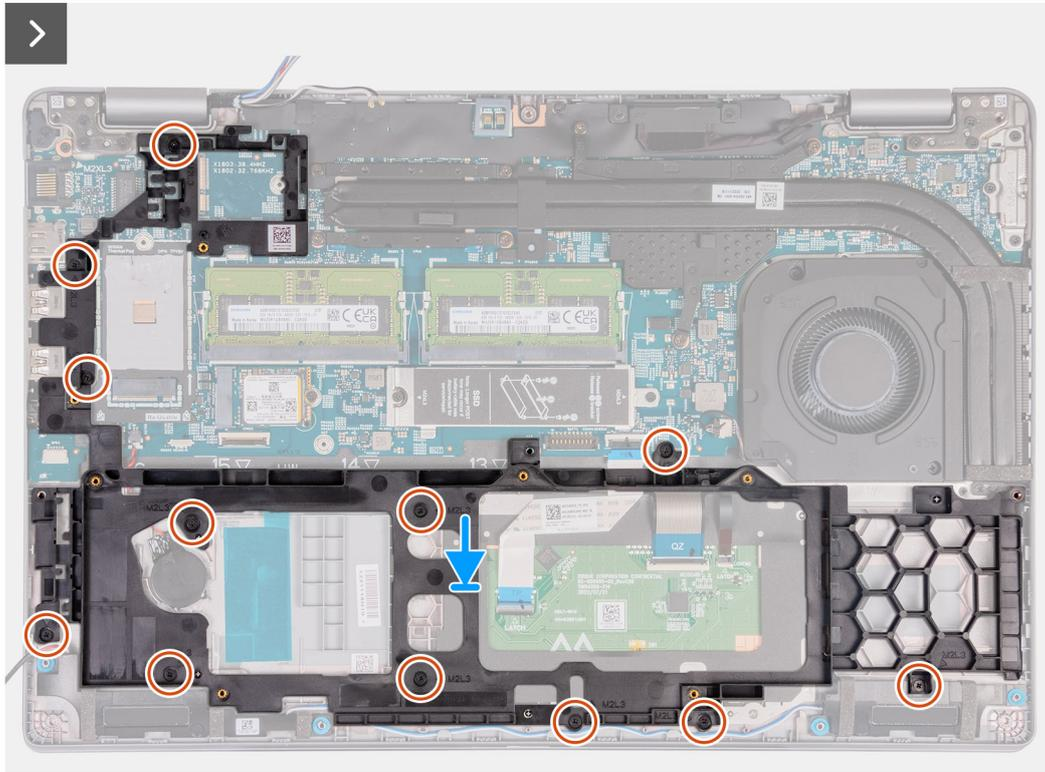
Figure 39. Installation du cadre interne de l'assemblage
