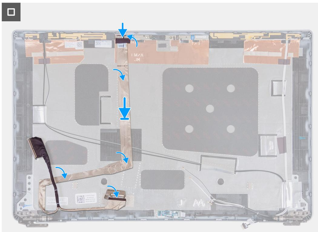
Figure 91. Installation du câble de l'écran
