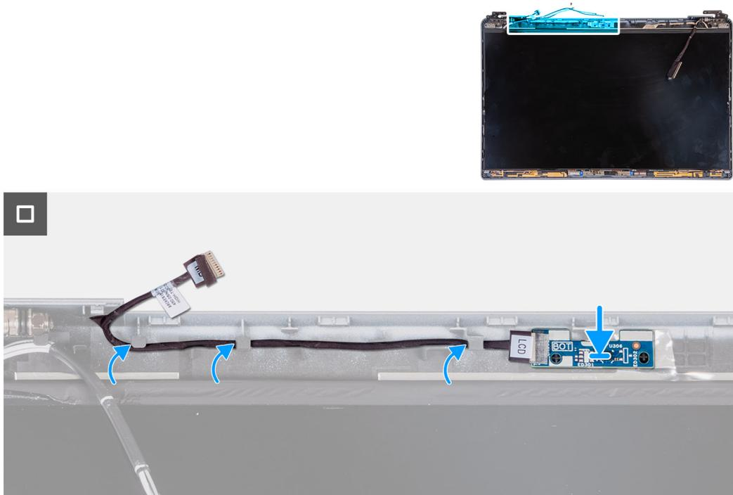
Figure 93. Installation de la carte des capteurs
