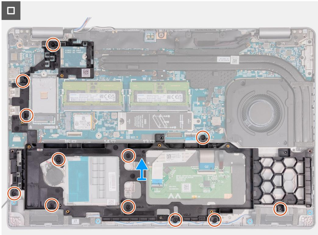
Figure 38. Retrait du cadre interne de l'assemblage
