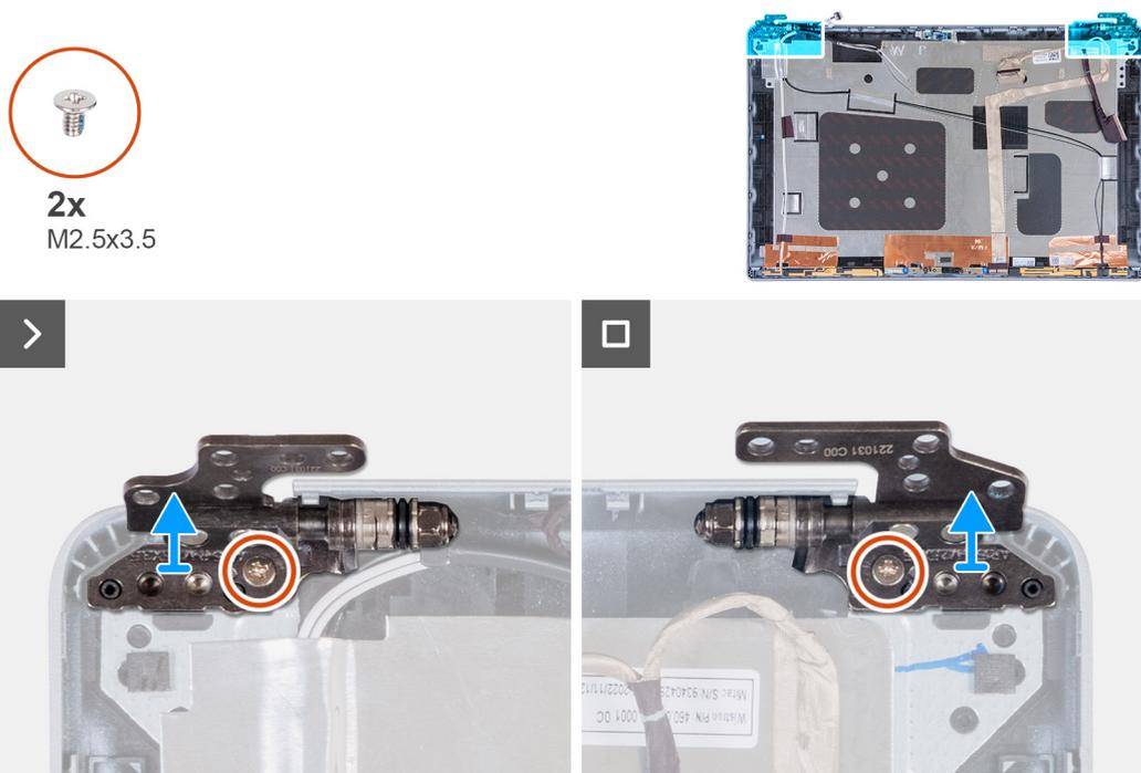
**Ilustración 86. Extracción de las bisagras de la pantalla**
