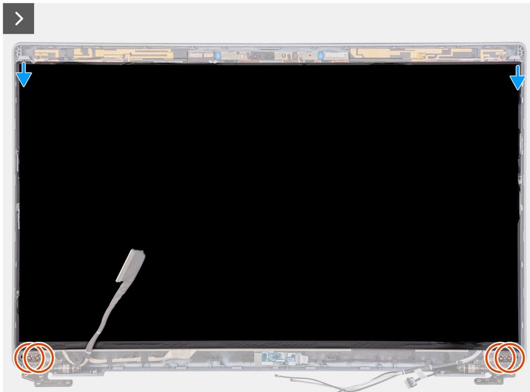
**Ilustración 76. Extracción del panel de pantalla**
