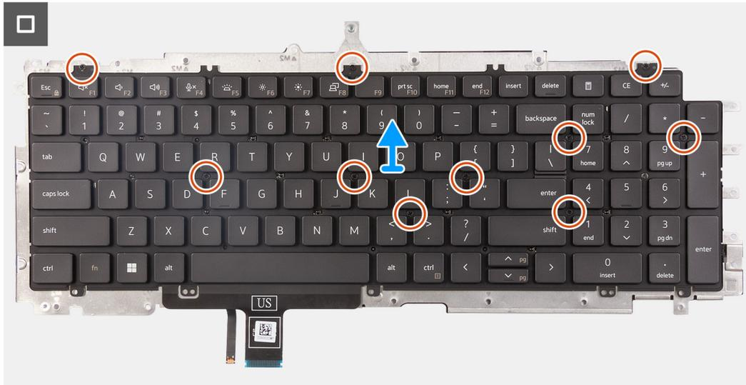
**Ilustración 66. Extracción del teclado**
