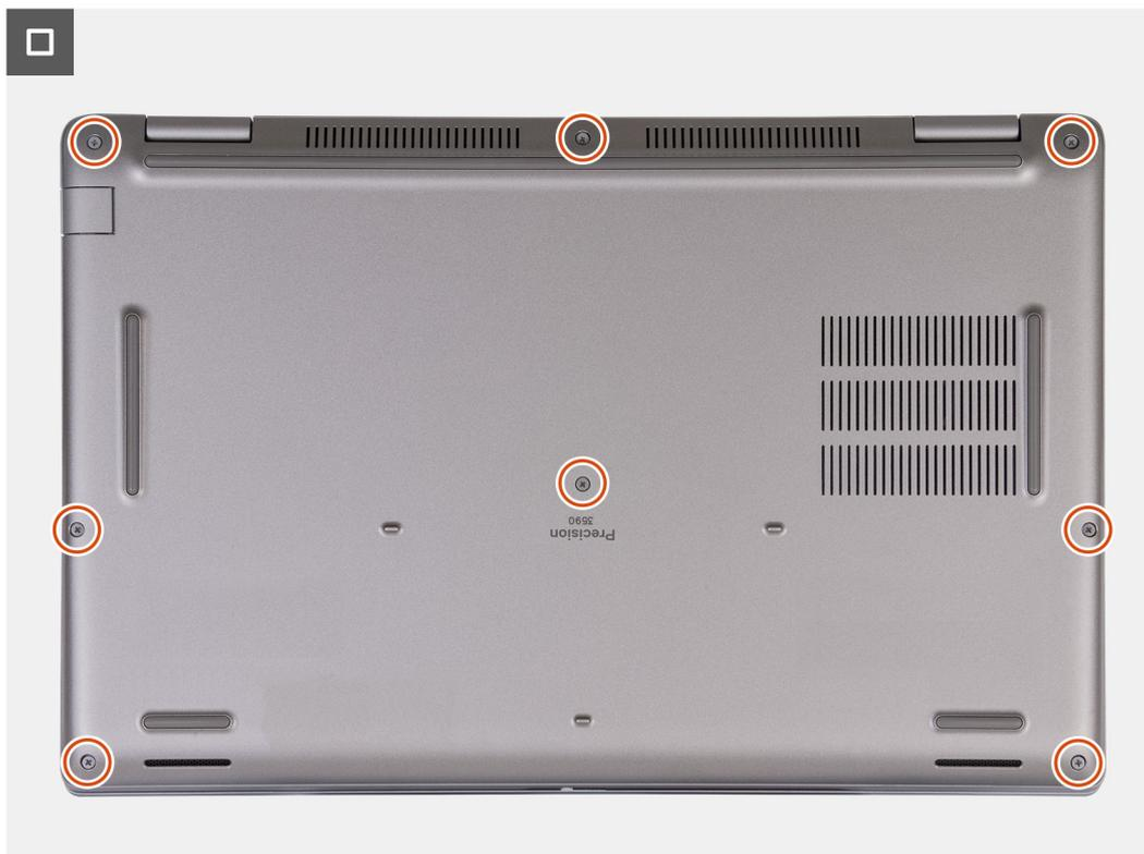
**Ilustración 18. Ajuste de los tornillos cautivos**
