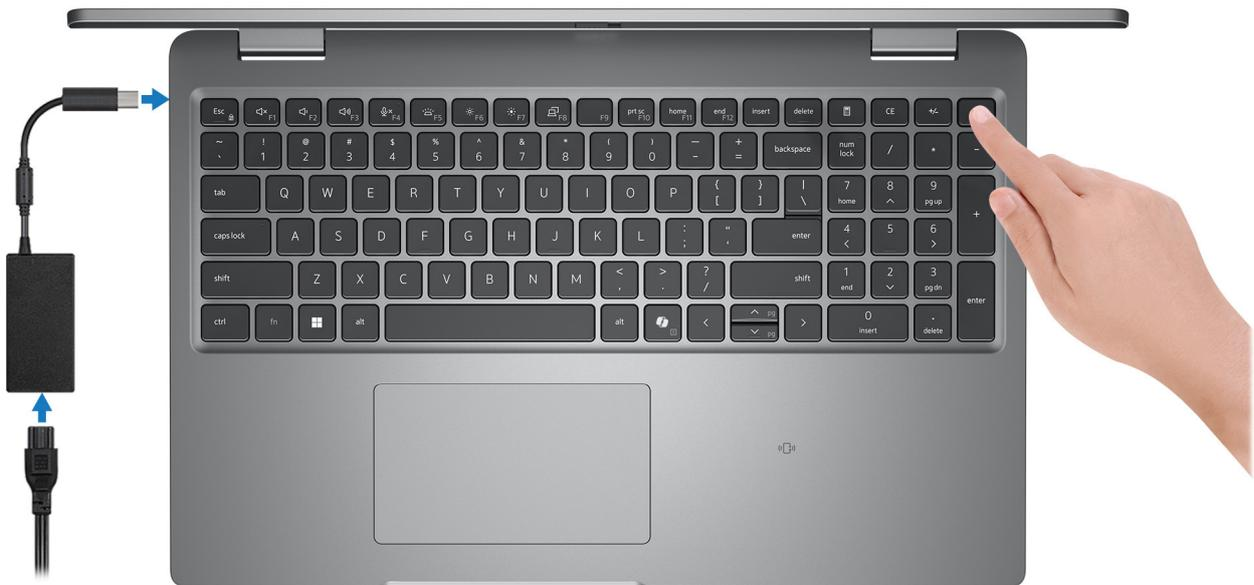
**Ilustración 8. Conecte el adaptador de alimentación y presione el botón de encendido**
