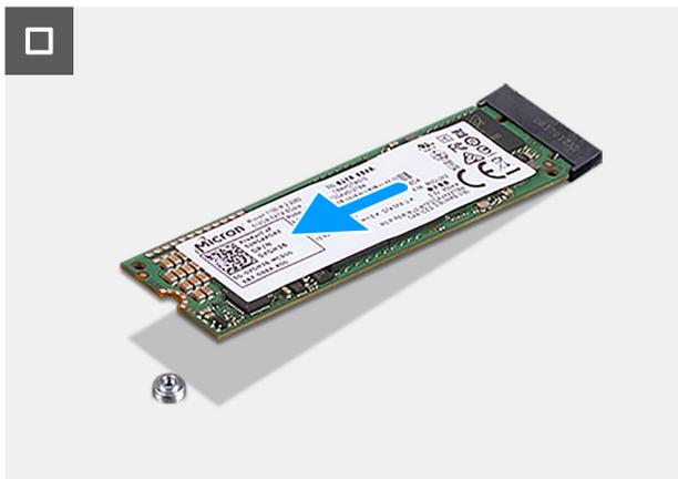
Figura24. Retirar o disco de estado sólido M.2 2280 PCIe
