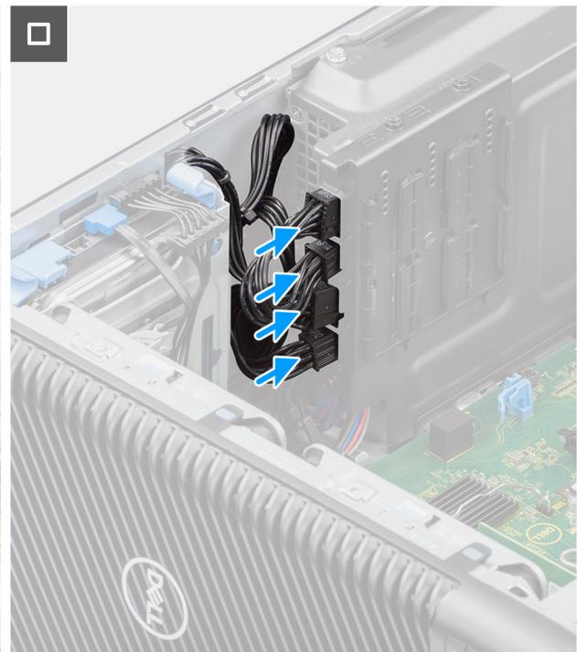
**Figura47. Instalar a tampa da unidade de fonte de alimentação**
