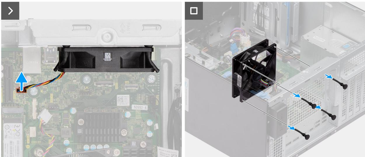
**Figura64. Retirar a ventoinha traseira de sistemas com PSU de 300 W**
