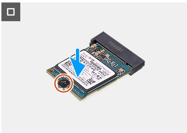
Figura23. Instalar o disco de estado sólido M.2 2230 PCIe
