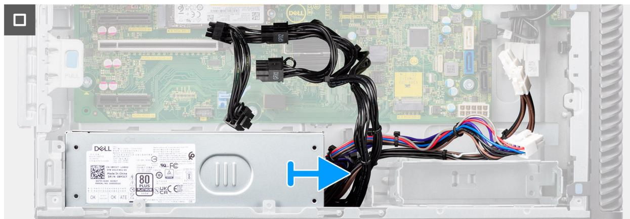
**Figura49. Retirar a unidade de fonte de alimentação de 1000 W**
