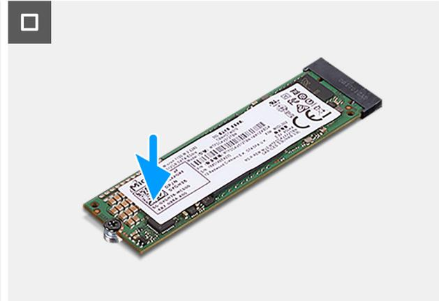
Figura25. Instalar o disco de estado sólido M.2 2280 PCIe
