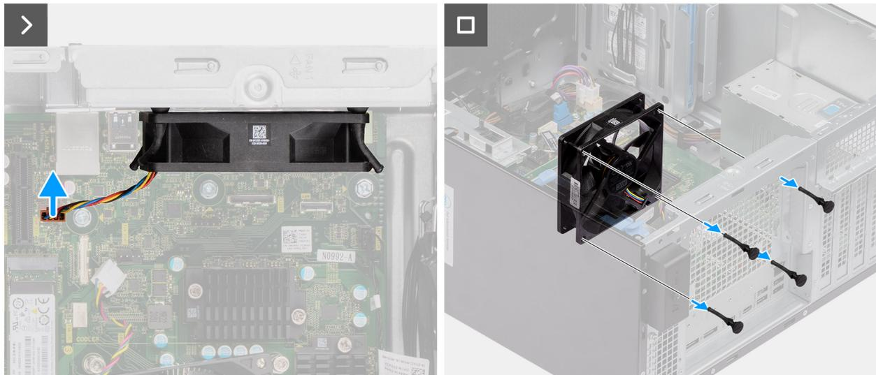
**Ilustración 64. Extracción del ventilador posterior para sistemas de PSU de 300 W**
