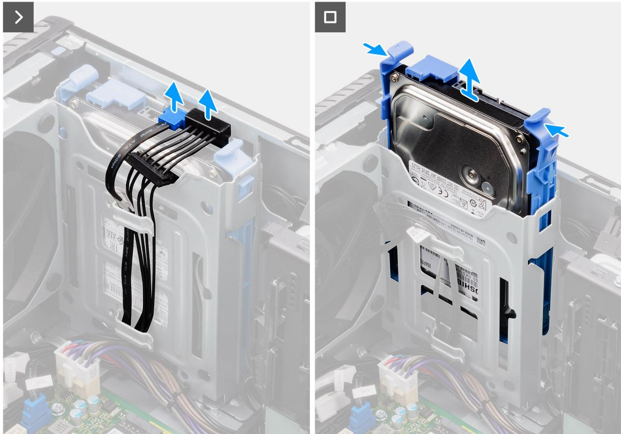
**Ilustración 17. Extracción del ensamblaje de unidad de disco duro de 3,5 pulgadas (Bahía 2)**
