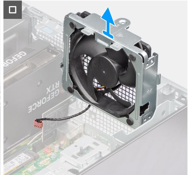
**Ilustración 66. Extracción del ventilador posterior (PSU de 1000 W)**
