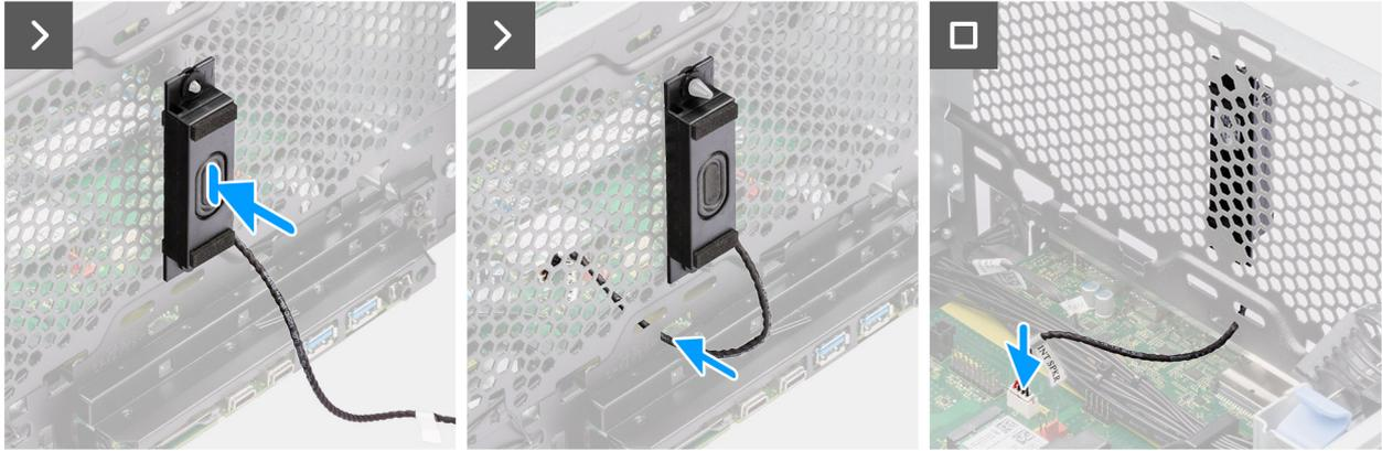
**Ilustración 73. Instalación del altavoz interno**
