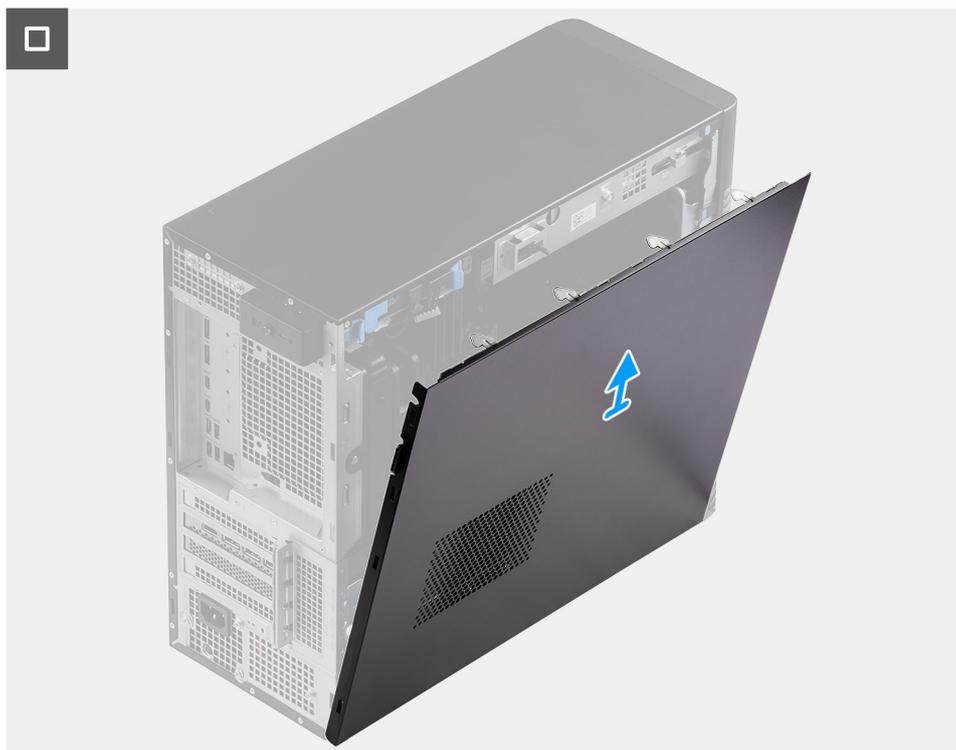
**Ilustración 9. Extracción de la cubierta lateral**
