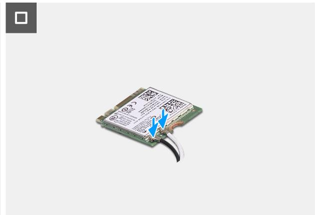
**Ilustración 26. Extracción de la tarjeta WLAN**
