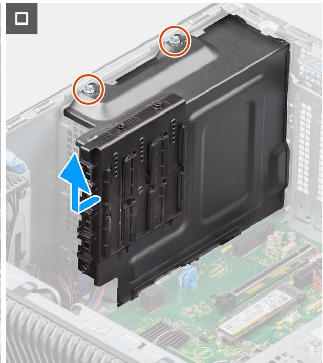
**Ilustración 46. Extracción de la cubierta de la fuente de alimentación**
