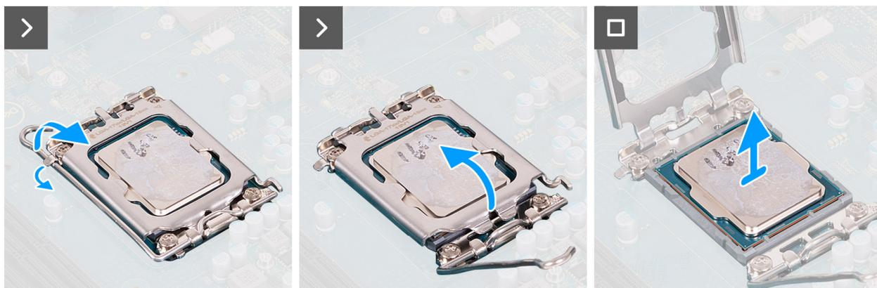
Ilustración 56. Extracción del procesador
