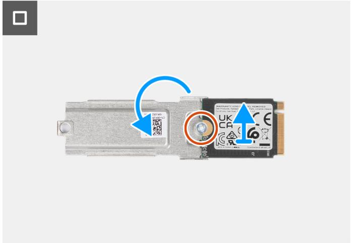
**Ilustración 19. Extracción de la unidad de estado sólido PCIe M.2 2230 (ranura 2)**
