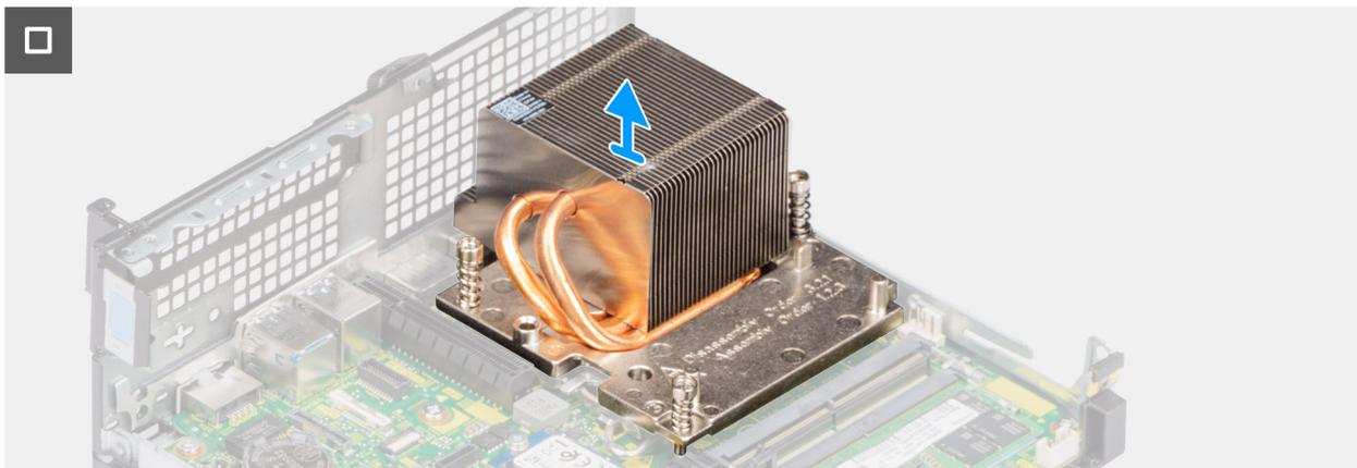
**Ilustración 38. Extracción del disipador de calor**
