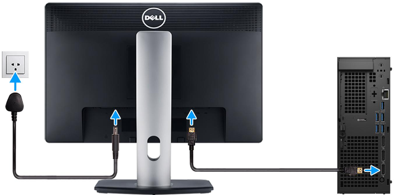
**Ilustración 5. Conecte la pantalla**
