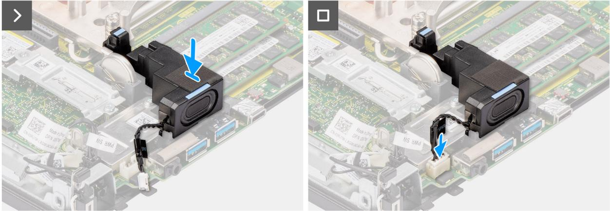
**Ilustración 33. Instalación del parlante**
