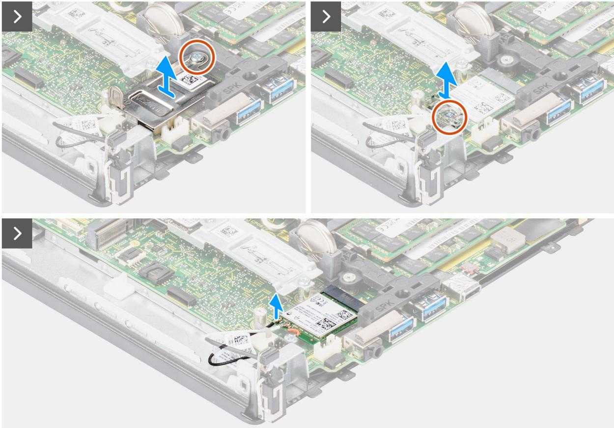
**Ilustración 54. Extracción de la antena interna: ubicación 2**
