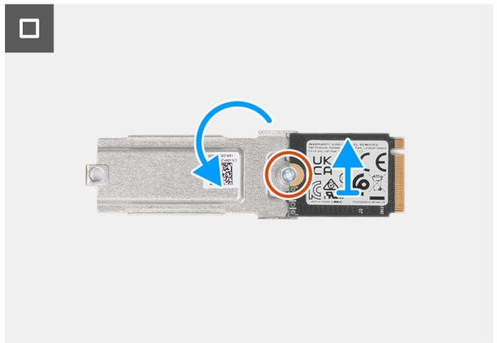
**Ilustración 18. Extracción de la unidad de estado sólido PCIe M.2 2230 (ranura 1)**
