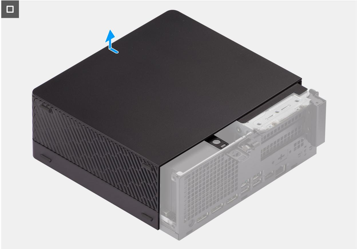
**Ilustración 11. Extracción de la cubierta lateral**
