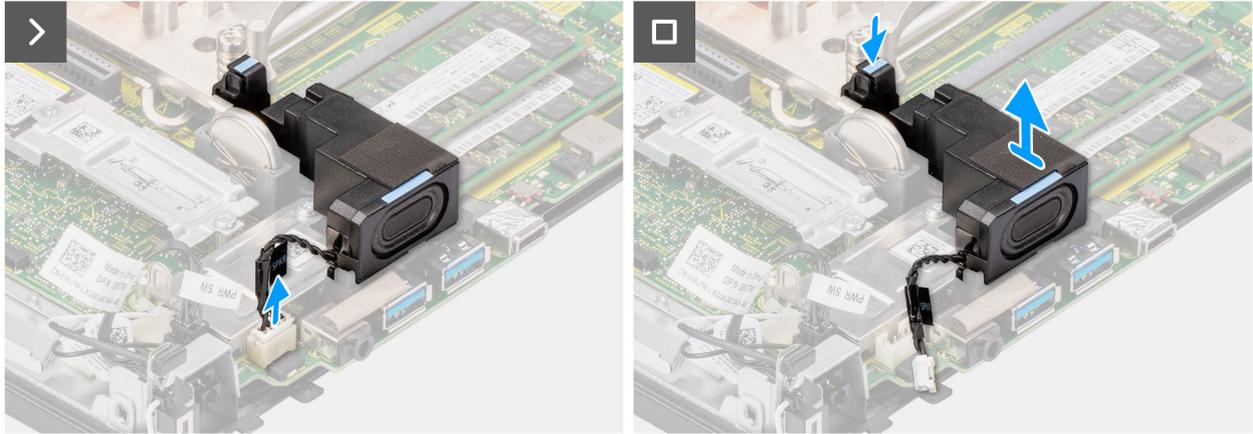
**Ilustración 32. Extracción del parlante**
