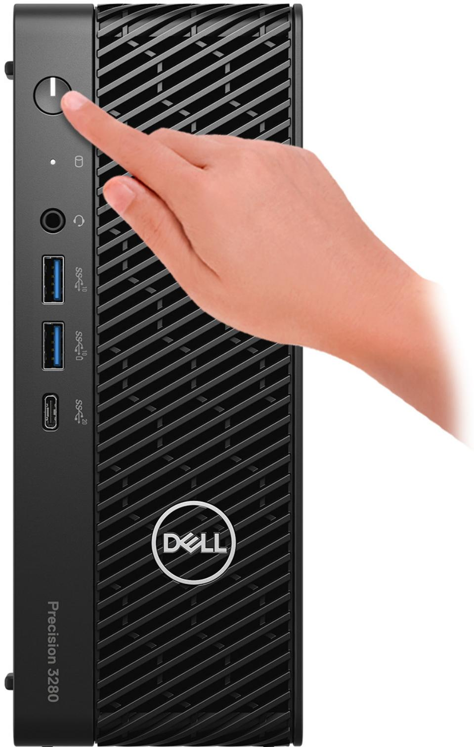
Ilustración 7. Presione el botón de encendido
