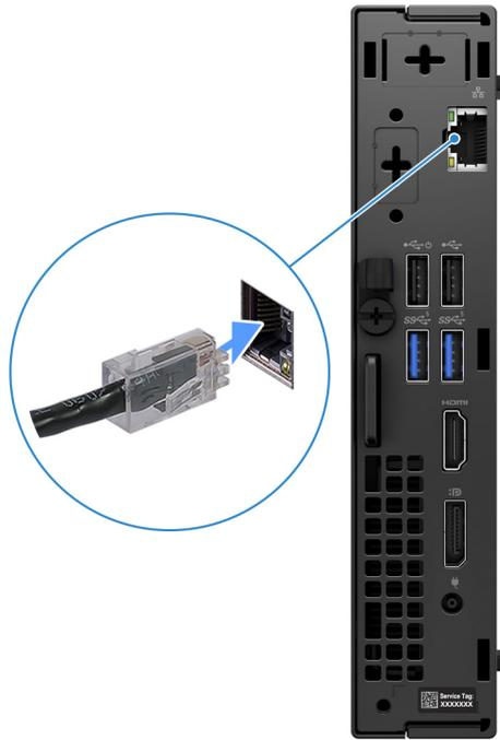
**Ilustración 4. Conéctese a la red mediante un cable**
