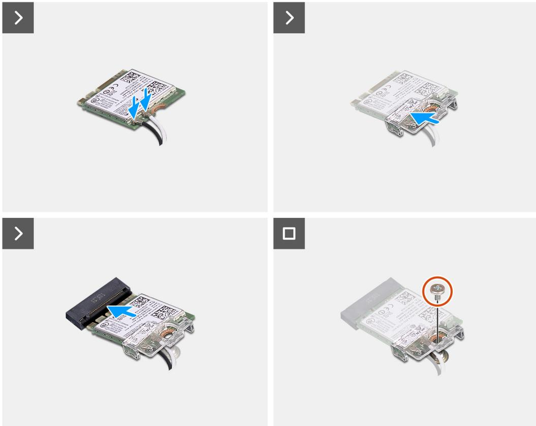
**Ilustración 29. Instalación de la tarjeta inalámbrica**
