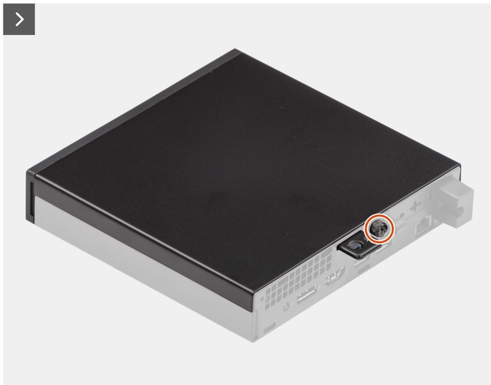
Ilustración 9. Extracción de la cubierta lateral
