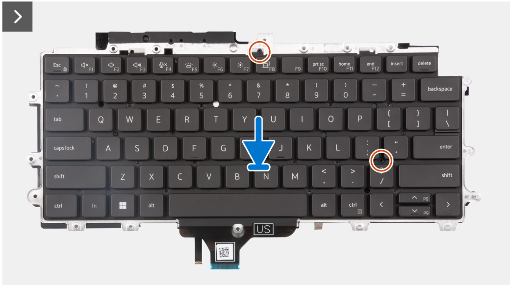
Figure 61. Installation de l'assemblage du clavier
