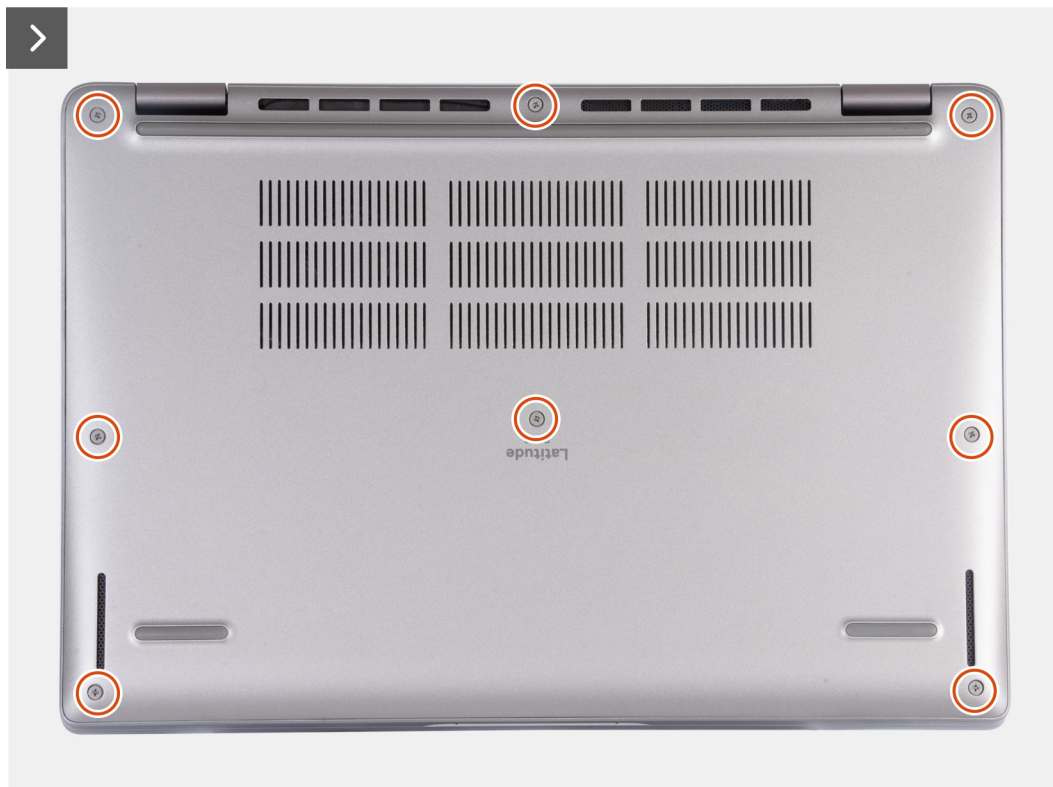
Figure 17. Dévissez les huit vis imperdables qui fixent le cache de fond à l'assemblage du repose-poignets
