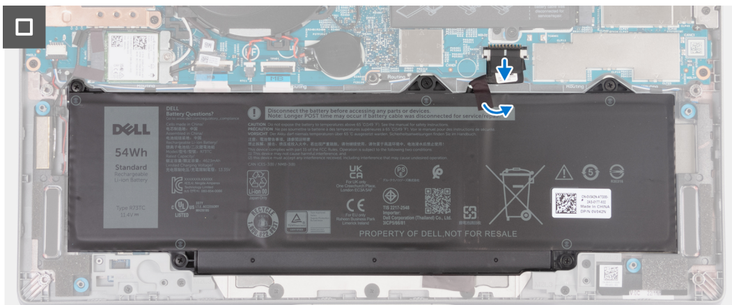
Figure 19. Déconnectez de la carte système le câble de la batterie
