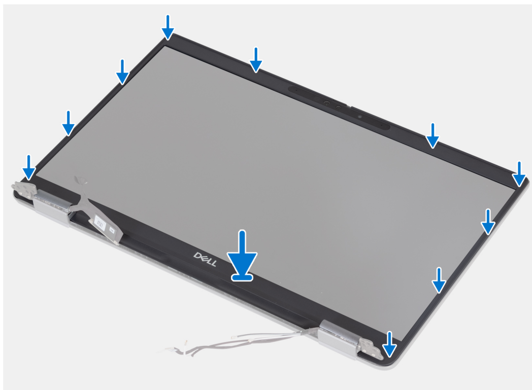
Figure 69. Installation de la bordure d'écran (ordinateur portable)
