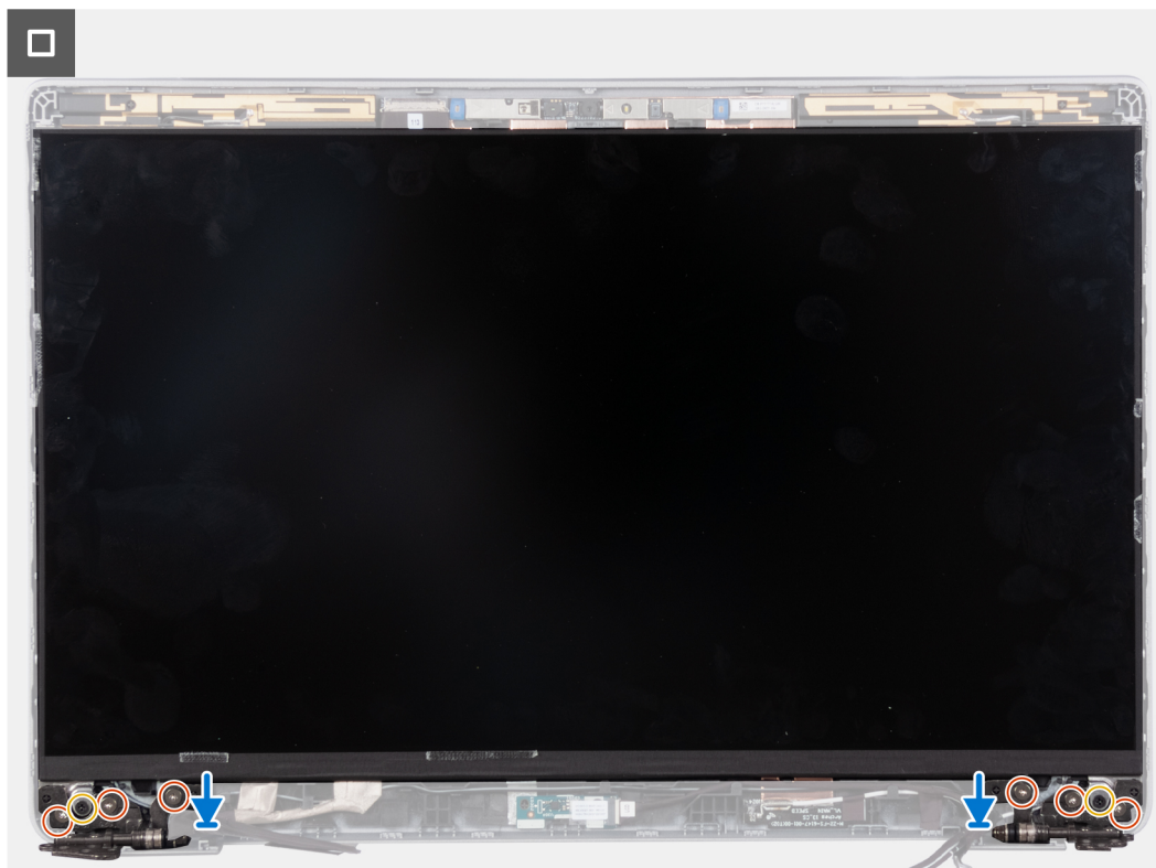
Figure 79. Insertion des languettes du panneau d'écran dans leur logement sur le capot d'écran
