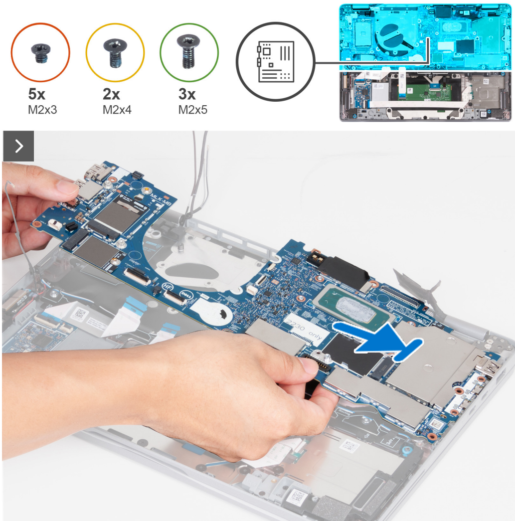
Figure 49. Installation de la carte système
