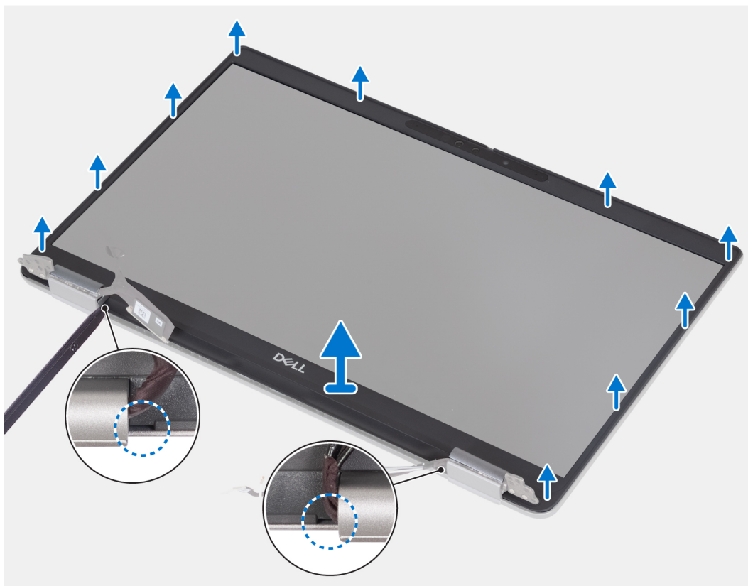
Figure 67. Retrait de la bordure d'écran (ordinateur portable)
