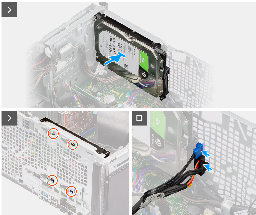
Obrázek 36. Montáž 3,5palcového pevného disku
