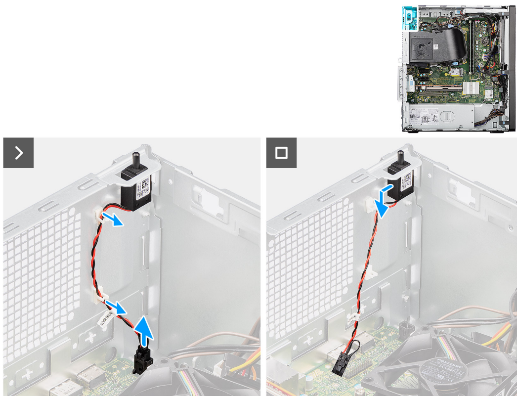
Obrázek 47. Demontáž spínače detekce vniknutí do šasi
