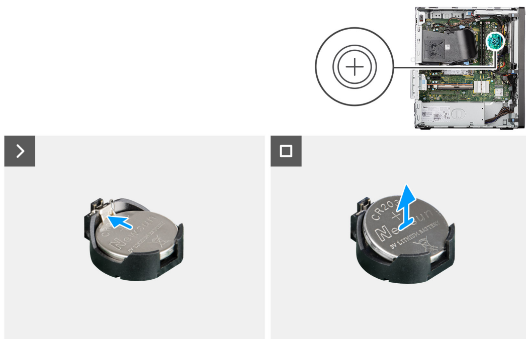
Obrázek 13. Vyjmutí knoflíkové baterie
