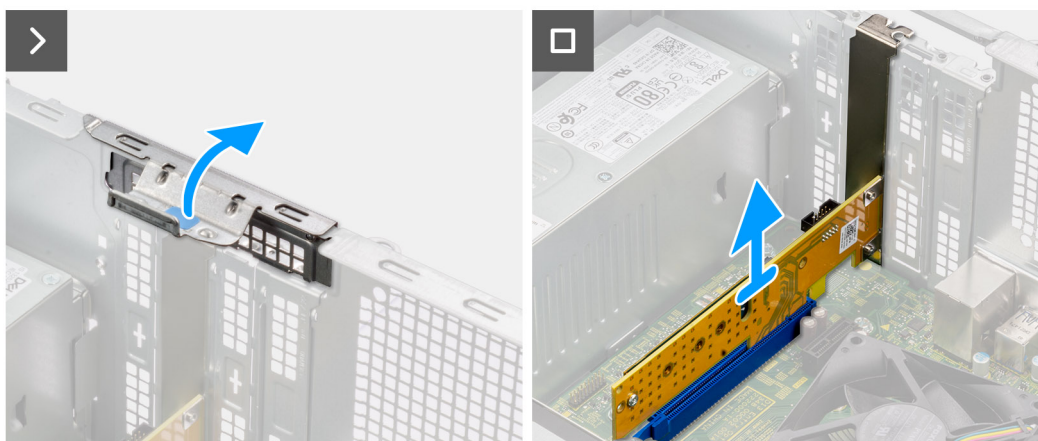
Obrázek 25. Demontáž karty Dell Ultra Speed Drive 3. generace
