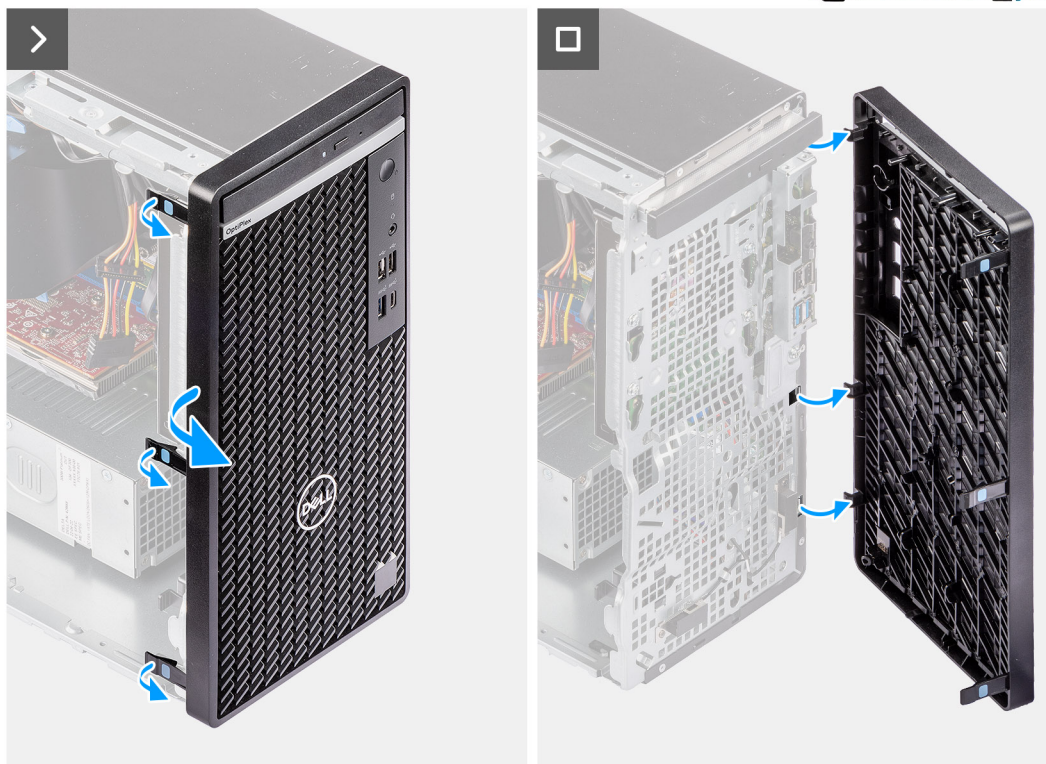
Obrázek 15. Demontáž čelního krytu
