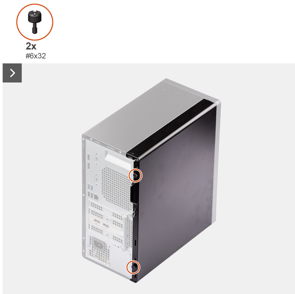
Obrázek 9. Demontáž bočního krytu
