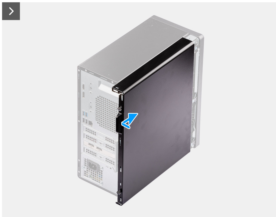
Obrázek 11. Montáž bočního krytu
