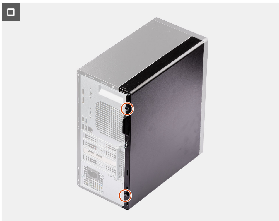
Obrázek 12. Montáž bočního krytu
