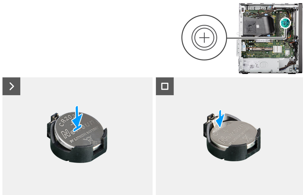
Obrázek 14. Montáž knoflíkové baterie
