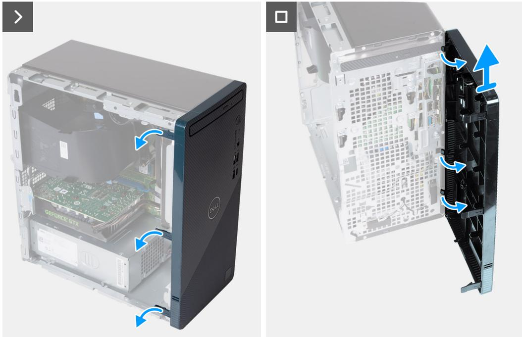
**Ilustración 12. Extracción de la cubierta frontal**
