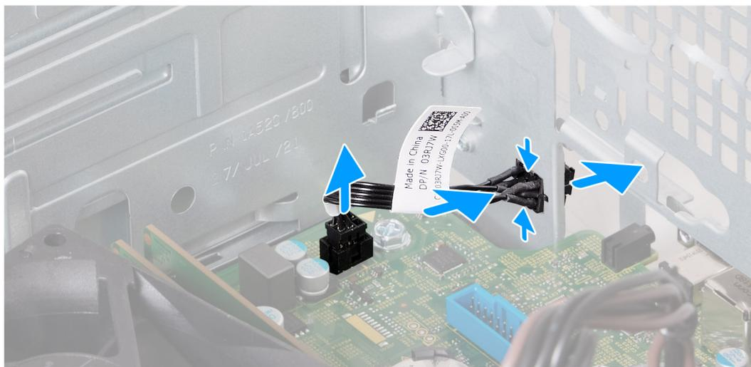
**Ilustración 26. Extracción del botón de encendido**
