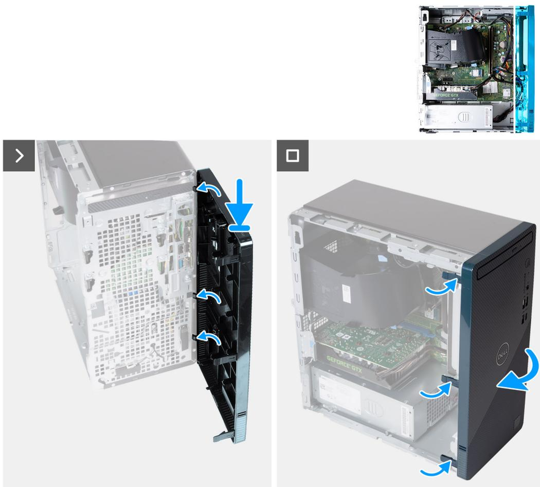
**Ilustración 13. Instalación de la cubierta frontal**
