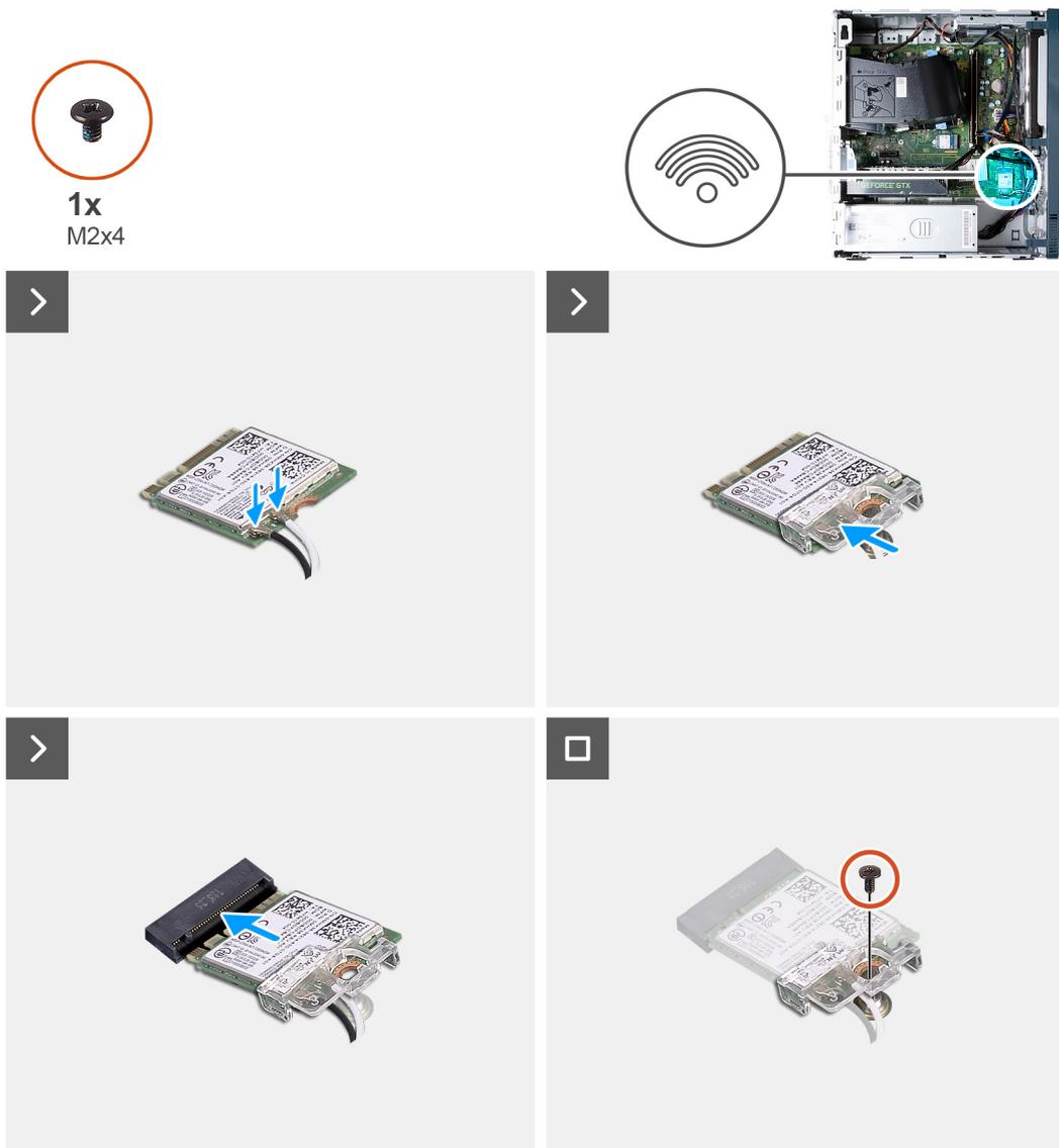
**Ilustración 21. Instalación de la tarjeta inalámbrica**
