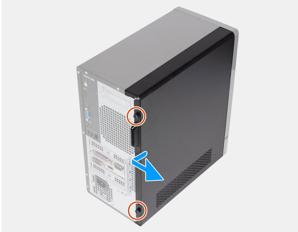
**Ilustración 10. Extracción de la cubierta lateral izquierda**
