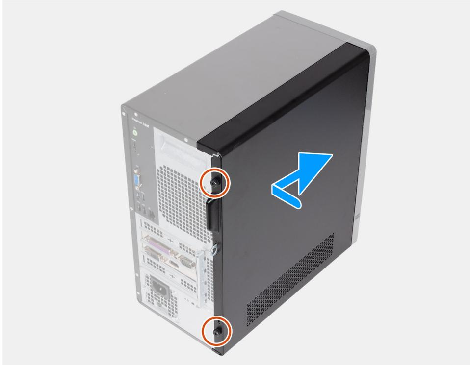
**Ilustración 11. Instalación de la cubierta lateral izquierda**
