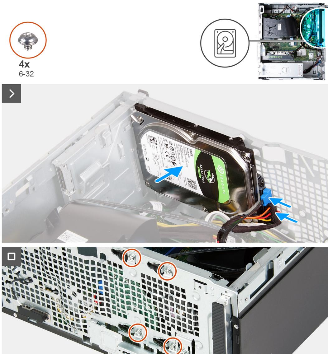
Ilustración 25. Instalación del disco duro
