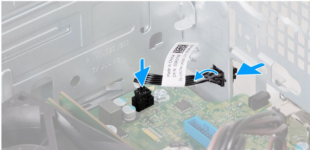
**Ilustración 27. Instalación del botón de encendido**
