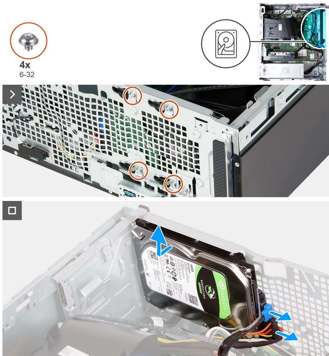
Ilustración 24. Extracción de la unidad de disco duro
