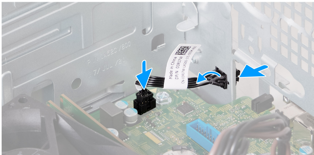
Figura 27. Installazione del pulsante di accensione
