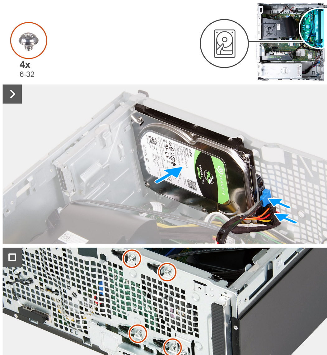
Figura 25. Installazione del disco rigido
