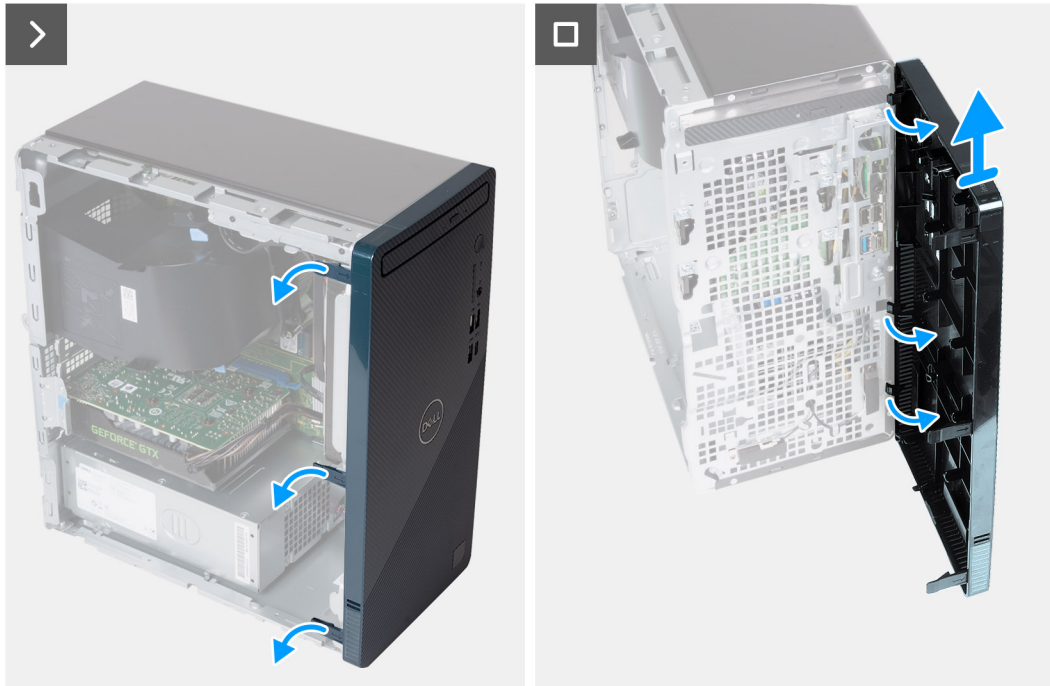
Figura 14. Rimozione del coperchio anteriore
