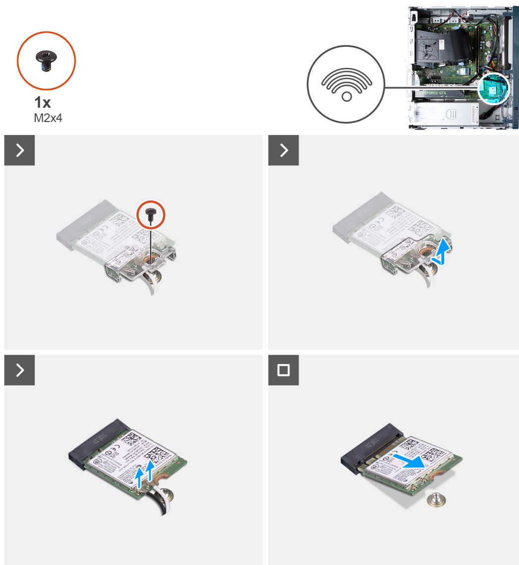
Figura 20. Rimozione della scheda wireless
