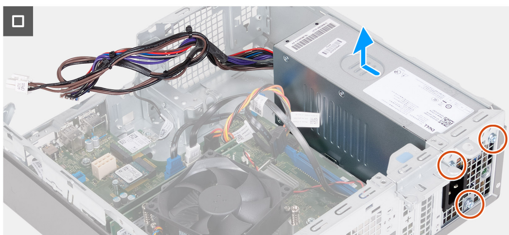
Figura 41. Rimozione dell'unità di alimentazione
