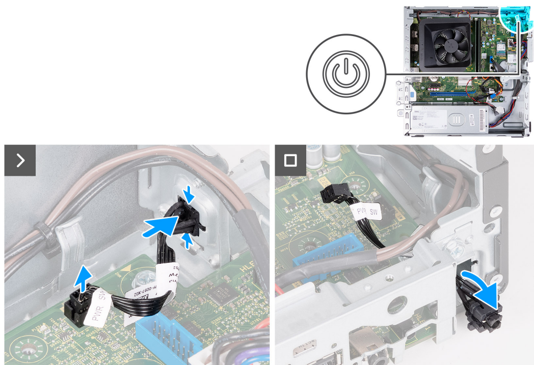
Figura 22. Rimozione del pulsante di accensione
