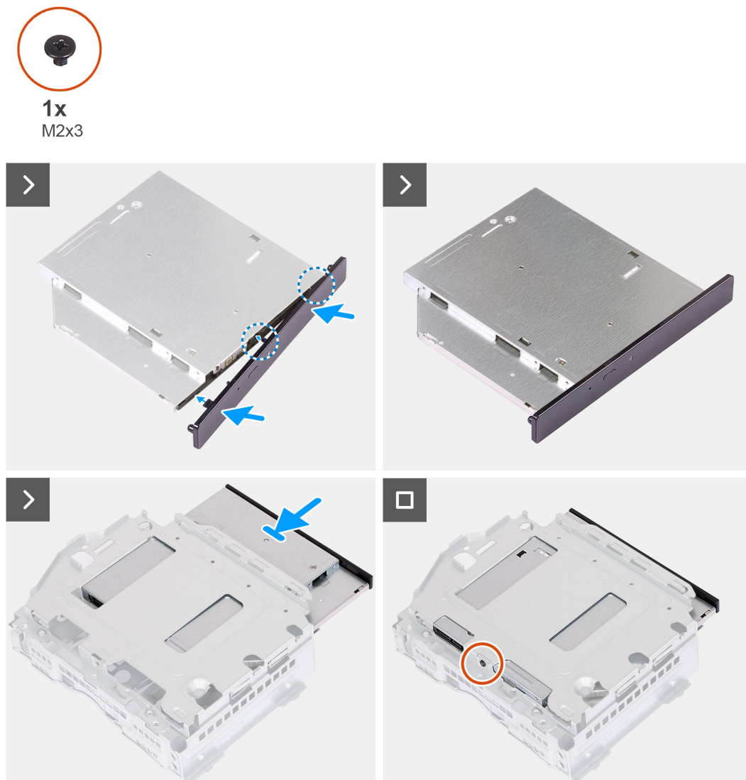
Figura 21. Installazione dell'unità ottica
