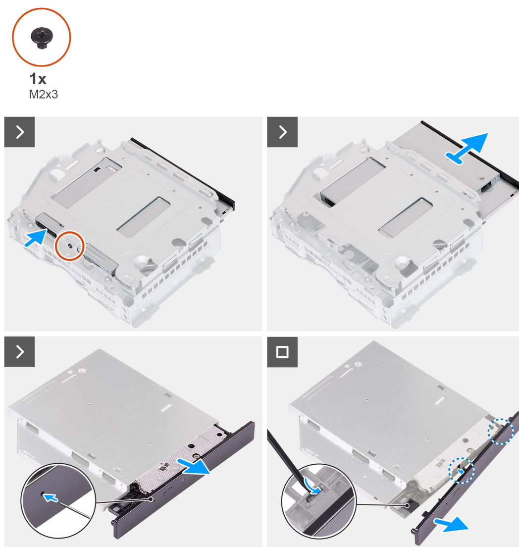
Figura 20. Rimozione dell'unità ottica
