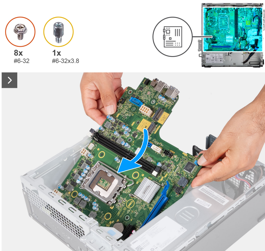
Figura 57. Posizionamento della scheda di sistema nello chassis
