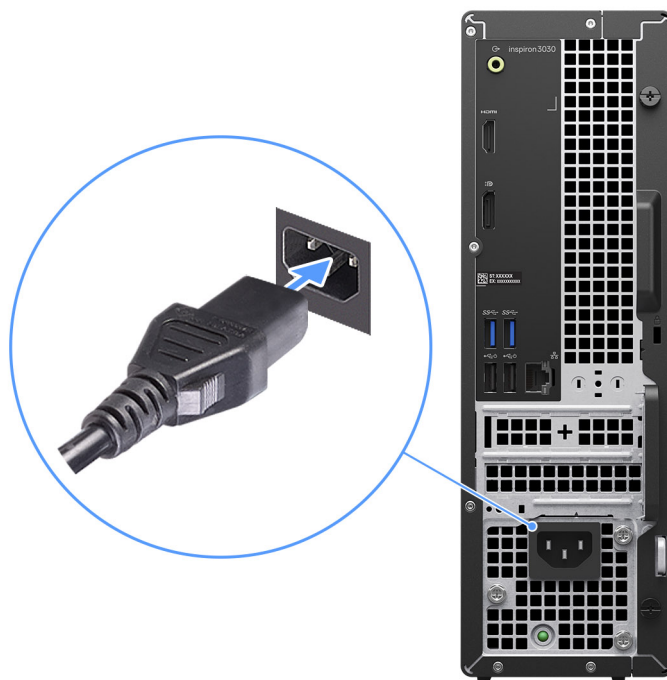
Figura 7. Collegare il cavo di alimentazione
