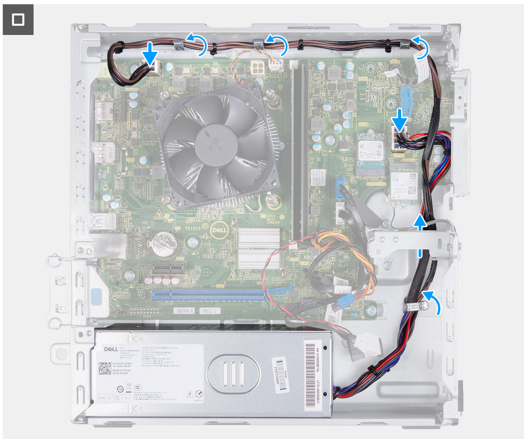
Figura 43. Instradamento dei cavi nelle apposite guide
