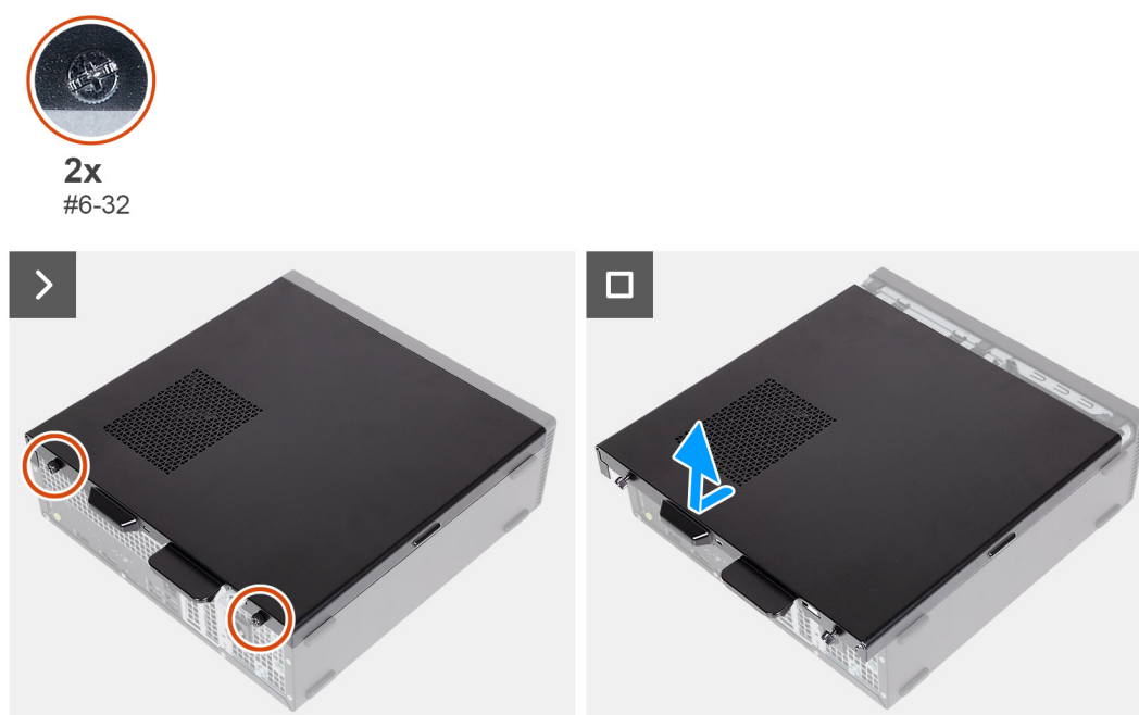
Figura 12. Rimozione del pannello laterale sinistro
