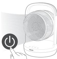
**3** Opäťovným stlačením tlačidla ventilátor vypnete.
