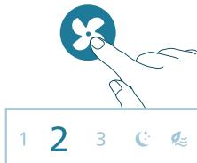
**Ruhemodus (🌙):** Genießen Sie eine kühle und ruhige Nachtruhe mit dem Schlafmodus. In diesem Modus wird die Lüftergeschwindigkeit innerhalb von 30 Minuten allmählich auf die niedrigste Stufe verringert. Das hilft Ihnen, natürlich einzuschlafen, und spart Energie.
