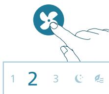
**Način rada za spavanje (🌙):** Spavajte u svježem i mirnom okruženju uz način rada za spavanje. U ovom načinu rada postupno se tijekom 30 minuta smanjuje brzina ventilatora na najnižu postavku, što vam pomaže da prirodno zaspite uz očuvanje energije.
