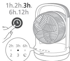
Pritisnite gumb kako biste odabrali 1, 2, 3, 6 ili 12 sati, dok je ventilator uključen ili isključen. Kad mjerač vremena završi, ventilator će prestati ili početi raditi automatski.
