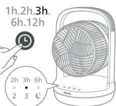
Prima o botão ⏳ repetidamente para escolher entre 1, 2, 3, 6 ou 12 horas com a ventoinha ligada ou desligada. Quando o temporizador terminar, a ventoinha para ou começa a funcionar automaticamente.
