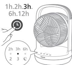
Druk herhaaldelijk op de knop ⏱ om te kiezen tussen 1, 2, 3, 6 of 12 uur, wanneer de ventilator aan of uit staat. Wanneer de timer is verstreken, stopt of start de tafelventilator automatisch met werken.
