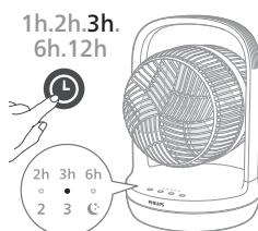
Натиснете бутона многоократно, за да изберете между 1, 2, 3, 6 или 12 часа, когато вентилаторът е включен или изключен. Когато таймерът приключи, вентилаторът ще спре или ще започне да работи автоматично. След като зададеният таймер спре:
