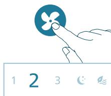
**Slaapmodus (🌙):** Ervaar een koele en vredige nachtrust met de Stille slaapmodus. In deze modus wordt de ventilatorsnelheid in 30 minuten geleidelijk aan verlaagd naar de laagste stand, zodat u natuurlijk in slaap valt. In deze modus wordt ook energie bespaard.
