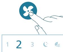
**Režim spánku (🌙):** V tichém režimu spánku si můžete dopřát klidný a ničím nerušený spánek. Tento režim v průběhu 30 minut postupně sniže rychlosť ventilátoru na nejnižší hodnotu, což vám pomůže usnout přirozeným způsobem a zároveň ušetřit energii.
