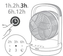
Nyomja meg többször a(z) ⏱ gombot az 1, 2, 3, 6 vagy 12 óra közötti választáshoz, amikor a ventilátor be van kapcsolva. Amint az idő lejár, a ventilátor vagy leáll, vagy automatikusan kezd működni.
