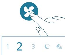
**Tryb snu (🌙):** umożliwia oddychanie chłodnym powietrzem podczas niezmoczonego snu. Ten tryb stopniowo zmniejsza prędkość wentylatora do najniższego ustawienia w ciągu 30 minut, pomagając w naturalny sposób zasnąć i jednocześnie oszczędzać energię.
