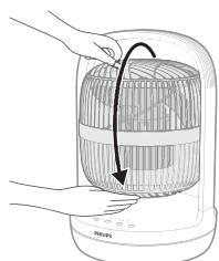
A ventilátorlapátot kezdetben felfelé fordítva kell elhelyezni. Az első használat előtt állítsa be a ventilátort a megfelelő szögbe, például előrefelé.
