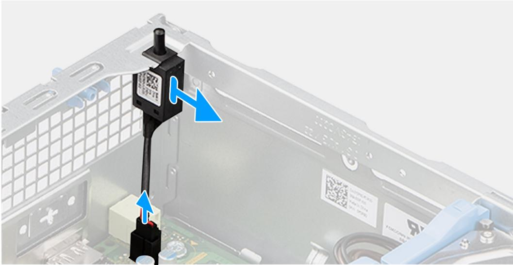
**Figura33. Retirar o switch de intrusão**
