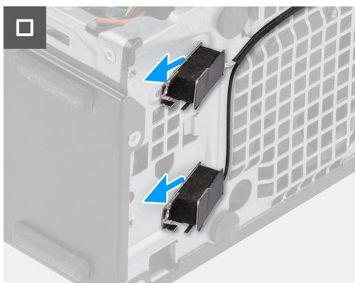
Figura37. Retirar o módulo da antena interna
