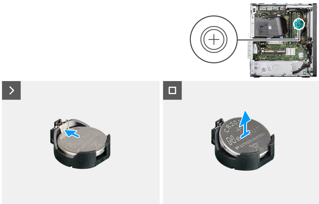
Figura13. Retirar a bateria de célula tipo moeda
