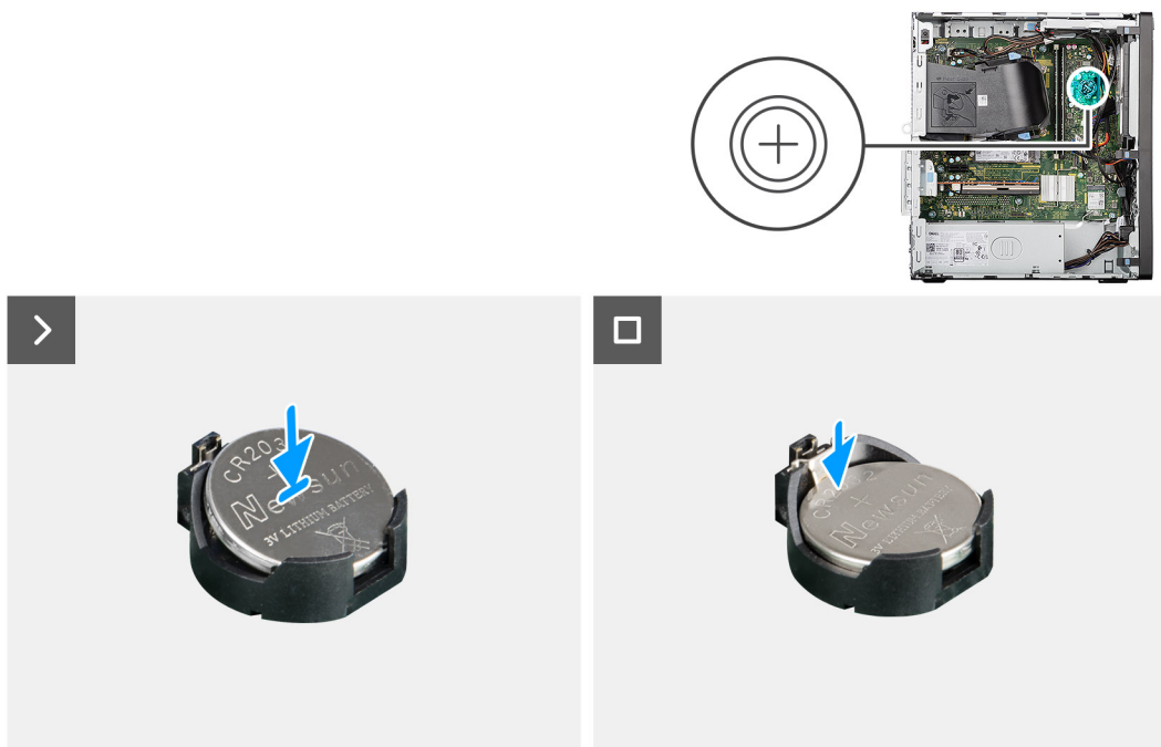
Figura14. Instalar a bateria de célula tipo moeda
