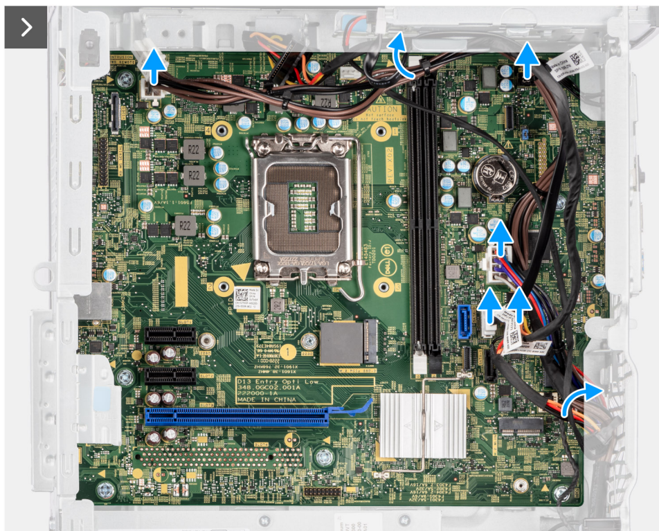
Figura84. Retirar a placa de sistema
