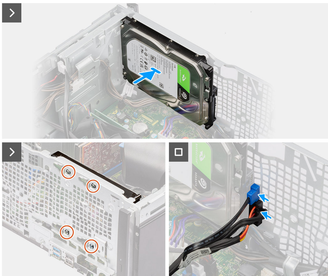
Figura36. Instalar o disco rígido de 3,5 polegadas
