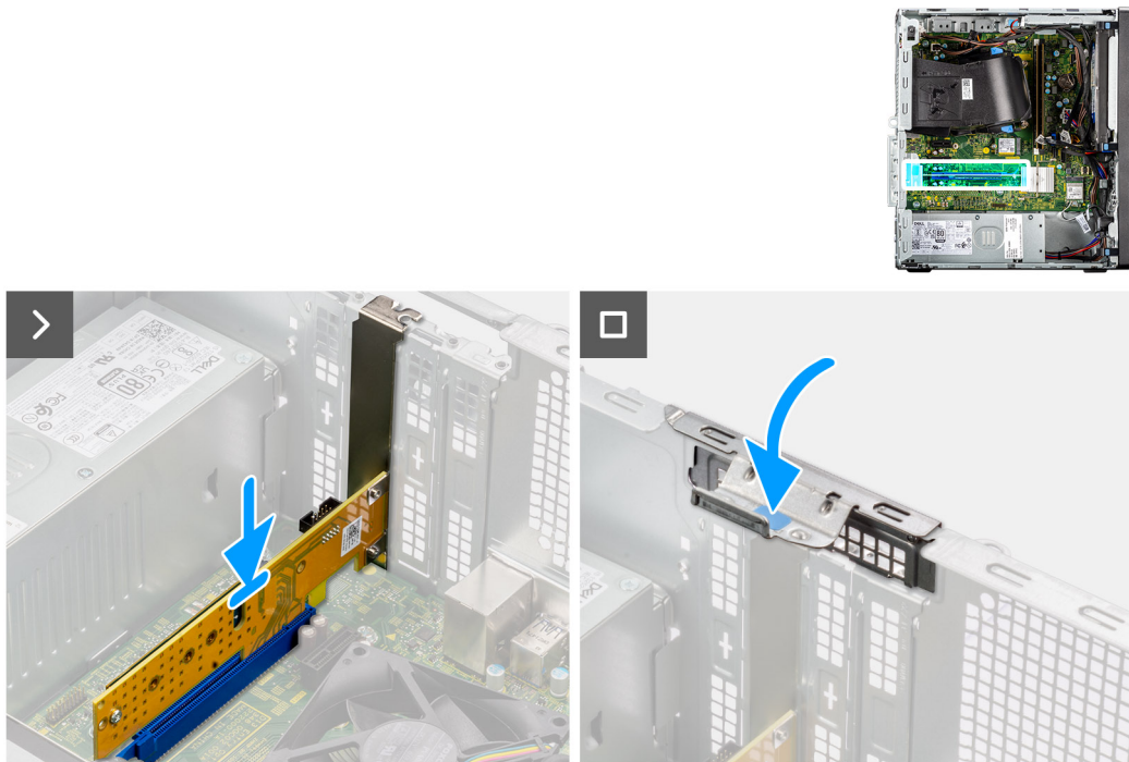
Figura30. Instalar a placa do Disco Dell Ultra Speed de 3.ª Geração
