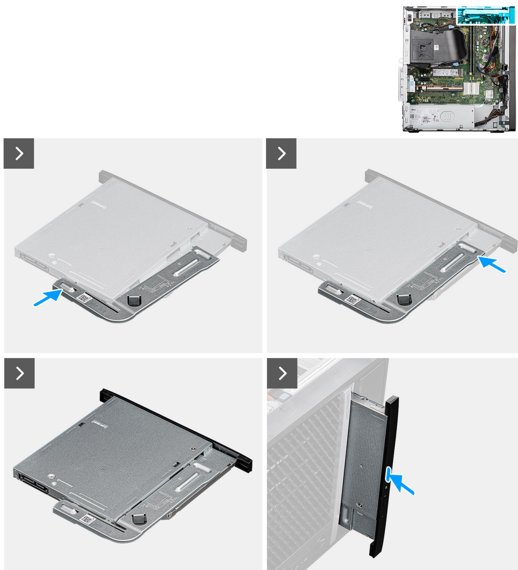
Figura39. Instalar o disco ótico fino
