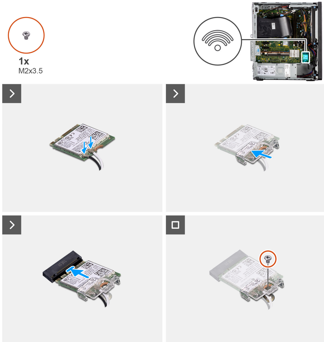
Figura32. Instalar a placa de comunicação sem fios
