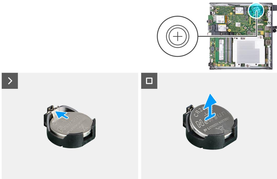
Figura13. Retirar a bateria de célula tipo moeda
