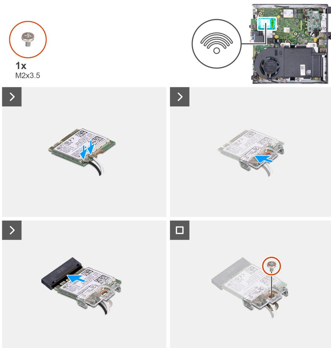
**Figura29. Instalar a placa de comunicação sem fios**
