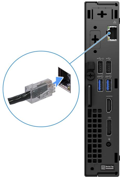
**Figura4. Ligue-se à sua rede utilizando um cabo**
