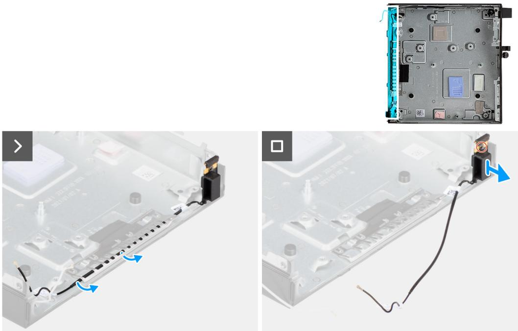
**Figura52. Retirar o módulo da antena (cabo preto)**
