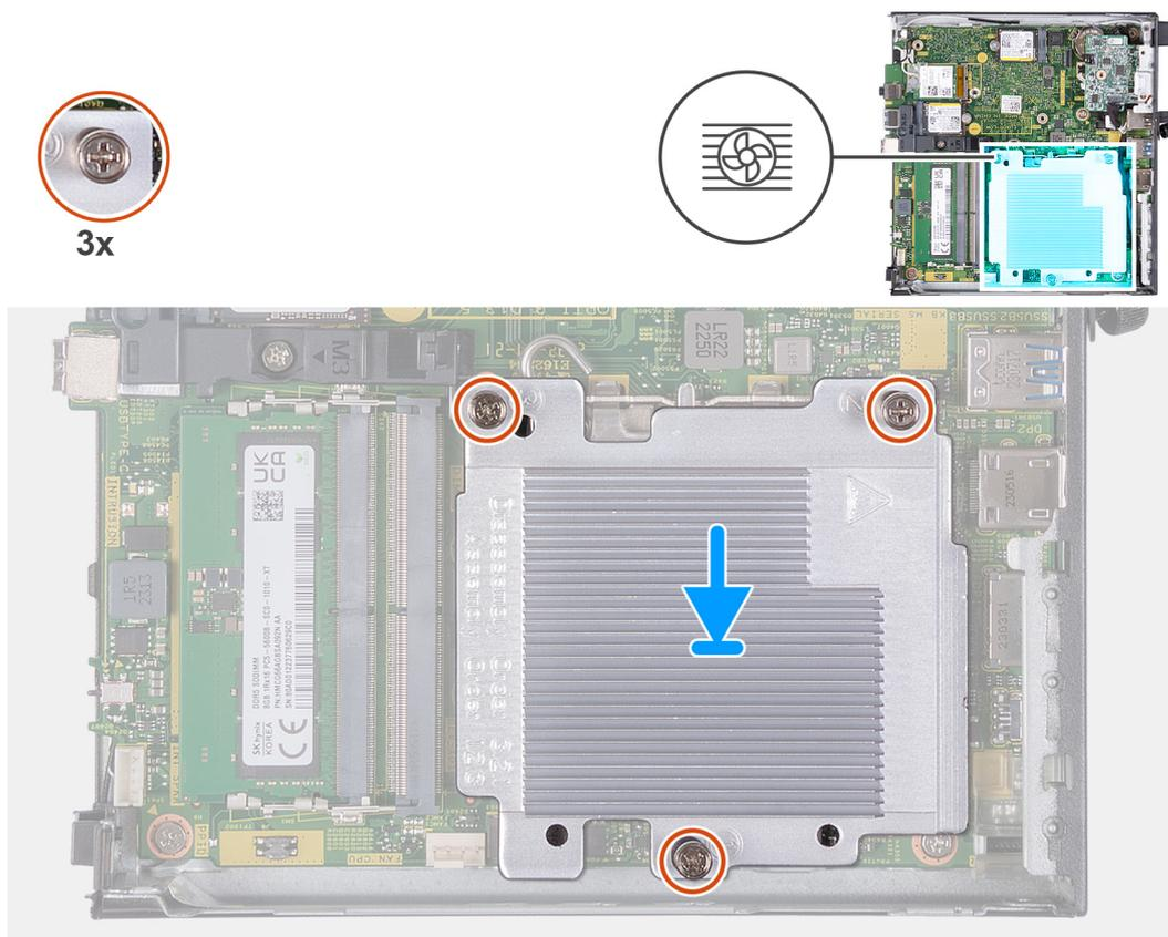
**Figura41. Instalar o dissipador de calor**
