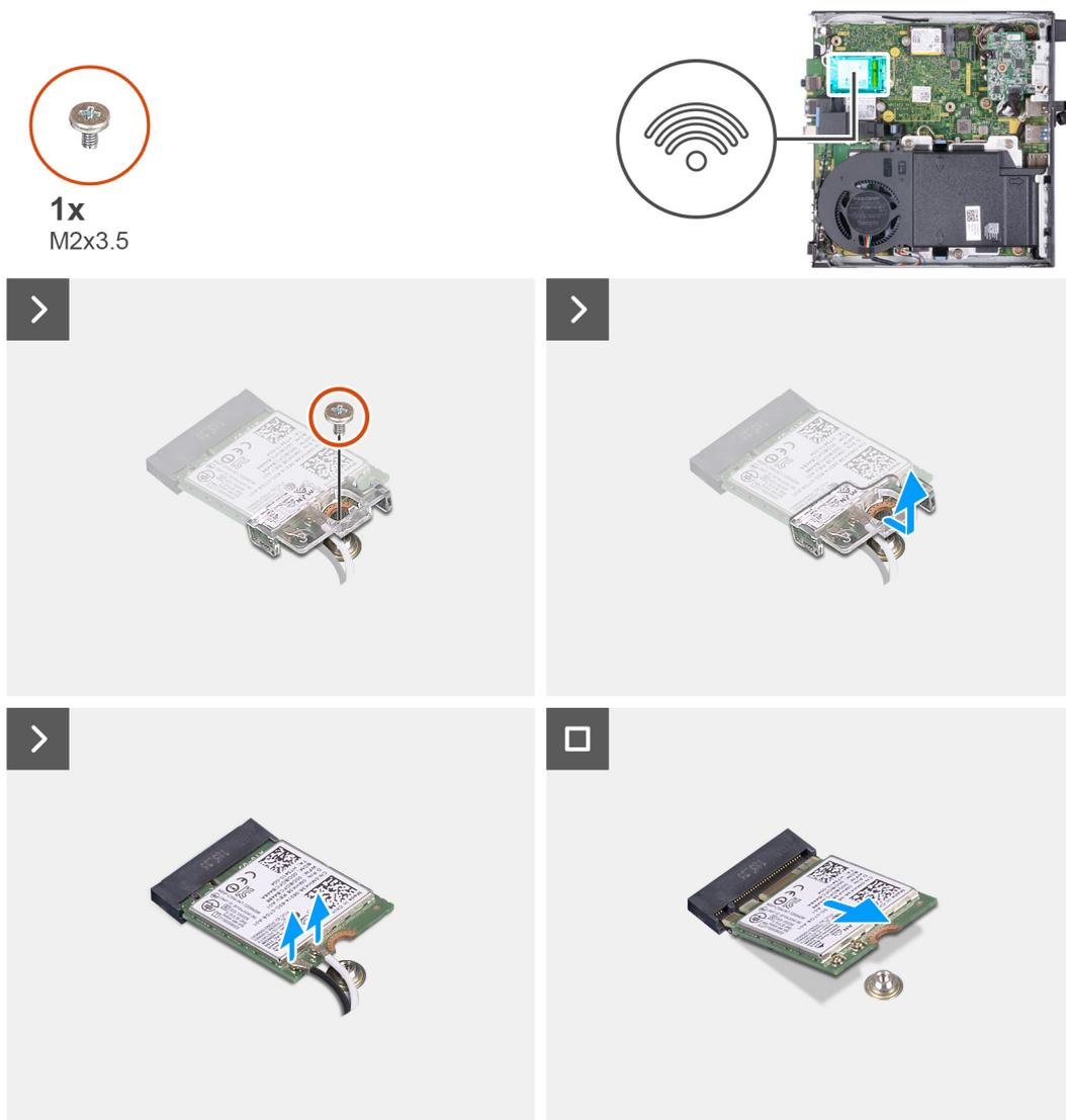
**Figura28. Retirar a placa de comunicação sem fios**
