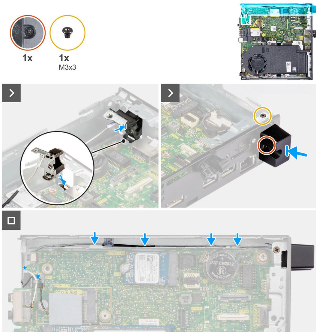
**Figura51. Instalar o módulo da antena (cabo branco)**
