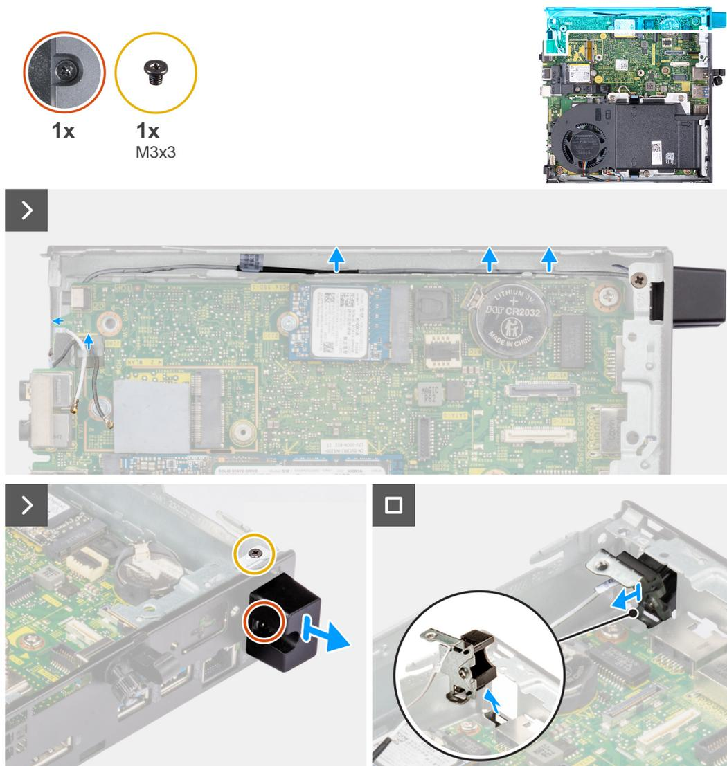
**Figura50. Retirar o módulo da antena (cabo branco)**
