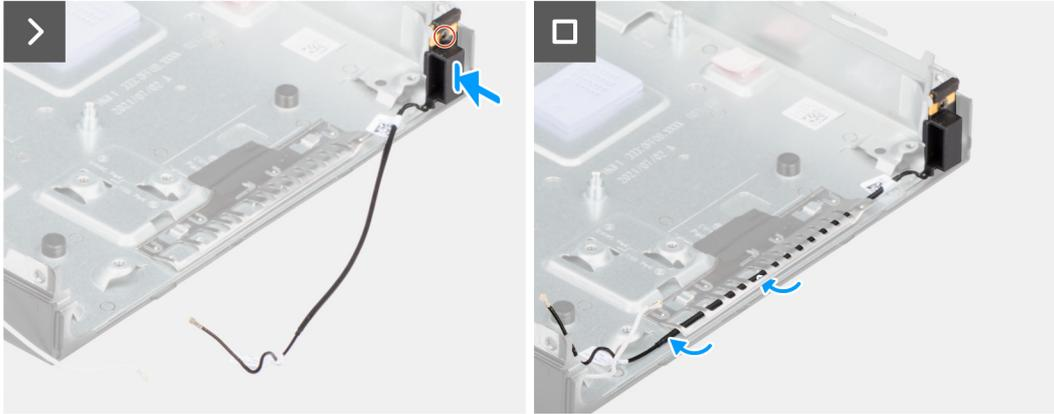
Figura53. Instalar o módulo da antena (cabo preto)
