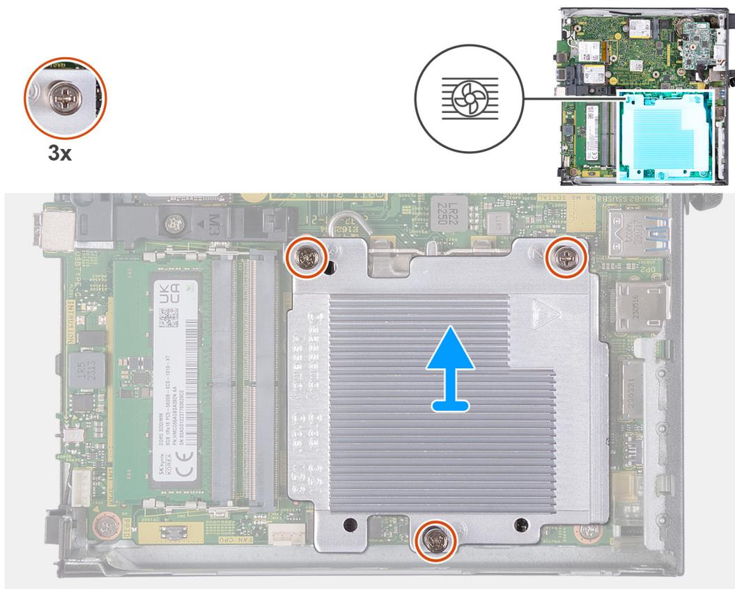
**Figura40. Retirar o dissipador de calor**
