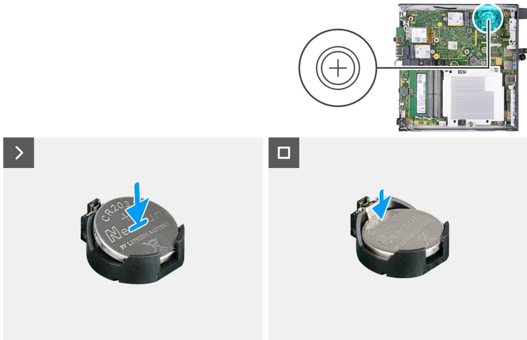
**Figura14. Instalar a bateria de célula tipo moeda**
