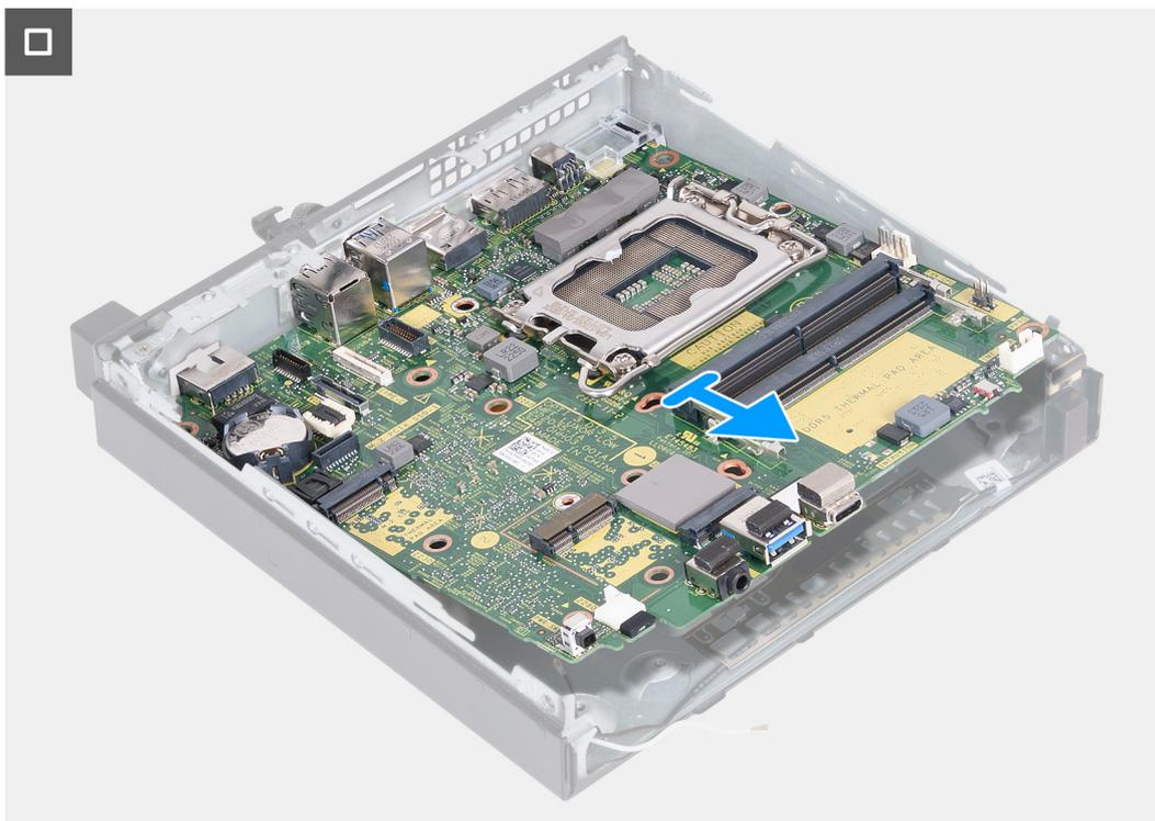
**Figura 46. Retirar a placa de sistema**
