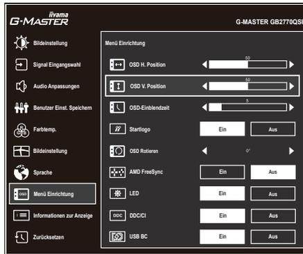
Drücken Sie die Taste MENU und schließlich die Taste INPUT, um die Bildschirmanzeigeefunktion zu schließen. Alle Änderungen werden im Speicher gespeichert.
