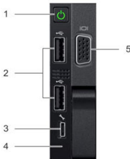
**Ilustración 166. LED del botón de encendido del panel de control derecho frontal**
