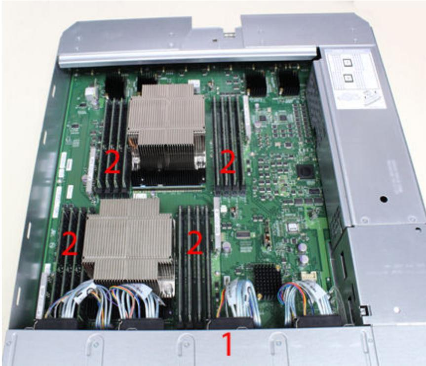
**Ilustración 100. Vista superior del módulo del SP con la cubierta del SP quitada**
