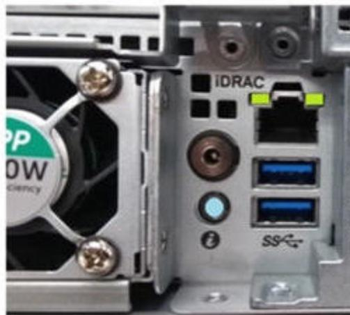
**Ilustración 169. LED de iDRAC e ID integrados**
