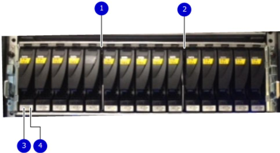
**Ilustración 177. LED del panel frontal**
