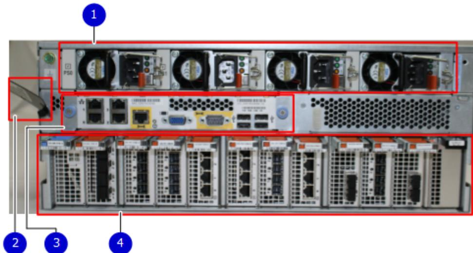
Ilustración 152. Funciones en la parte posterior del chasis
