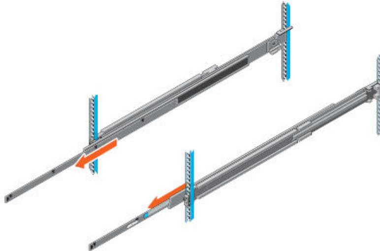
**Ilustración 17. Deslice los rieles internos hacia fuera del gabinete**
