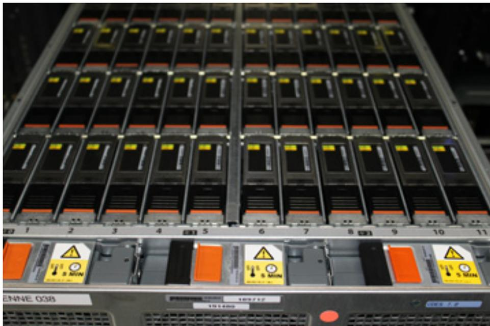
**Ilustración 173. Ventiladores y unidades de disco dentro del gabinete del disco**
