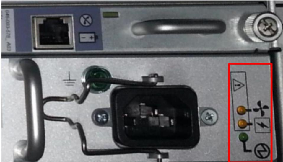
**Ilustración 183. LED de la fuente de alimentación A**
