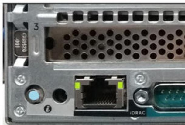
**Ilustración 91. LED de iDRAC e ID integrados**
