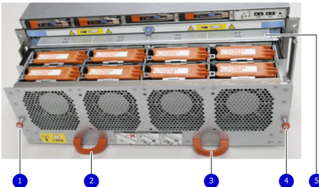
**Ilustración 162. Bandeja de ventiladores abierta**
