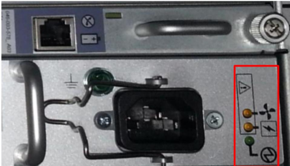
**Ilustración 179. LED de la fuente de alimentación A**
