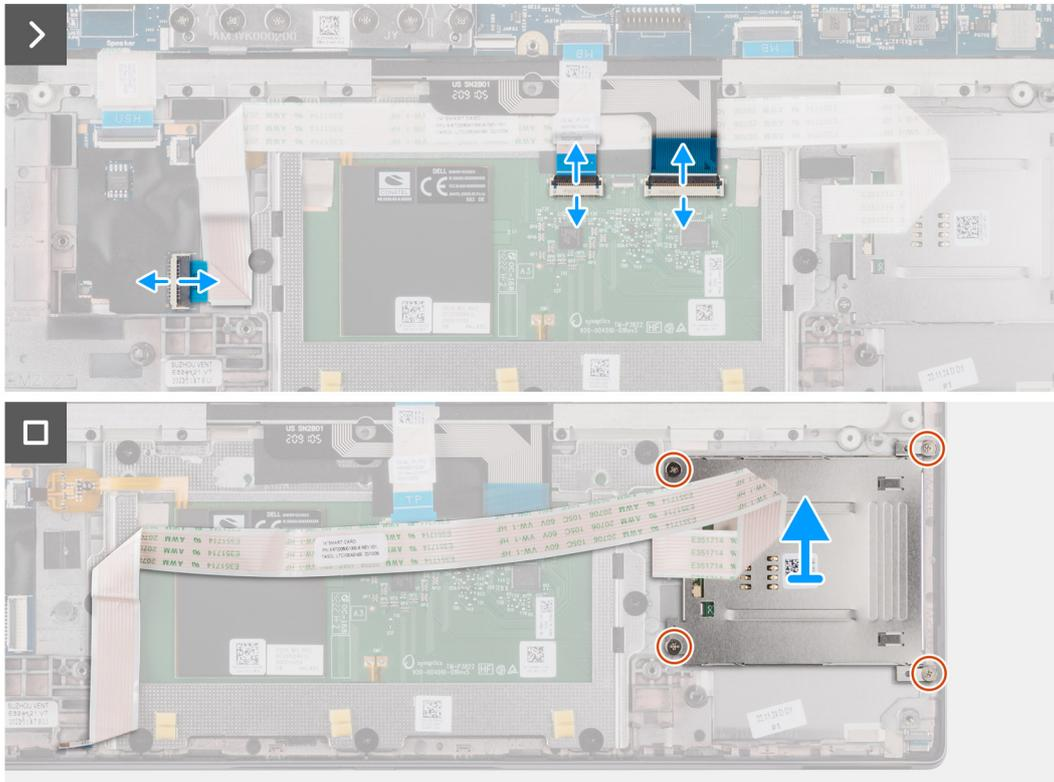
**Ilustración 56. Extracción del lector de tarjetas inteligentes**
