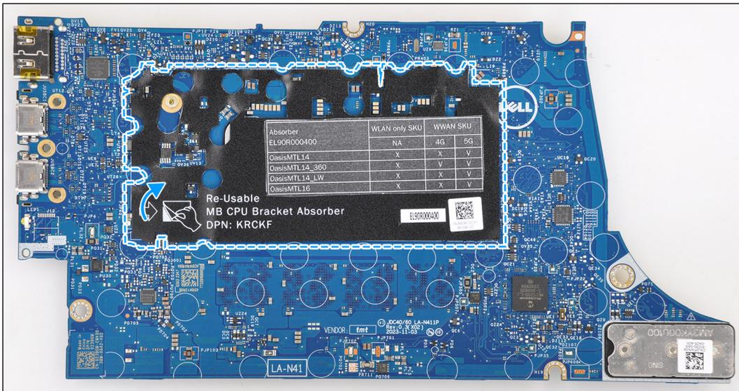
Ilustración 62. Absorbente del soporte de la CPU
