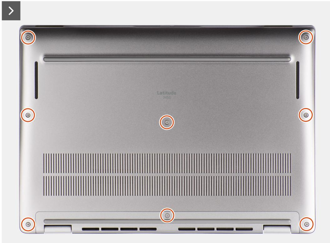
**Ilustración 16. Extracción de la cubierta de la base**
