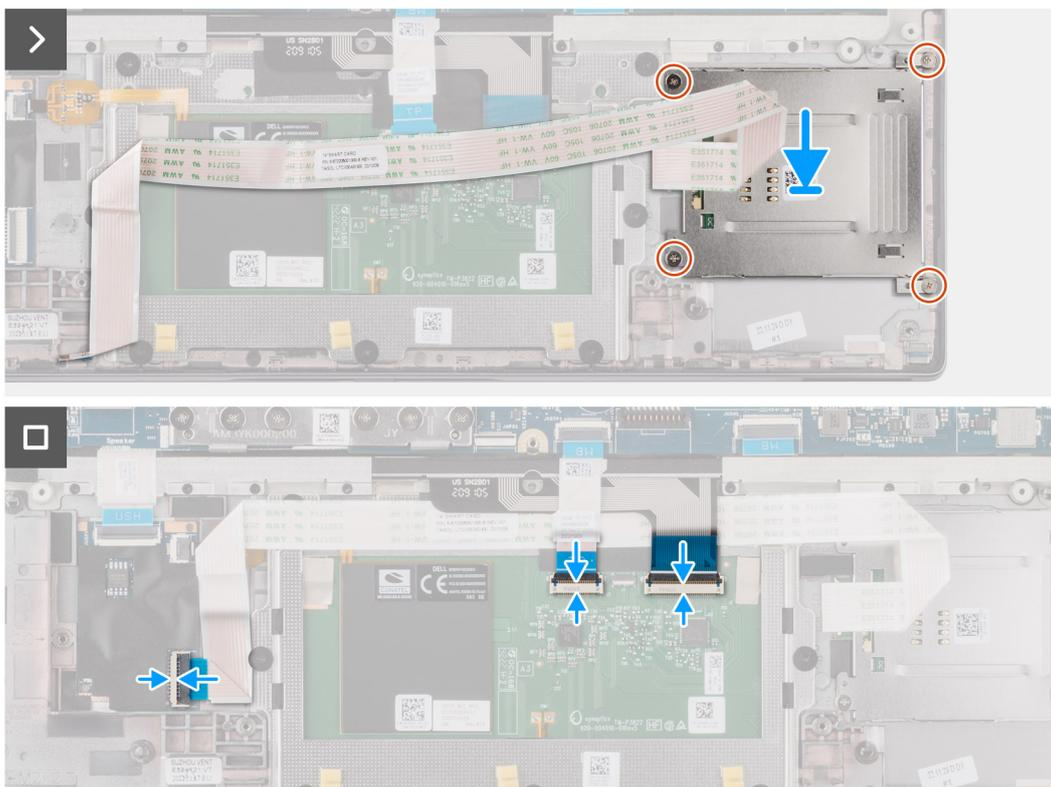
**Ilustración 57. Instalación del lector de tarjetas inteligentes**
