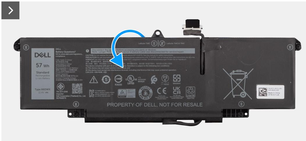
**Ilustración 45. Instalación del cable de la batería**
