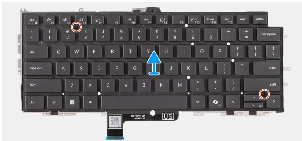
Ilustración 79. Extracción del teclado
