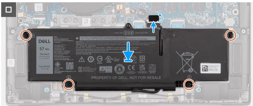
Ilustración 43. Instalación de la batería de 3 celdas
