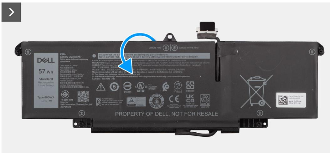
Ilustración 42. Instalación de la batería de 3 celdas
