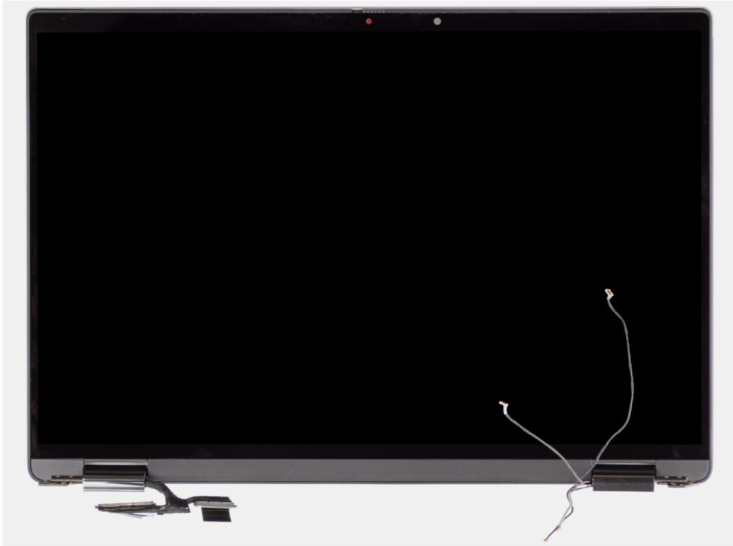
**Ilustración 51. Ensamblaje de la pantalla con cables de la antena WWAN**
