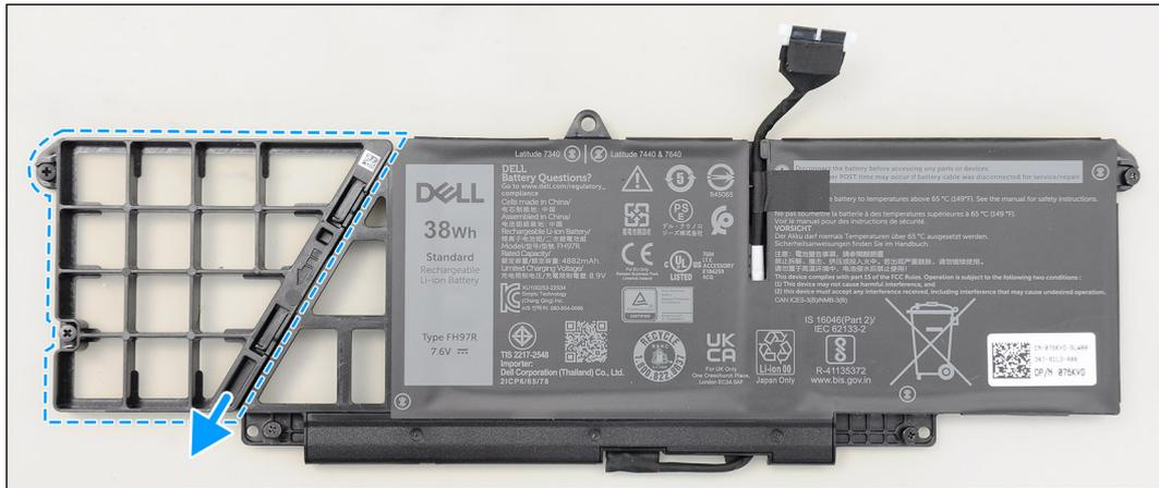
**Ilustración 38. Extracción de la batería de 2 celdas**
