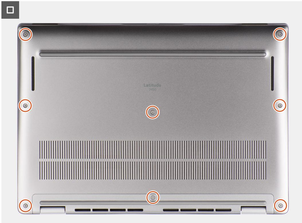
**Ilustración 21. Instalación de la cubierta de la base**
