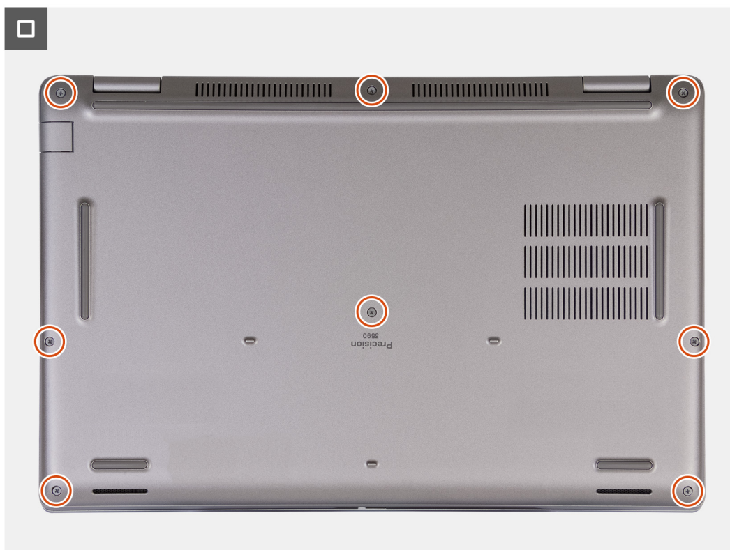
Figura 18. Serrare le viti di fissaggio
