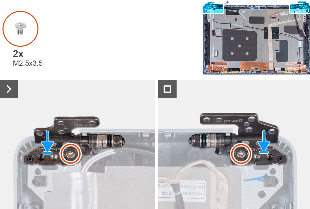
Figura 87. Installazione delle cerniere del display
