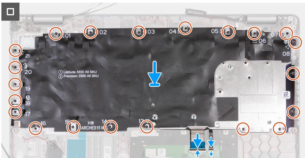
Figura 68. Installazione della tastiera
