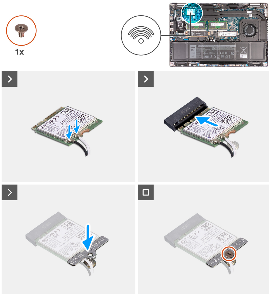
Figura 20. Installazione della scheda wireless
