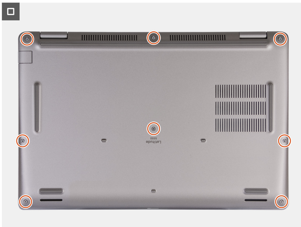
Figura 18. Serrare le viti di fissaggio
