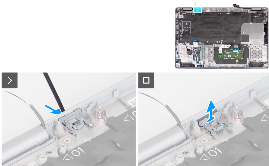
Figura 98. Rimozione del riempimento dello slot per schede SIM fittizie
