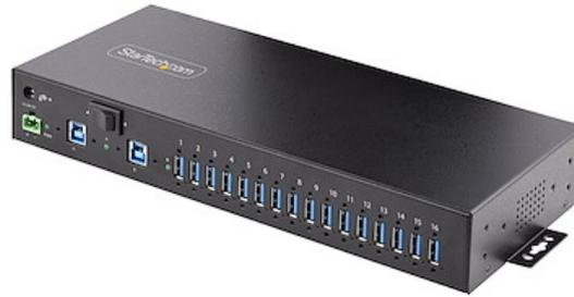
Le Concentrateur USB Industriel 16 Ports 5 Gbit/s avec Adaptateur Secteur dispose de 16 ports USB-A en aval. Sa construction robuste tout en métal convient à une utilisation dans des applications industrielles montées en rack. La protection contre les décharges électrostatiques (ESD) de niveau 4 protège contre les décharges d'air de 15 kV / les contacts de 8 kV. Le concentrateur dispose d'un commutateur hôte à 2 ports, permettant aux utilisateurs de basculer entre deux périphériques hôtes.
