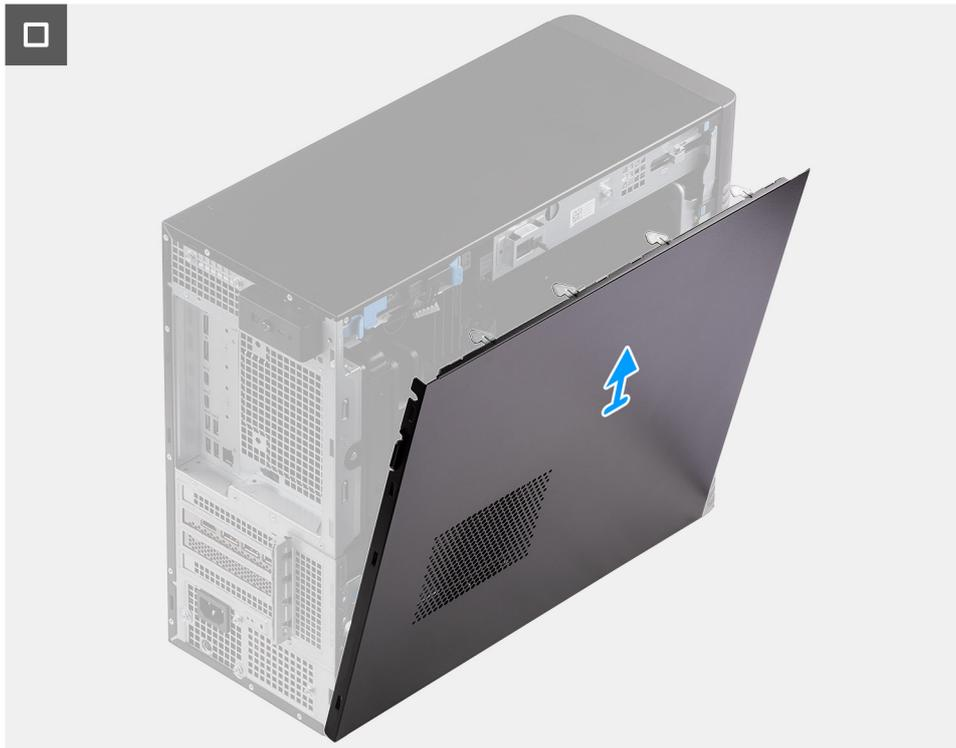
**Abbildung 9. Entfernen der Seitenabdeckung**
