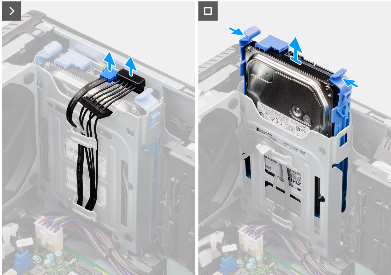
Figure 17. Retrait de l'assemblage de disque dur de 3,5 pouces (baie 2)
