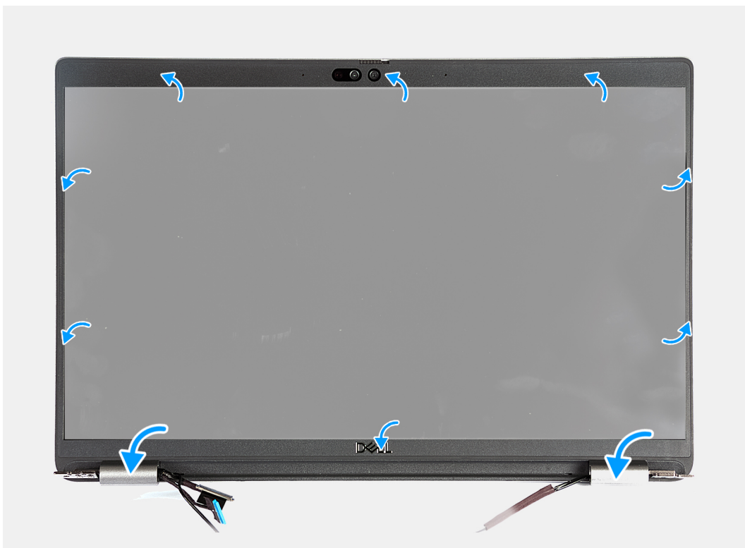
Figura 54. Installazione della cornice del display
