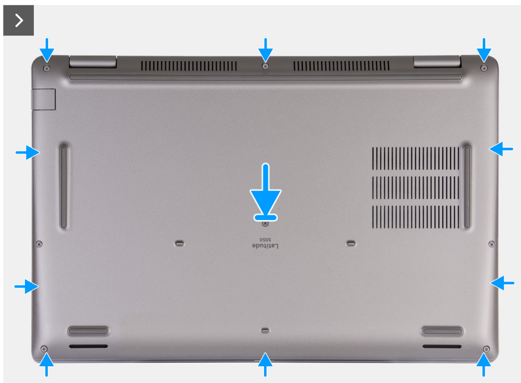
Ilustración 17. Instalación de la cubierta de la base
