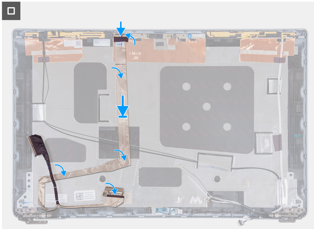
Ilustración 91. Instalación del cable de pantalla
