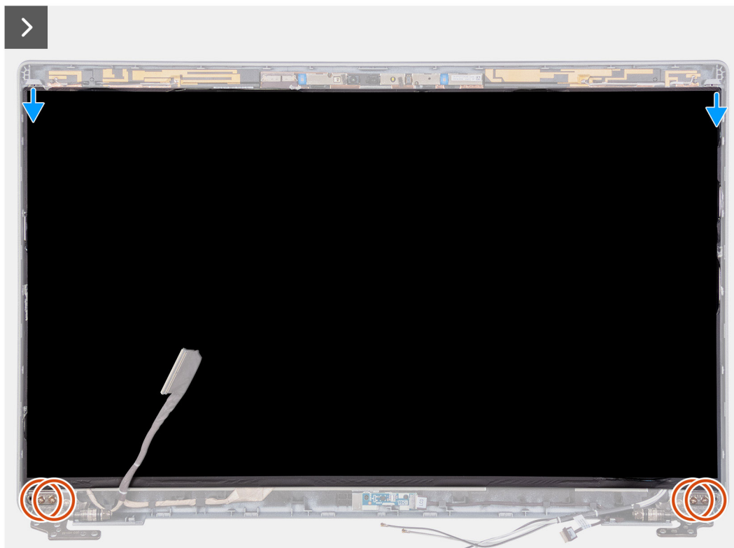
Ilustración 76. Extracción del panel de pantalla
