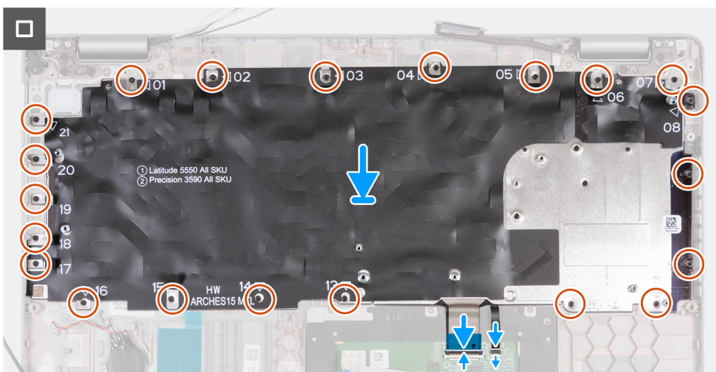
Ilustración 68. Instalación del teclado
