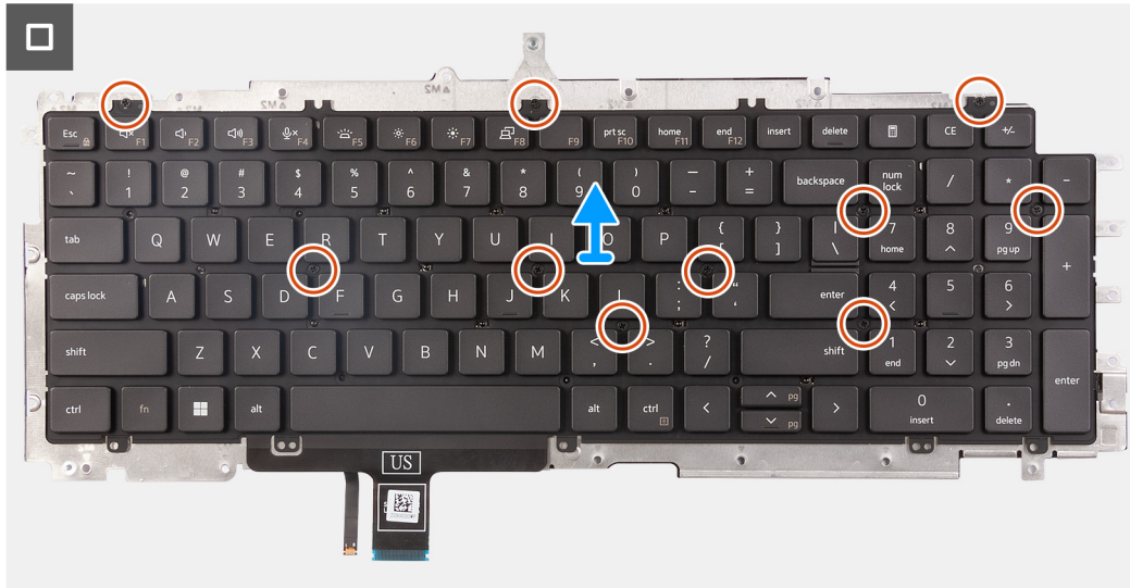
Ilustración 66. Extracción del teclado
