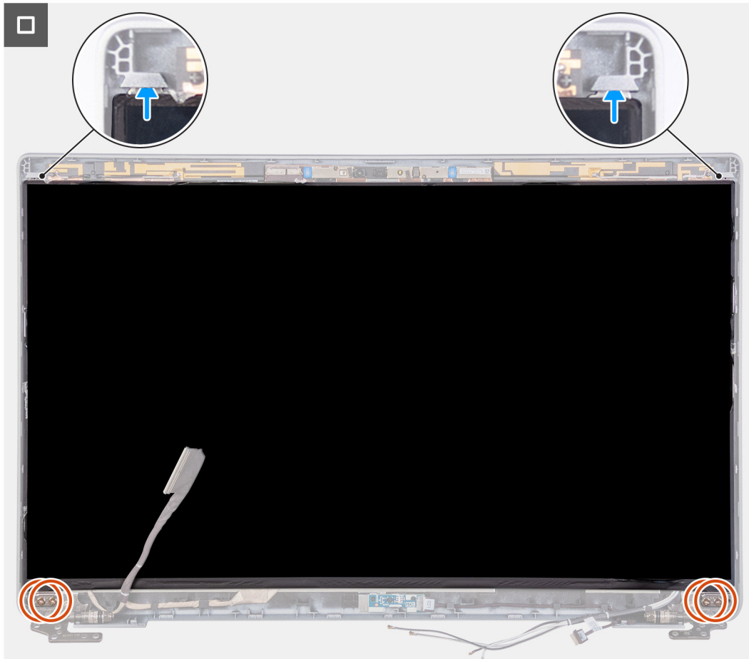
Ilustración 83. Instalación del panel de pantalla
