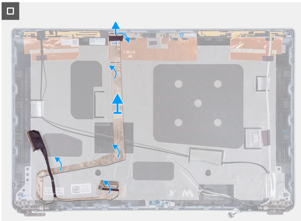
Ilustración 90. Extracción del cable de pantalla
