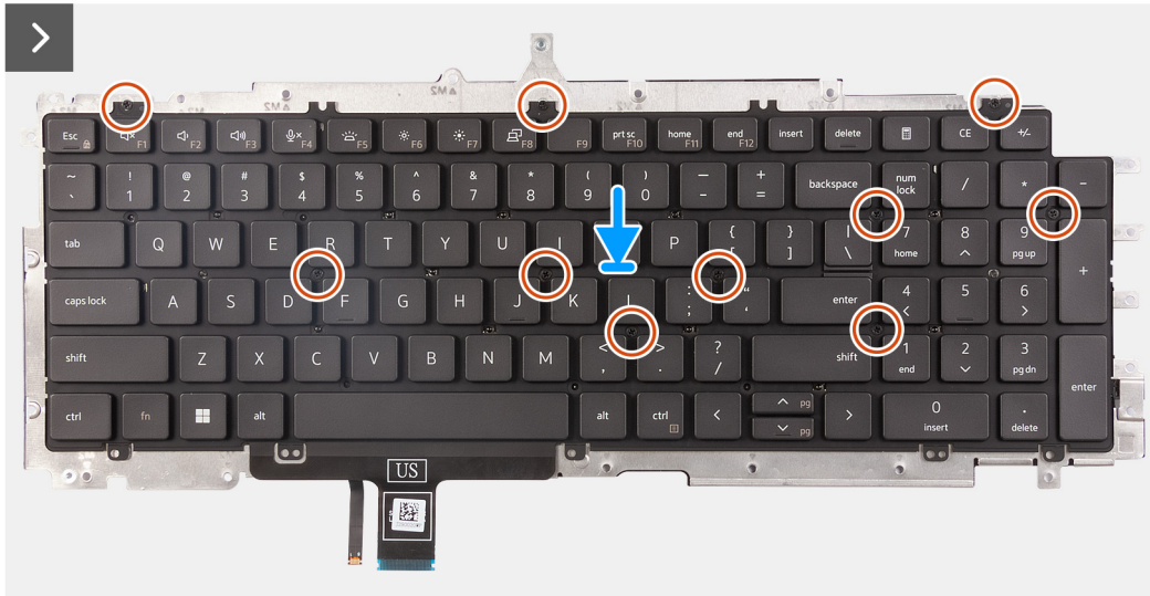
Ilustración 67. Instalación del teclado
