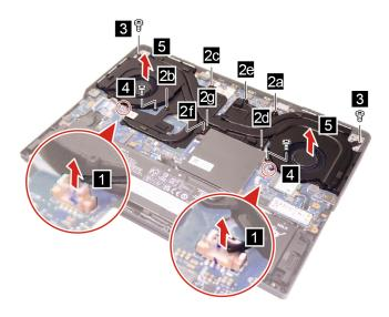
Figure 19. Remove the thermal module
