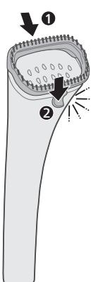
**1** Aliniază ŝina de-a lungul părții superioare a capului aparatului de călcat cu aburi și fixează clema în partea inferioară (face clic).
