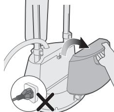
**1** Neprijunkite prietaiso prie elektros lizdo. Ištraukite vandens bakelį iš pagrindo.
