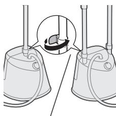
**3** Заблокируйте нижние зажимы-фиксаторы на штанге.
