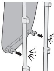
3 Kiinnitä alusta varsiin siten, että se napsahtaa paikalleen.
