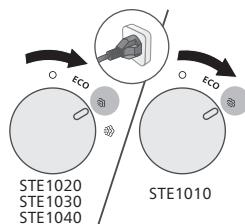
**1** Kontroller at apparatet er koblet til. Drei dampbryteren til ønsket dampinnstilling.
