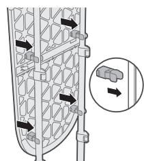
6 Fixează masa pe picioare până când se blochează pe poziție (face clic).
