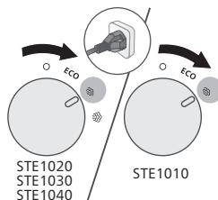
1 确保产品已插上电源。将蒸汽旋钮旋转至所需的蒸汽设置。
