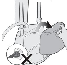
**1** A készülék ne csatlakozzon a hálózati áramforráshoz. Távolítsa el a víztartályt a talapzatról.
