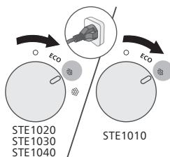
**1** Uverite se da je aparat priključen na napajanje. Okrenite regulator pare na željenu postavku pare.
