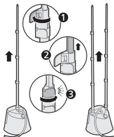
4 解開剩餘的掛桿鎖固定夾，將掛桿完全向上拉出並鎖定。
