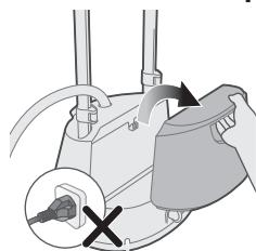
1 Не подключайте прибор к электросети. Снимите резервуар для воды с основания.
