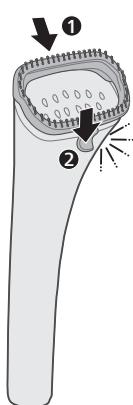
1 Подравнете прореза по протежение на горната част на главата на уреда за пара и щракнете езичето в долната част (с щракване).
