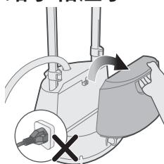
1 确保产品电源插头已拔下。从底座中取出水箱。
