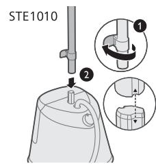
**2** Odomknite svorky zámku spodnej tyče a nasadte tyč(e) na základňu. Zabezpečte, že profily tyče (tyčí) a základnej tyče (základných tyčí) sú zarovnané.
