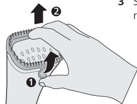
**3** Segure e puxe a lingueta da parte inferior da cabeça do vaporizador para remover o acessório da escova.
