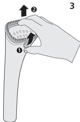
**3** 握住蒸汽熨烫机蒸汽喷头底部的锁扣并将其拉出，可卸下毛刷附件。
