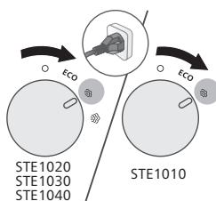
1 Уверете се, че уредът е включен към електрическата мрежа. Завъртете парния регулятор до желаната настройка за пара.
