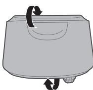
3 Skruva loss vattenbehållarlocket moturs.
