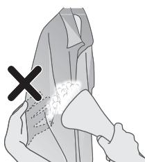
3 Håll inte plagget på ett sätt så att det har direktkontakt med ångan.
