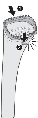
**1** Aline o tubo ao longo da parte superior do bocal do vaporizador e encaixe o trinco da parte inferior (você ouvirá um "clique").
