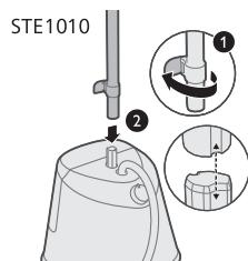
2 گیره های قفل میله پایین را باز کنید و میله(ها) را روی پایه قرار دهید. مطمئن شوید که پروفیل های میله (ها) و گل میخ (ها) پایه در یک راستا قرار دارند.
