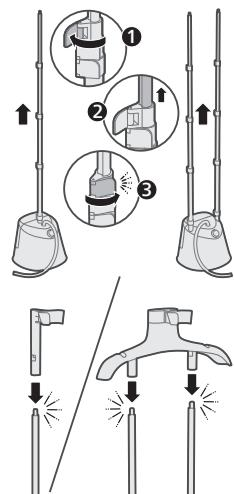
**4** Deblochează clemele de blocare a piciorului rămase, extinde complet picior/picioarele în sus și blochează-l(e).
