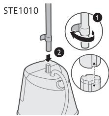
**2** Ontgrendel de vergrendelklemmen van de onderste stang en plaats de stang(en) op de voet. Zorg ervoor dat de profielen van de stang(en) en de stangbout(en) van de voet uitgelijnd zijn.
