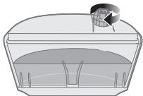
**6** Alinhe com o gancho para colocar o reservatório de água de volta à base.
