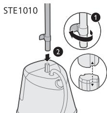
**2** Shkyçni kapëset e kyçjes së shufrës së poshtme dhe futni shufrat në bazament. Sigurohuni që profilet e shufrave dhe mbërthesat e shufrave të bazamentit të jenë në vijë.
