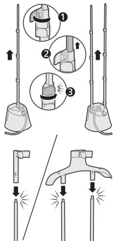
**4** Atbrīvojet pārējos balsta fiksatorus, izvelciet balstu(-us) visā garumā un nostipriniet fiksatorus.
