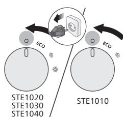
**1** Kontroller at dampbryteren er i AV-stillingen, og at apparatet er koblet fra.
