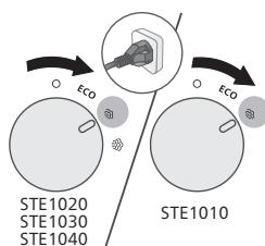
**1** Aparat priključite na električno vtičnico. Gumb za izbiro pare obrnite na želeno nastavitev pare.
