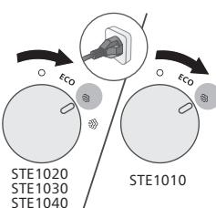
**1** ตรวจสอบให้แน่ใจว่าเสียบปลั๊กไฟเครื่องแล้ว หมุนปุ่มไอน้ำไปยังการตั้งค่าไอน้ำที่ต้องการ
