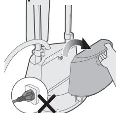
1 Nie podłączaj urządzenia. Wyjmij zbiornik wody z podstawy.
