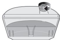
**5** Enrosque a tampa do depósito de água, para a direita, para apertar.
