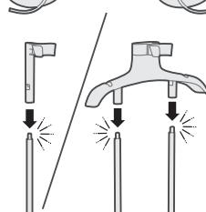
**5** Вставте док-станцію відпарювача на стійку(и) до фіксації.
