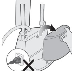
1 Não conecte o aparelho. Remova o reservatório de água da base.
