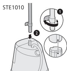
**2** Atfiksuojite apatinio rémo fiksatorius ir įstatykite rémą (-us) į pagrindą. Įsitikinkite, kad rémo (-ų) ir pagrindo rémo (-ų) profiliai yra sulgyiuoti.
