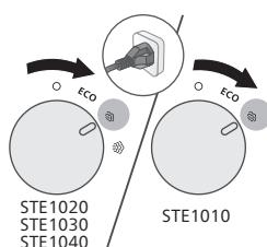
**1** Upewnij się, że urządzenie jest podłączone. Obróć pokrętło pary, aby wybrać żądane ustawienie pary.
