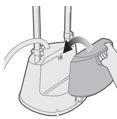
**6** Alinhe com o gancho para voltar a colocar o depósito de água na base.
