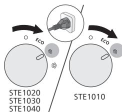
**1** Varmista, että laite on kytketty pistorasiaan. Käännä höyryvalitsin haluamasi höyryasetuksen kohdalle.
