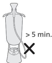
**6** Pokončnega parnega likalnika ne pustite brez nadzora več kot 5 minut.
