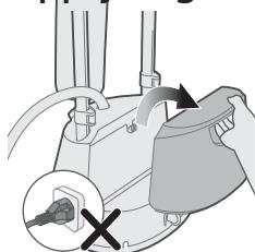
**1** Ikke koble til apparatet. Fjern vannbeholderen fra sokkelen.
