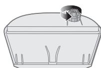
**3** Az óramutató járásával ellentétes irányban csavarja le a víztartály kupakját.
