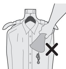
4 使用蒸汽熨烫机蒸汽喷头时切勿向下握持。
