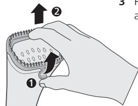
**3** Prinde și trage clema din partea inferioară a capului aparatului de călcat cu aburi pentru a scoate accesoriul perie.
