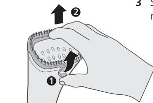
3 Segure e puxe o trinco da parte inferior do bocal do vaporizador para remover a escova.
