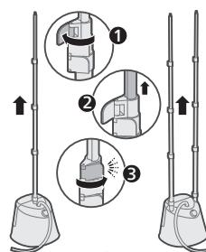
**4** Разблокируйте оставшиеся зажимы-фиксаторы штанги, полностью выдвиньте штанги вверх и зафиксируйте их.
