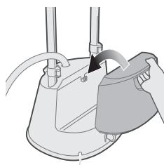
6 Ευθυγραμμίστε με το άγκιστρο για να τοποθετήσετε το δοχείο νερού πίσω στη βάση.
