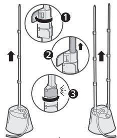
**4** Lås opp de gjenværende låseklemmene for stengene, trekk helt ut stengene og lås dem.
