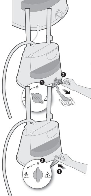
**4 将除垢旋钮转到解锁位置，然后取下除垢旋钮。将水排空。**
