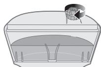
**5** Kiinnitä vesisäiliön korkki takaisin paikalleen kiertämällä sitä myötäpäivään.
