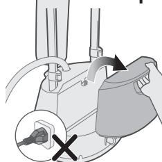
**1** Não ligue o aparelho à corrente. Retire o depósito de água da base.
