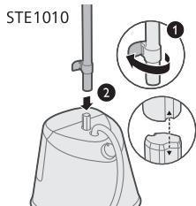
**2** Atbrīvojet apakšējā balsta fiksatorus un ievietojiet balstu(-us) pamatnē. Pārliecinieties, ka balsta(-u) un pamatnes balsta tapas(-u) profili ir savstarpēji salāgoti.
