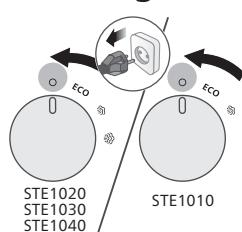
**1** Győződjön meg arról, hogy a gőzsabályzó tárcsa OFF állásban van, és a készülék le van választva a hálózati áramforrásról.
