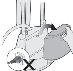
**1** Aparata ne priključujte na električno vtičnico. Iz podstavka odstranite posodo za vodo.
