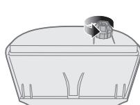
**3** Desenrosque a tampa do depósito de água, para a esquerda, para a retirar.
