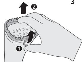
3 抓住蒸氣噴頭底部的鎖扣並拉出，即可拆下毛刷配件。
