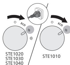
1 Đảm bảo thiết bị đã được cắm điện. Xoay núm điều chỉnh hơi phun đến cài đặt hơi nước mong muốn.
