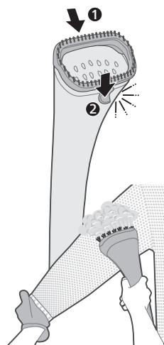
**1** 沿着蒸汽熨烫机蒸汽喷头的顶部对齐导轨，并锁住底部的锁扣（听到“咔哒”一声）。
