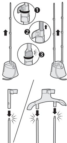
**4** Odblokuj pozostałe zaciski blokujące stojaka, całkowicie wysuń stojak do góry i zablokuj go.
