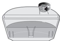
5 Draai de dop van het waterreservoir met de klok mee dicht.
