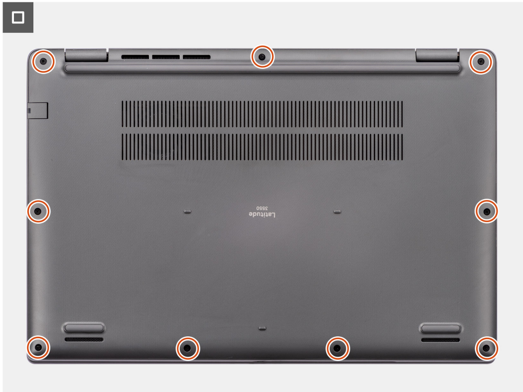
Figure 11. Installation du cache de fond
