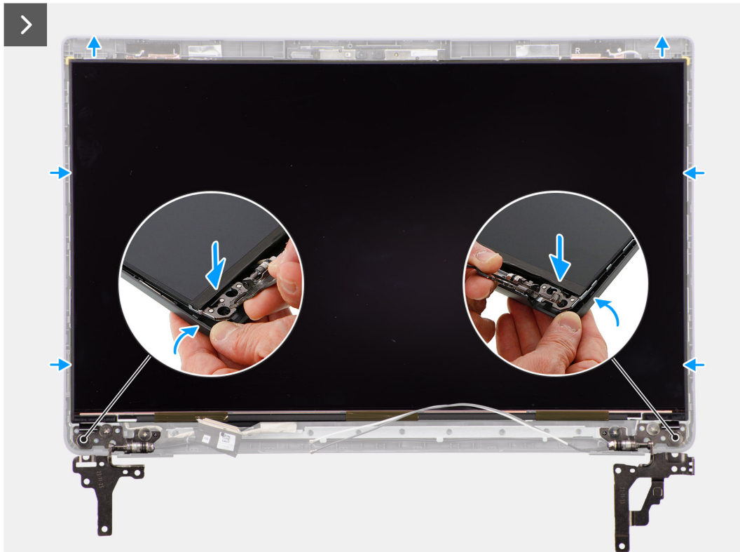
Figure 64. Installation du panneau d'écran
