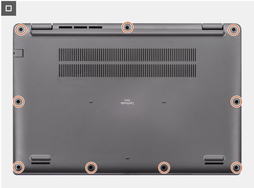
Abbildung 11. Anbringen der Bodenabdeckung
