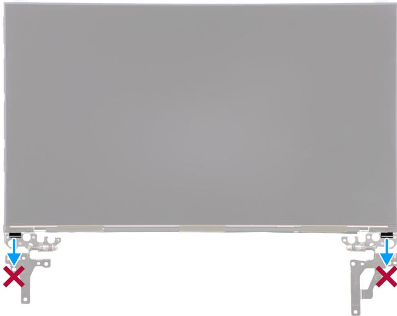
1. Entfernen Sie die sechs Schrauben (M2,5x2,5), mit denen das linke und das rechte Scharnier an der hinteren Bildschirmabdeckung befestigt sind.
