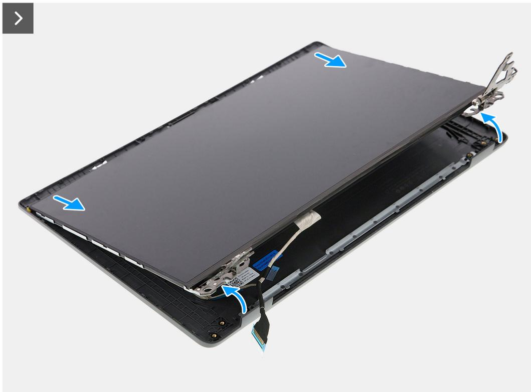
Abbildung 58. Entfernen des Bildschirms
