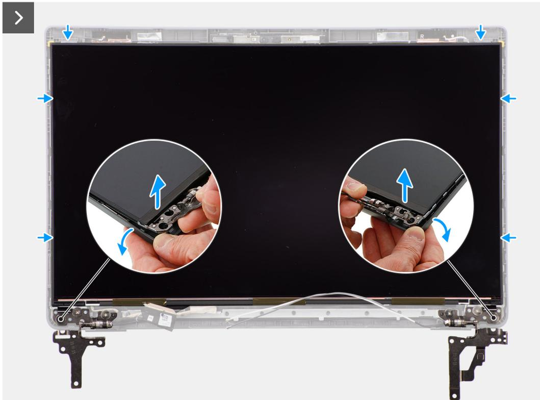
Abbildung 57. Entfernen des Bildschirms
