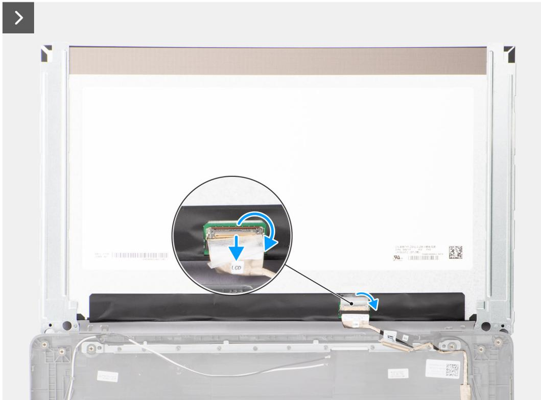
Abbildung 59. Entfernen des Bildschirms
