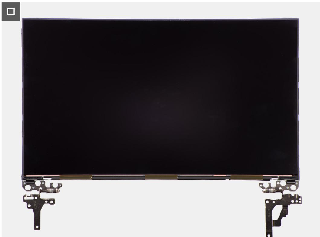
Abbildung 60. Entfernen des Bildschirms
