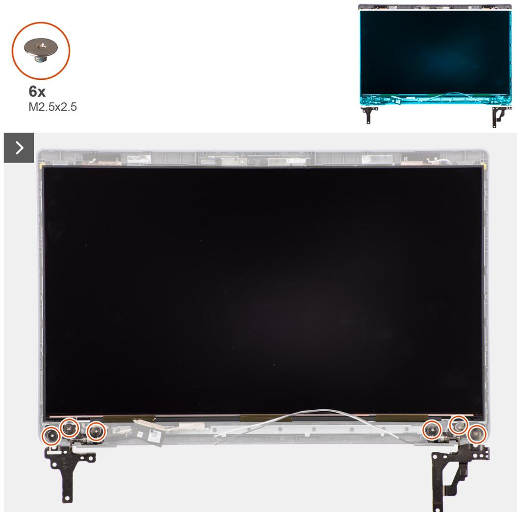
Abbildung 56. Entfernen des Bildschirms
