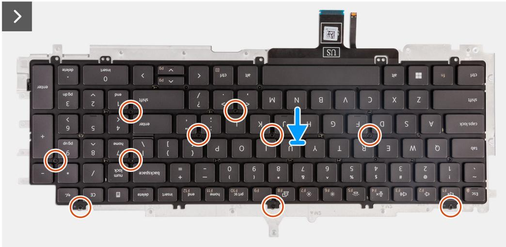
Figure 71. Installation du clavier
