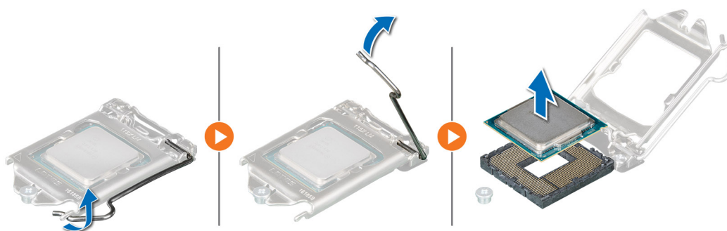
Figure 53. Retrait du processeur
