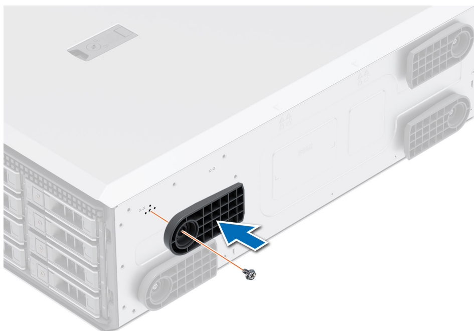
Figure 15. Installation des pieds du système
