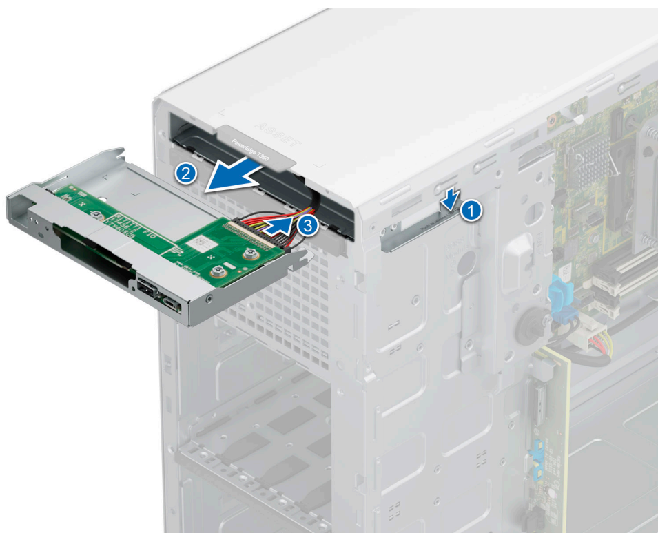
Figure 93. Retrait du bâti du panneau de commandes
