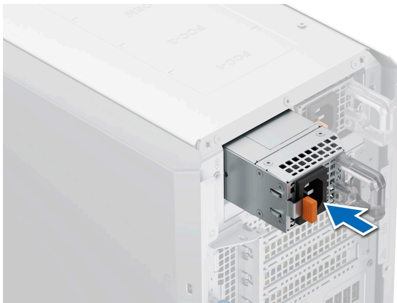
Figure 79. Installation d'un bloc d'alimentation
