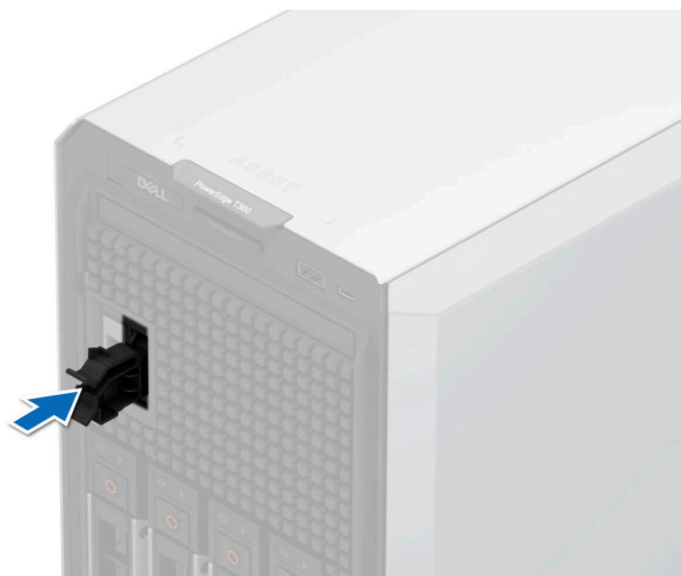
Figure 72. Installation du cache du support de carte BOSS-N1
