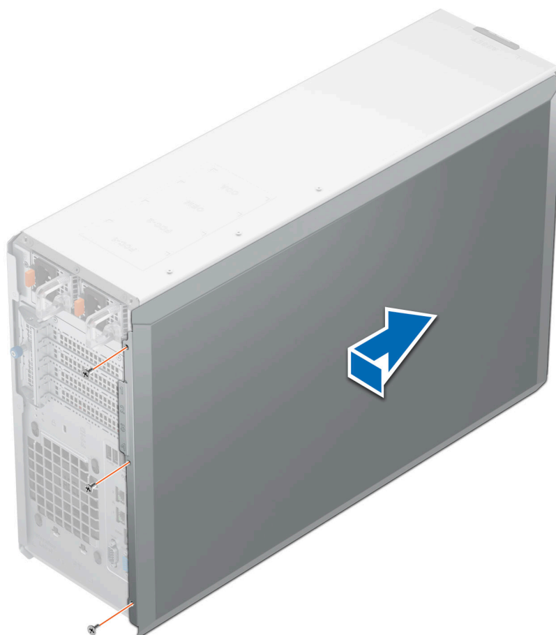
Figure 98. Installation du capot latéral du système
