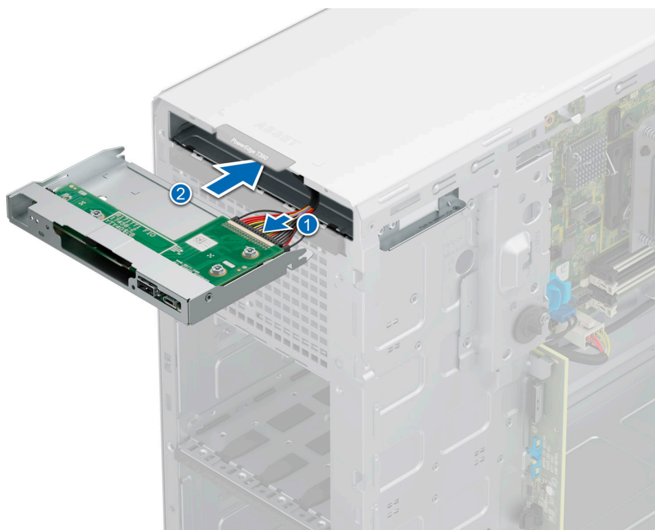
Figure 96. Installation du bâti du panneau de commandes
