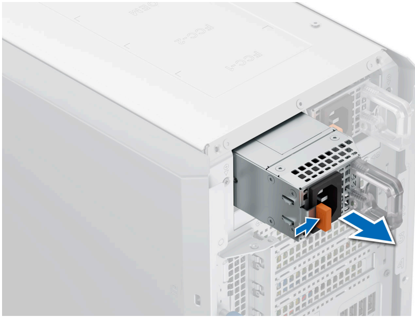
Figure 78. Retrait d'un bloc d'alimentation
