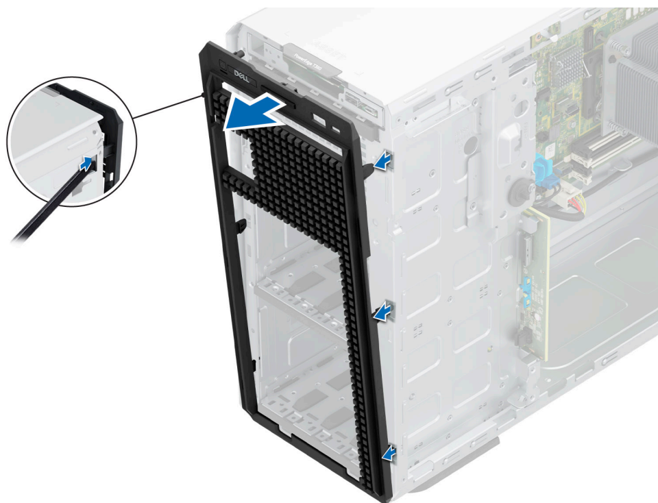
Figure 92. Retrait de la plaque avant
