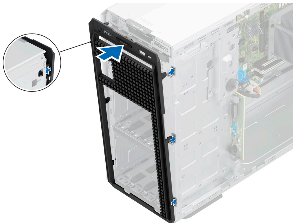
Figure 97. Installation de la plaque avant
