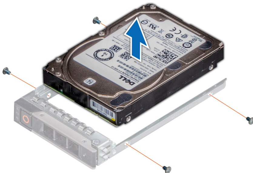
Figure 28. Retrait d'un disque dur installé de son support
