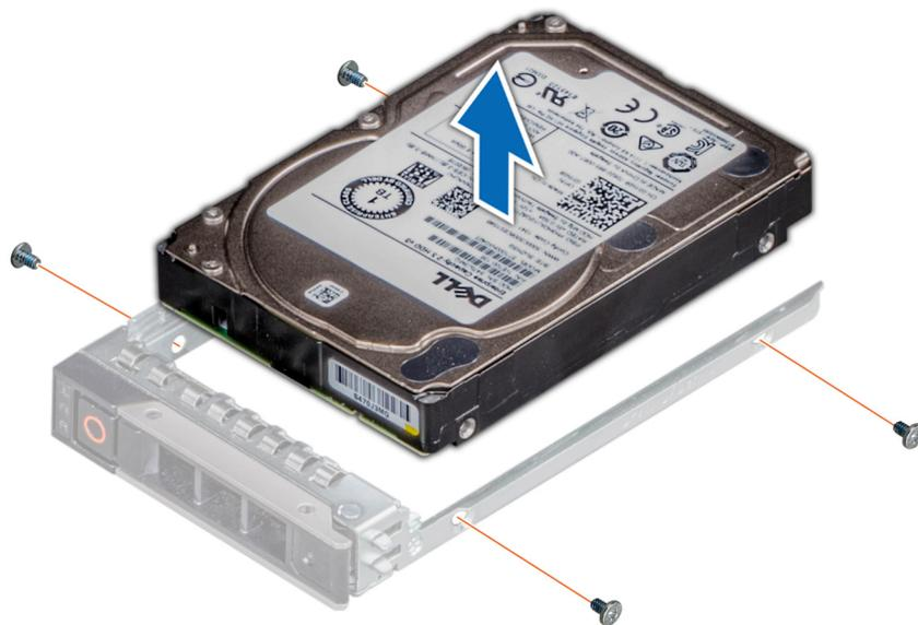
Abbildung 28. Laufwerk aus Laufwerksträger entfernen
