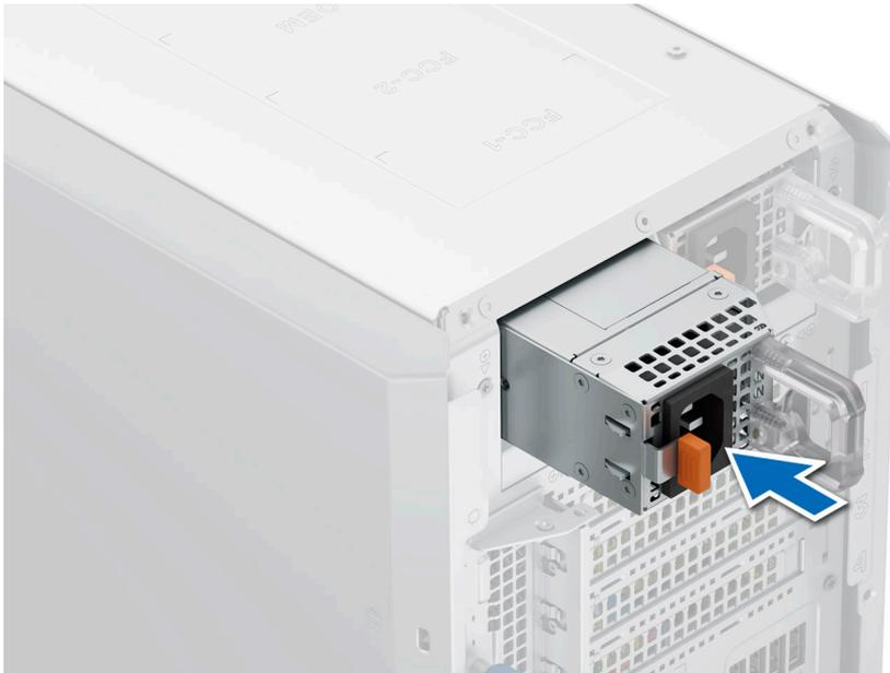
Abbildung 79. Installieren eines Netzteils
