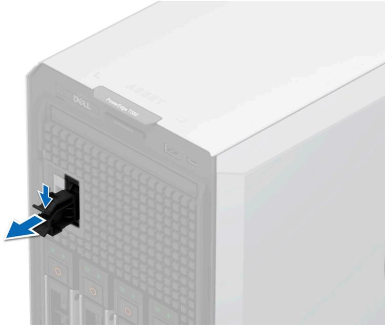
**Abbildung 99. Entfernen des Platzhalters für das BOSS-N1-Modul**
