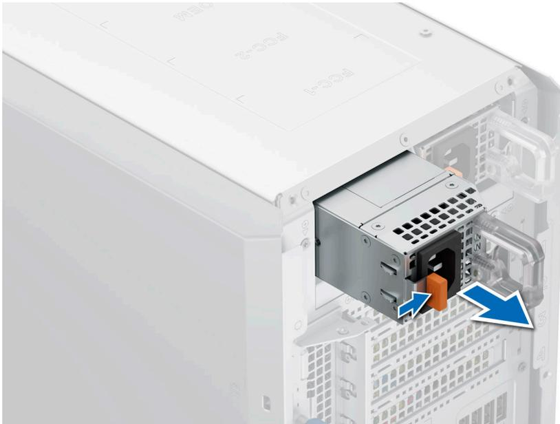
Abbildung 78. Entfernen eines Netzteils
