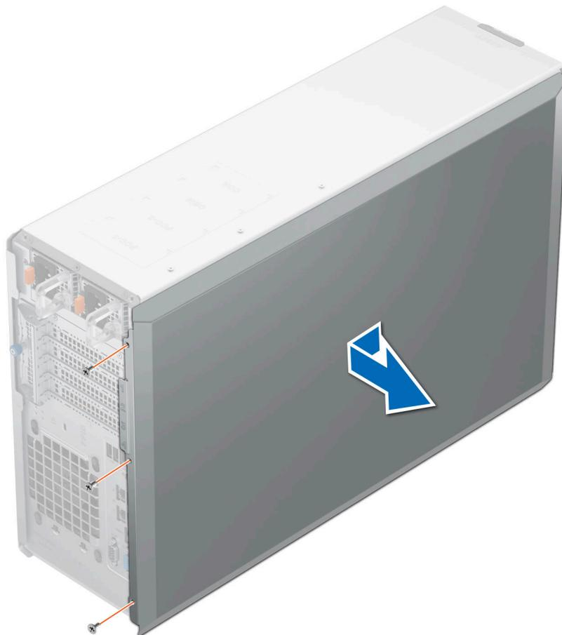
**Abbildung 91. Entfernen der Seitenabdeckung des Systems**
