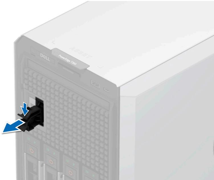
**Abbildung 73. Entfernen des Platzhalters für den BOSS-N1-Kartenträger**
