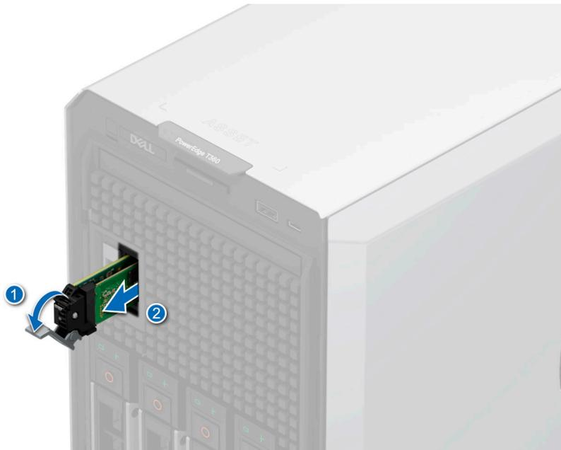
**Abbildung 70. Entfernen des BOSS-N1-Kartenträgers**
