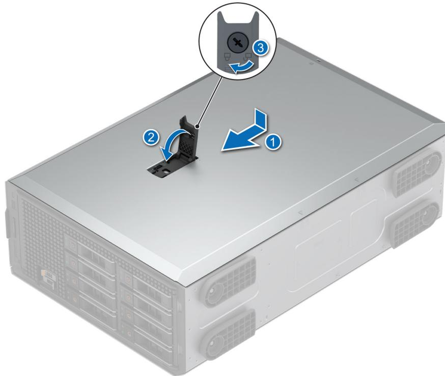
**Abbildung 17. Installieren der Systemabdeckung**
