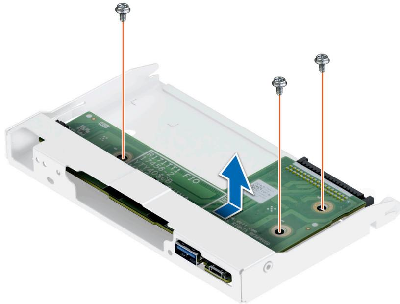
Abbildung 94. Entfernen der Bedienfeldbaugruppe
