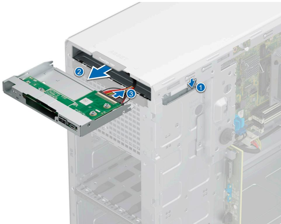
**Abbildung 93. Entfernen des Bedienfeldgehäuses**
