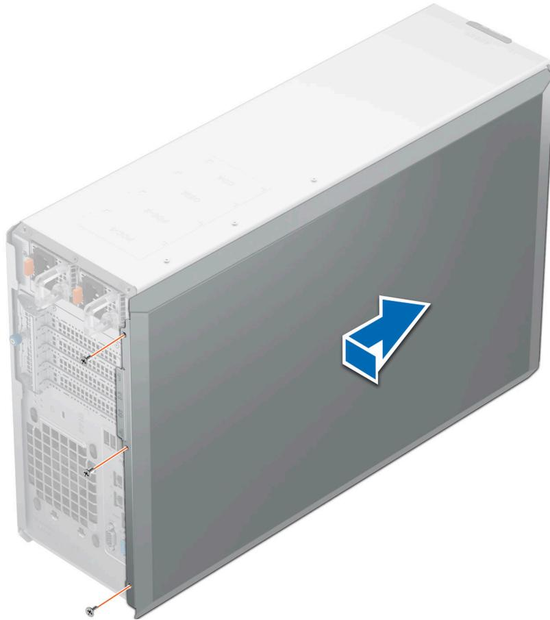
**Abbildung 98. Installieren der Seitenabdeckung des Systems**
