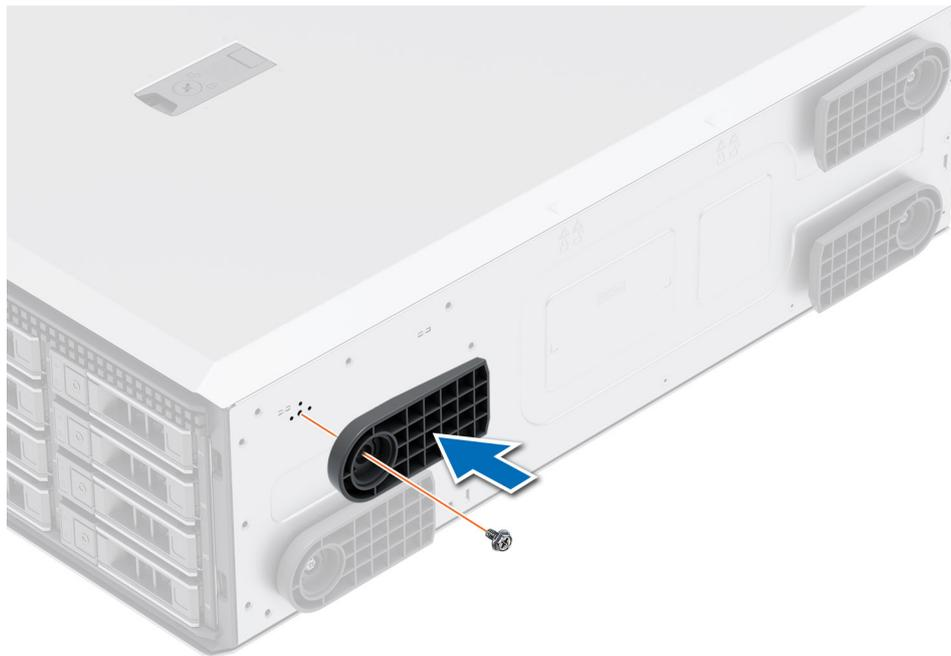
**Abbildung 15. Installieren der Systemstandfüße**
