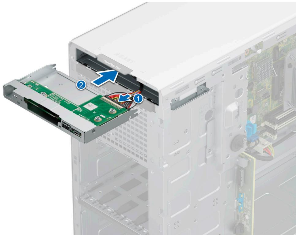
**Abbildung 96. Installieren des Bedienfeldgehäuses**
