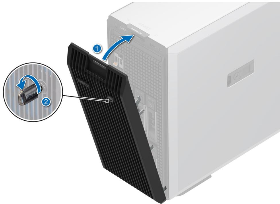
Abbildung 13. Installieren der Frontverkleidung
