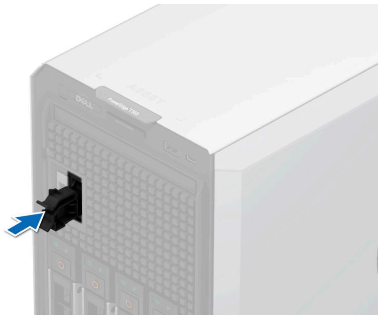
**Abbildung 67. Installieren des Platzhalters für das BOSS-N1-Modul**
