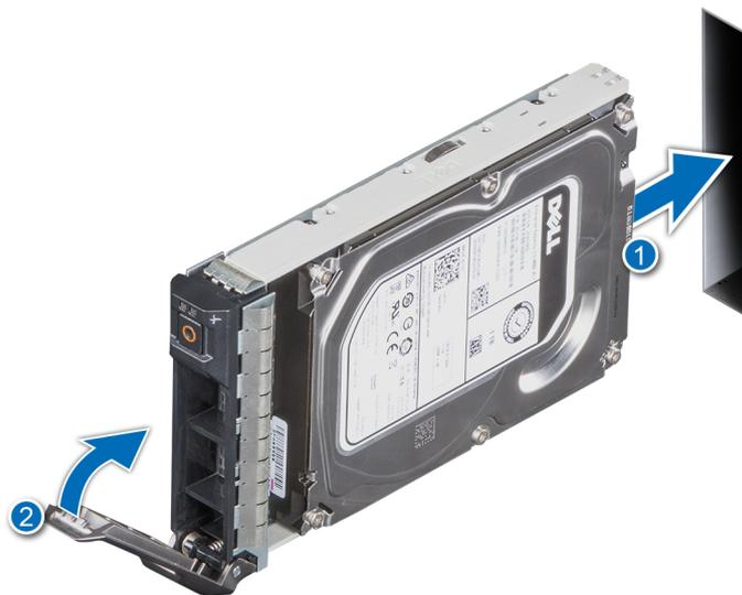
Abbildung 27. Installieren eines Laufwerksträgers
