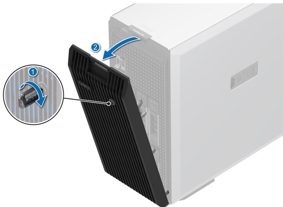
Abbildung 12. Entfernen der Frontverkleidung
