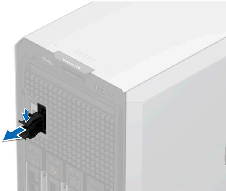
Abbildung 68. Entfernen des Platzhalters für das BOSS-N1-Modul
