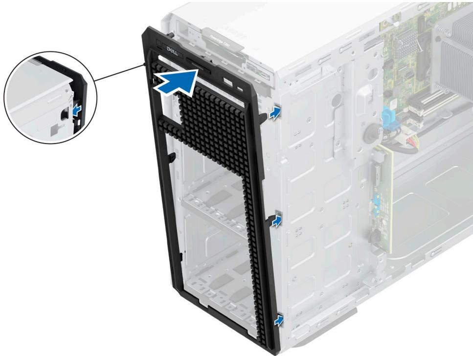
**Abbildung 97. Anbringen der vorderen Abdeckplatte**
