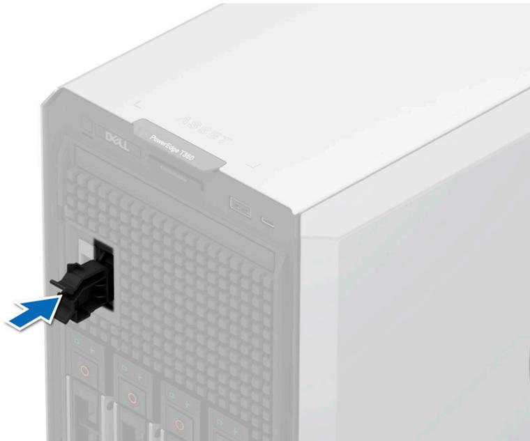
**Abbildung 100. Installieren des Platzhalters für das BOSS-N1-Modul**
