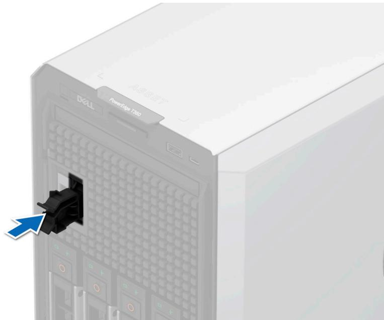
**Abbildung 72. Installieren des Platzhalters für den BOSS-N1-Kartenträger**
