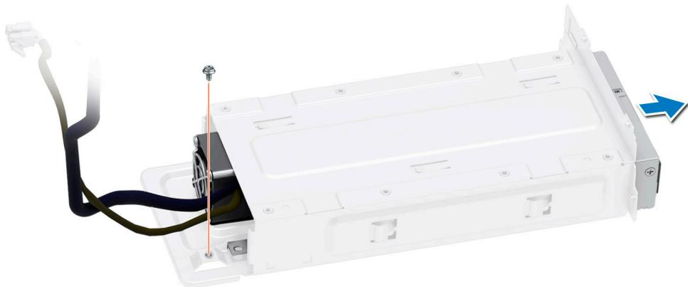
**Abbildung 81. Entfernen eines verkabelten Netzteils**
