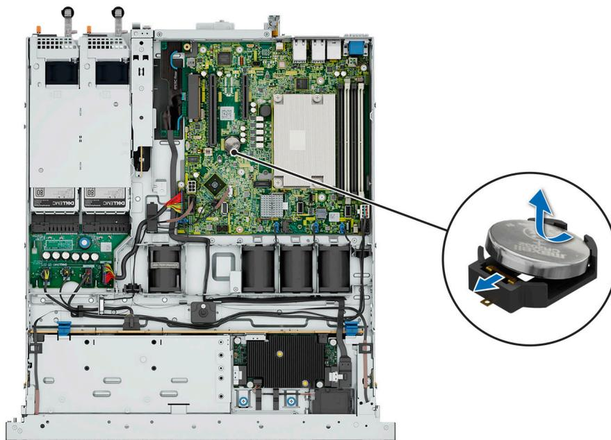
**Figure 63. Retrait de la pile du système**
