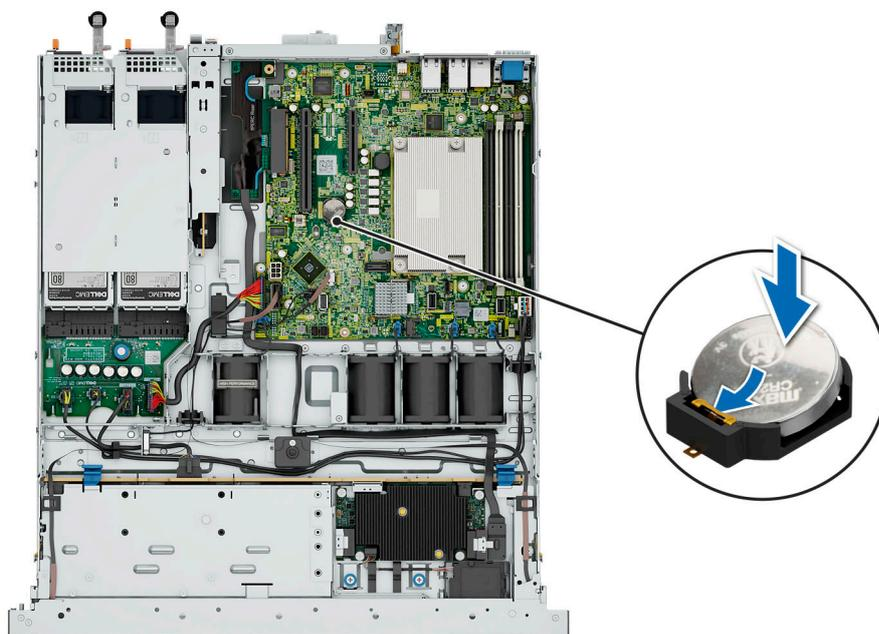
**Figure 64. Installation de la pile du système**
