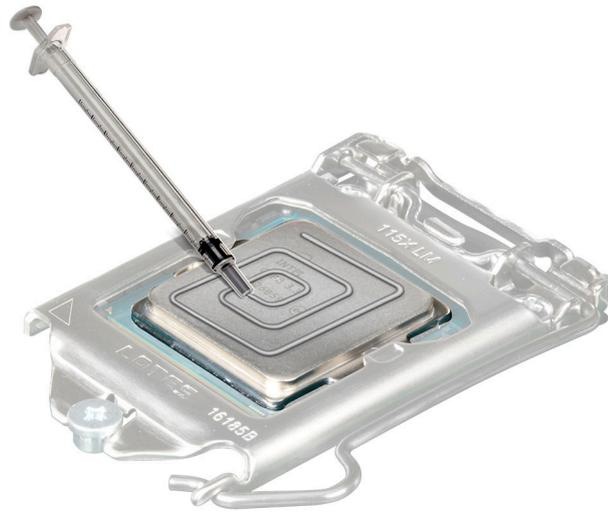
**Figure 48. Application de graisse thermique**
