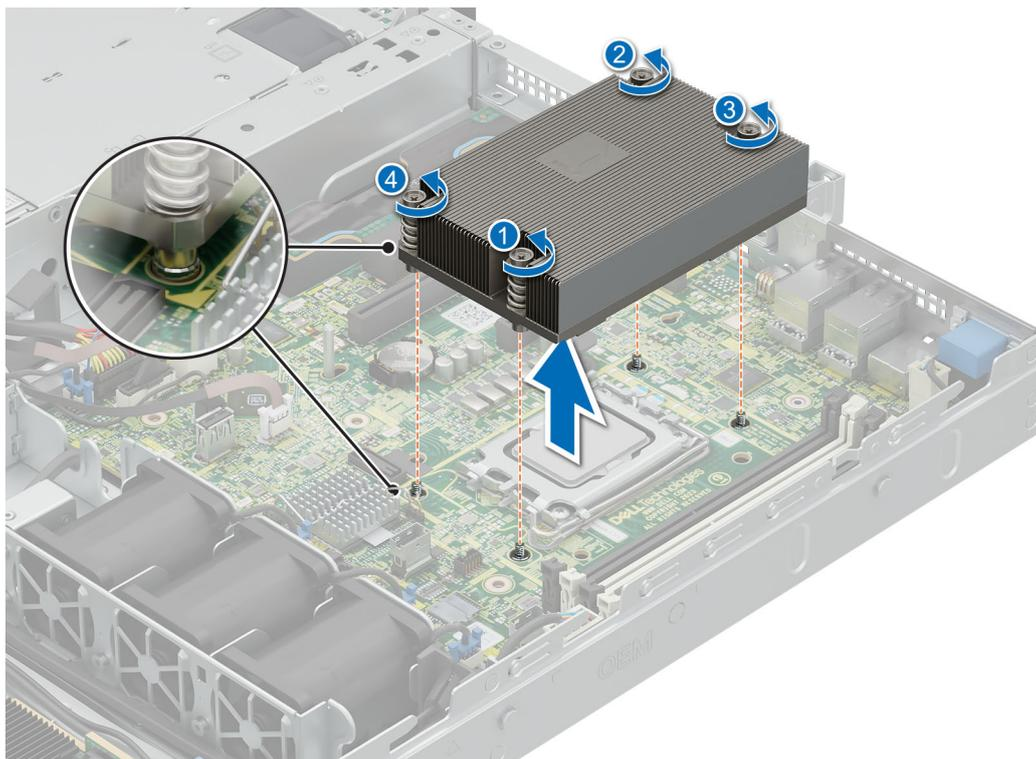
Figure 44. Retrait du module du dissipateur de chaleur
