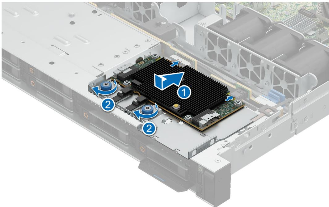
**Figure 69. Installation du module PERC avant**
