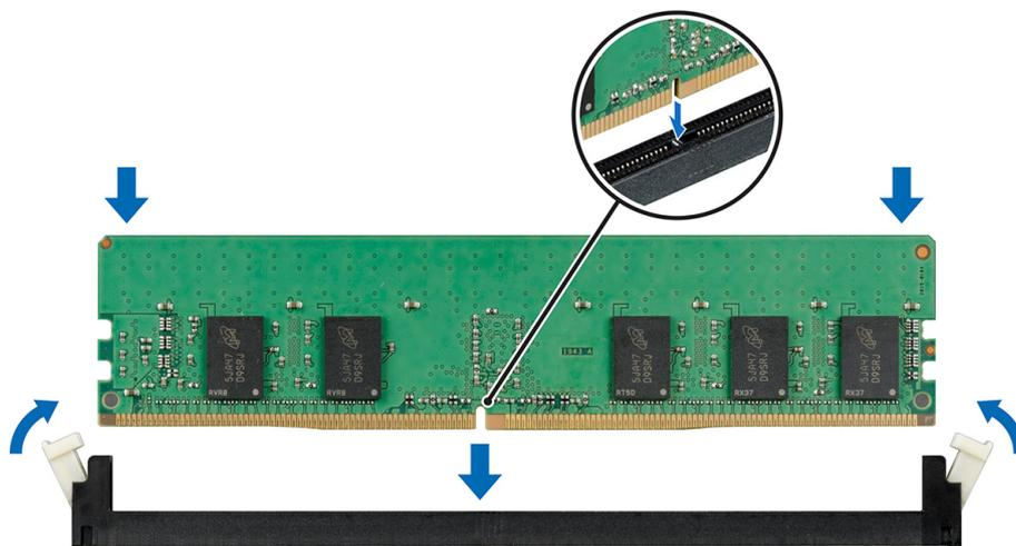
Figure 43. Installation d'un module de mémoire
