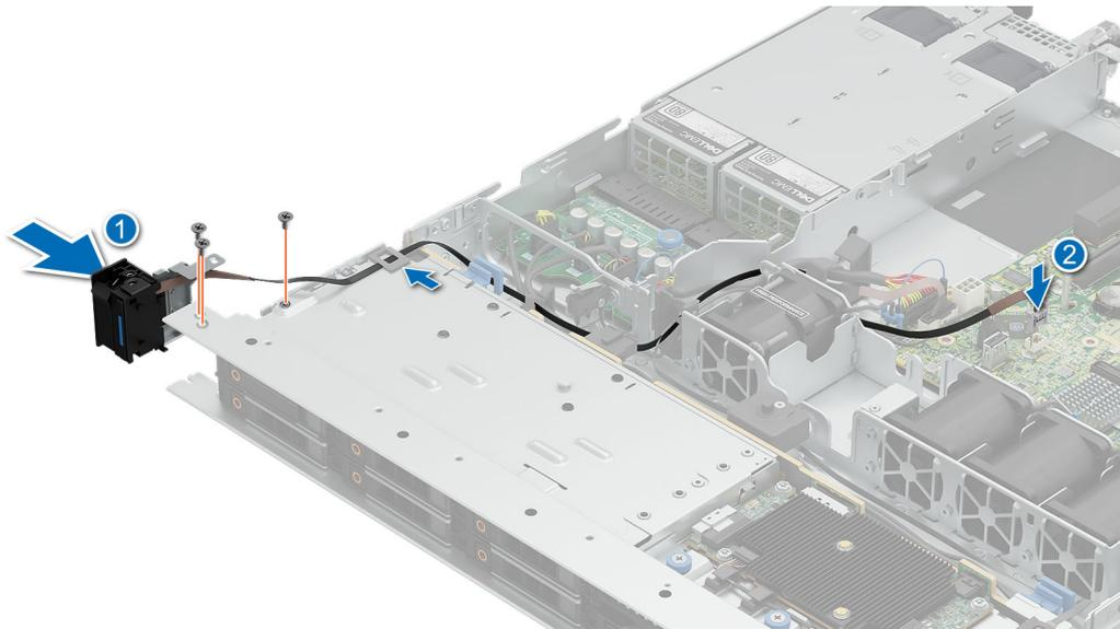
**Figure 83. Installation du panneau de configuration gauche**
