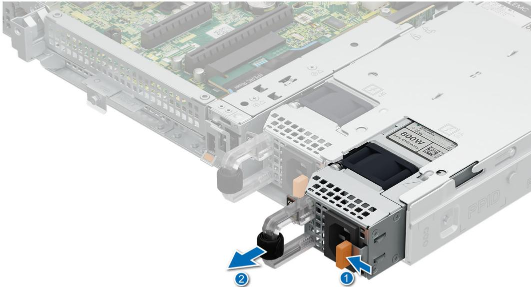
Figure 74. Installation d'un bloc d'alimentation
