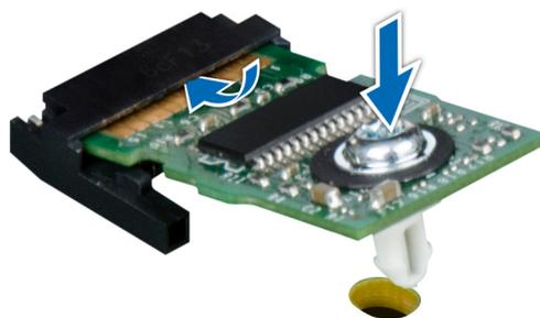
Figure 79. Installation du module TPM
