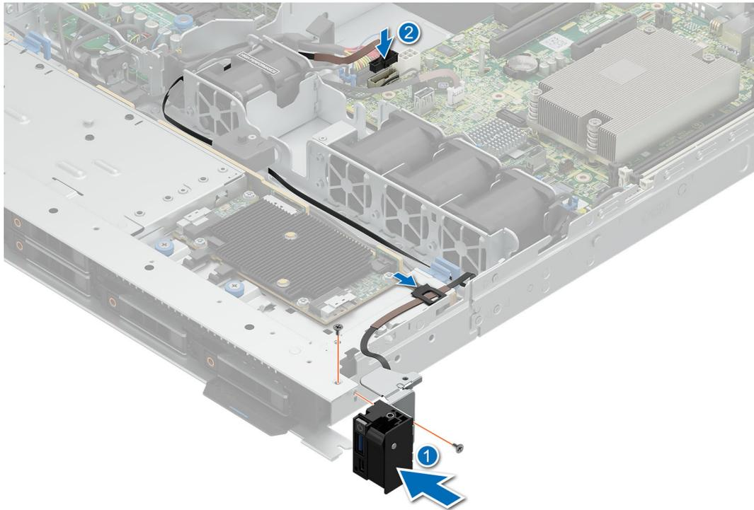
Figure 81. Installation du panneau de configuration droit
