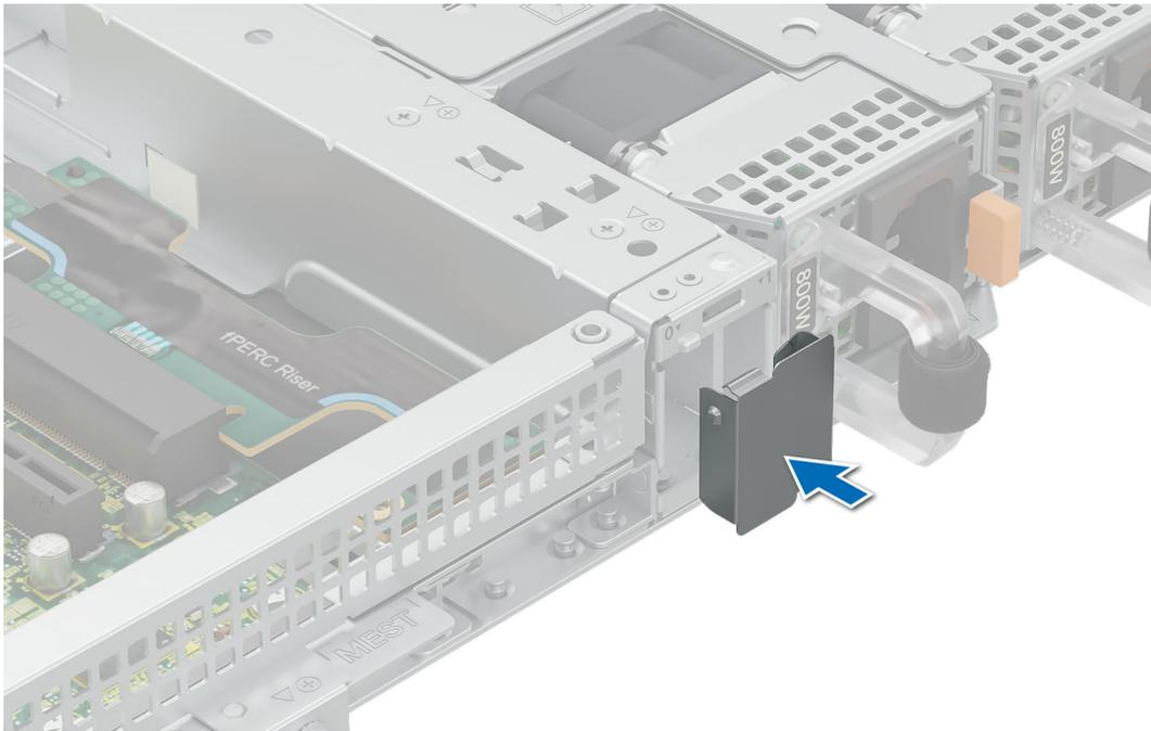
**Figure 85. Installation du cache du module BOSS-N1**
