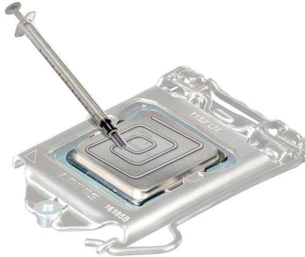
Figure 47. Application de graisse thermique
