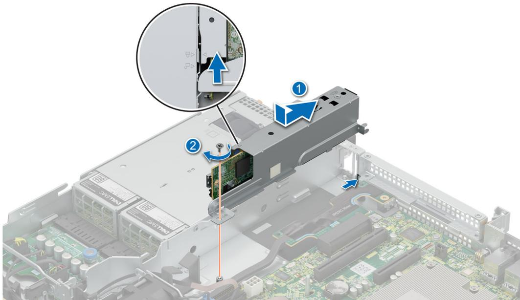
**Figure 59. Installation du bâti du module BOSS N1**
