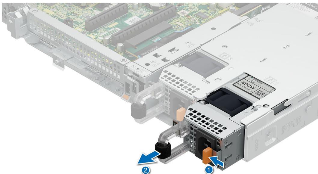
Figure 73. Retrait d'un bloc d'alimentation
