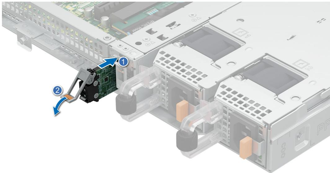
Figure 60. Installation du module BOSS N1 M2
