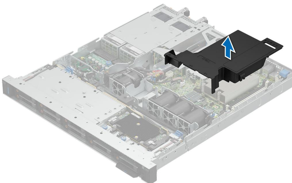
Figure 18. Retrait du carénage d'aération
