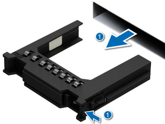
Figure 33. Retrait d'un cache de disque
