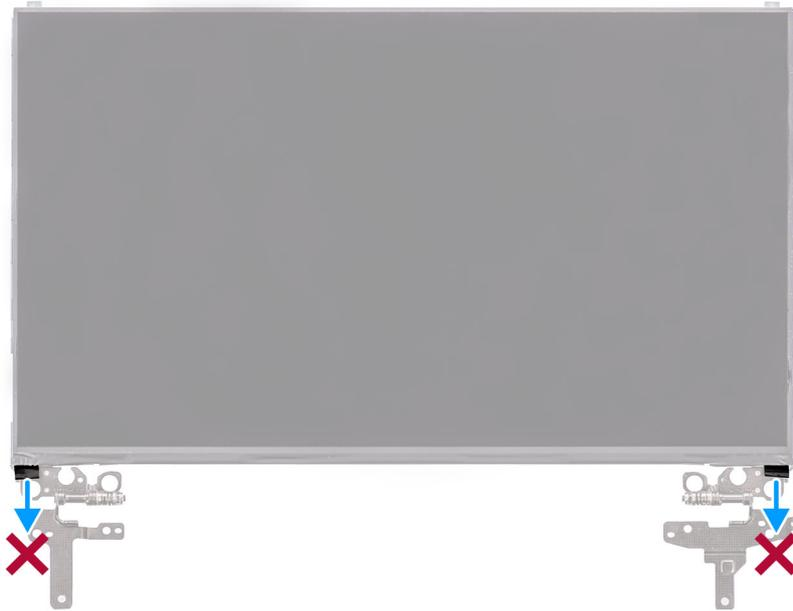
1. Quite los seis tornillos (M2.5x2.5) que fijan las bisagras izquierda y derecha a la cubierta posterior de la pantalla.
