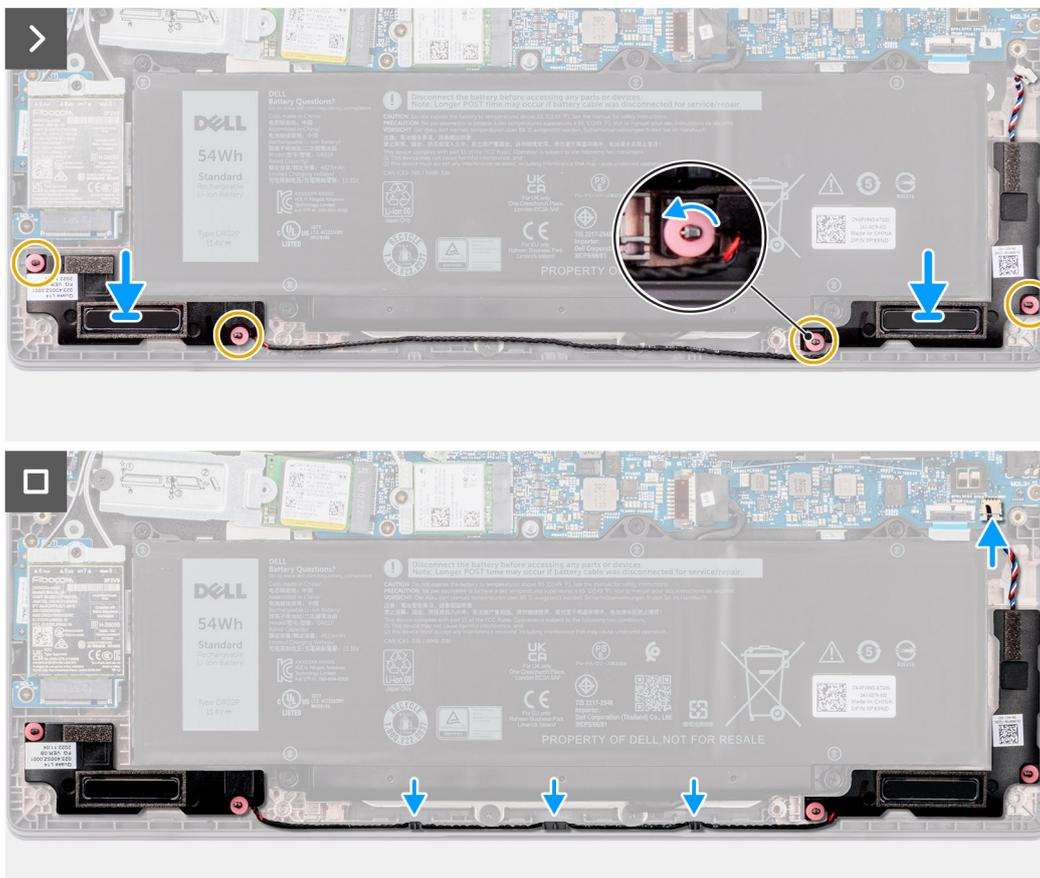
**Ilustración 22. Instalación de los parlantes**
