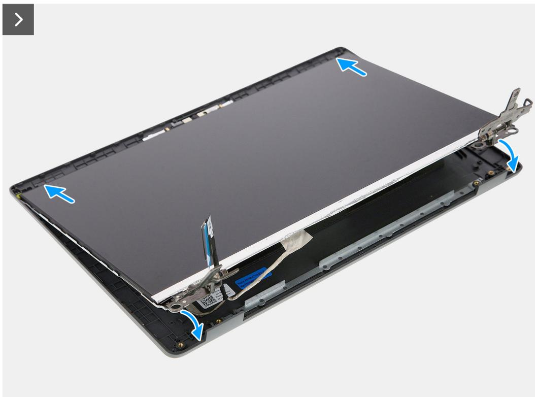
**Ilustración 61. Instalación del panel de pantalla**
