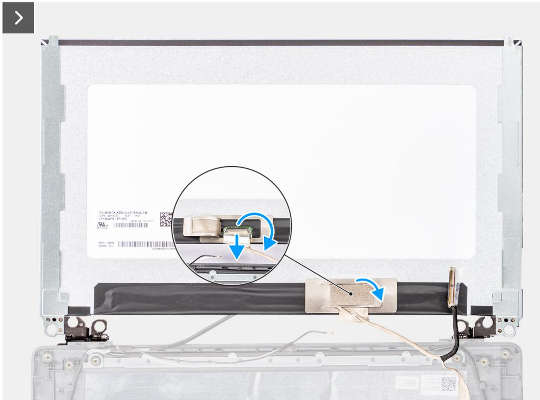
**Ilustración 57. Extracción del panel de pantalla**
