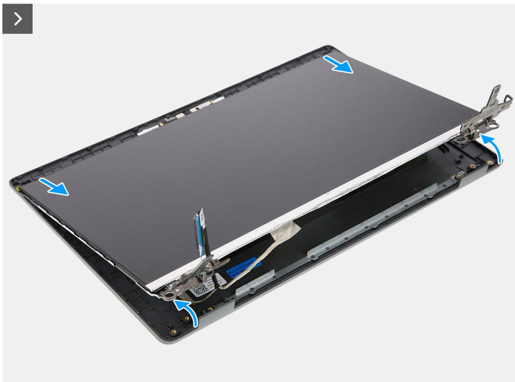
Ilustración 56. Extracción del panel de pantalla
