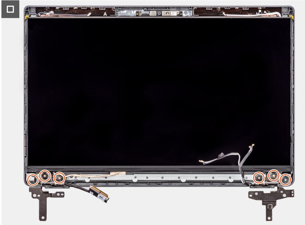
**Ilustración 63. Instalación del panel de pantalla**
