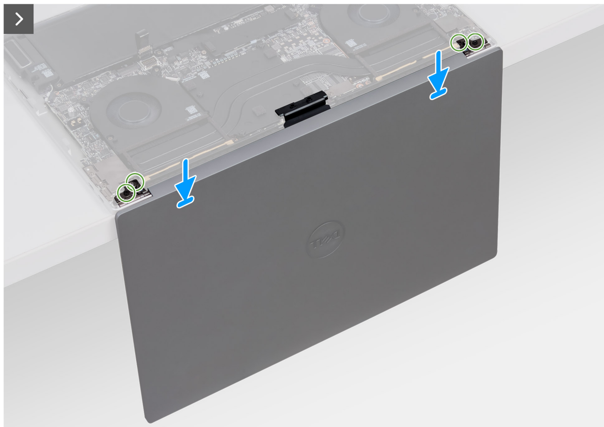
Ilustración 42. Instalación del ensamblaje de la pantalla
