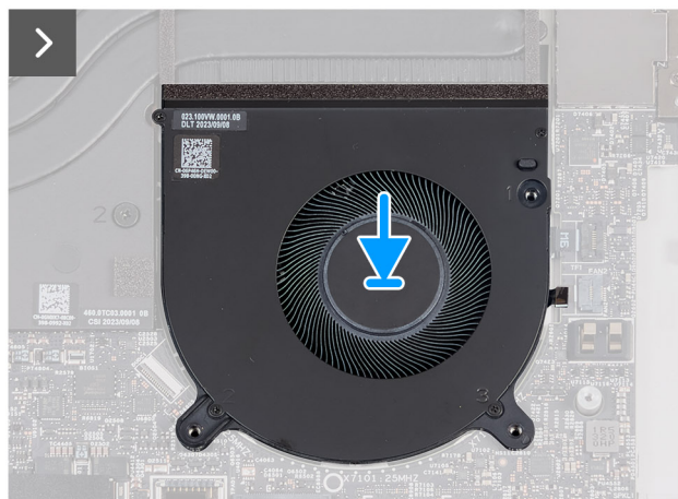
Ilustración 26. Instalación del ventilador de la CPU
