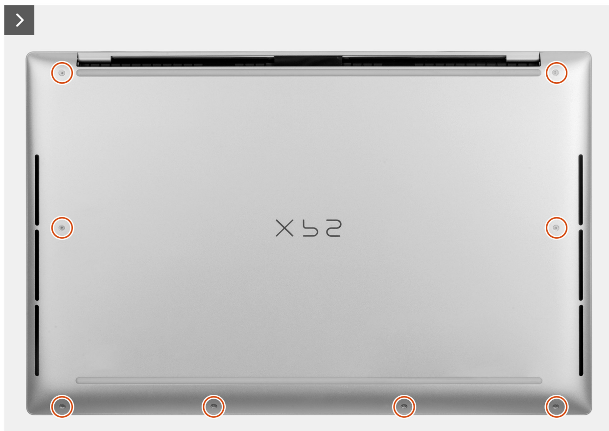
Ilustración 14. Extracción de la cubierta de la base
