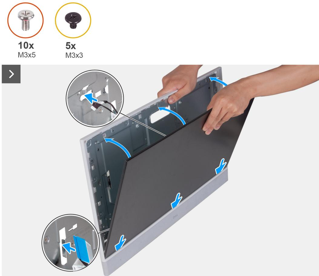
**Ilustración 62. Instalación del panel de pantalla**
