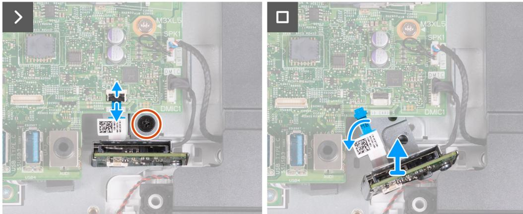
**Ilustración 46. Extracción del lector de tarjetas de medios**
