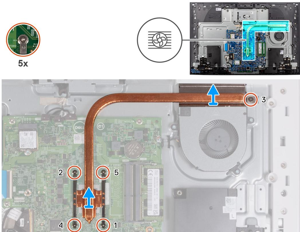
**Ilustración 42. Extracción del disipador de calor: UMA**
