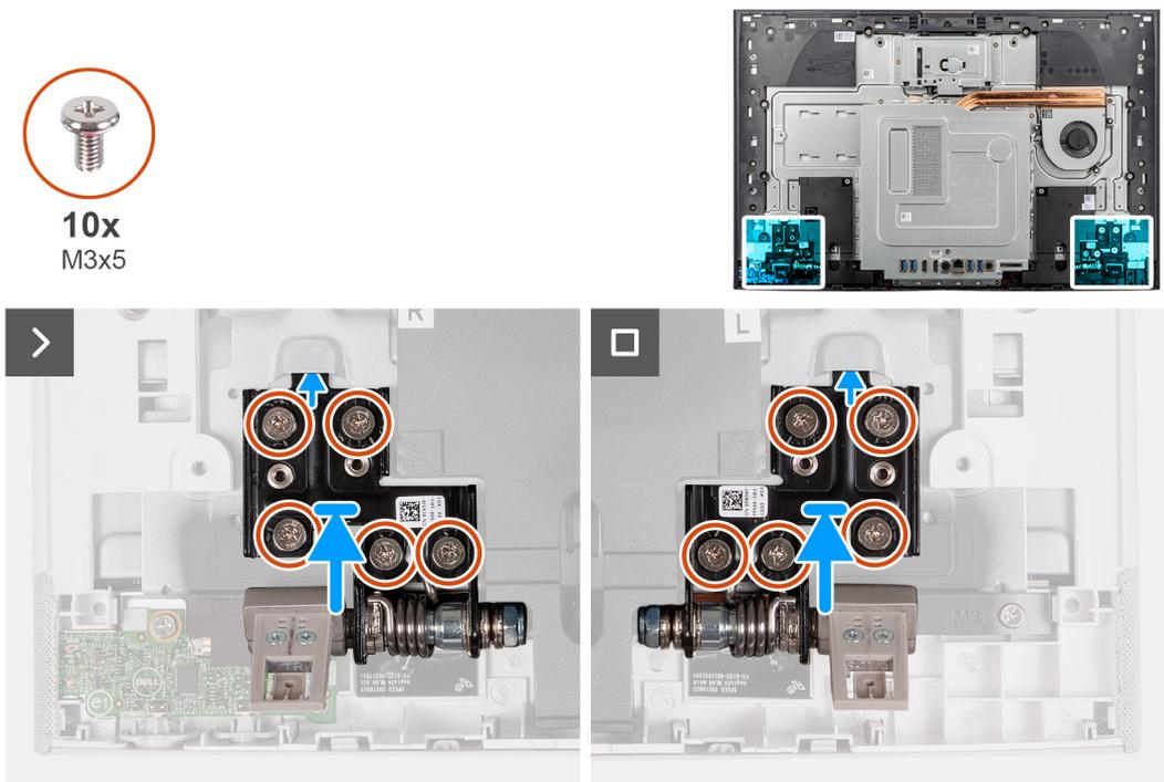
**Ilustración 25. Instalación de las bisagras del soporte**
