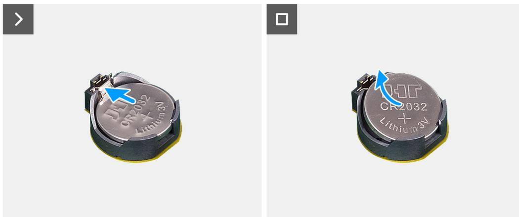
**Ilustración 40. Extracción de la batería de tipo botón**
