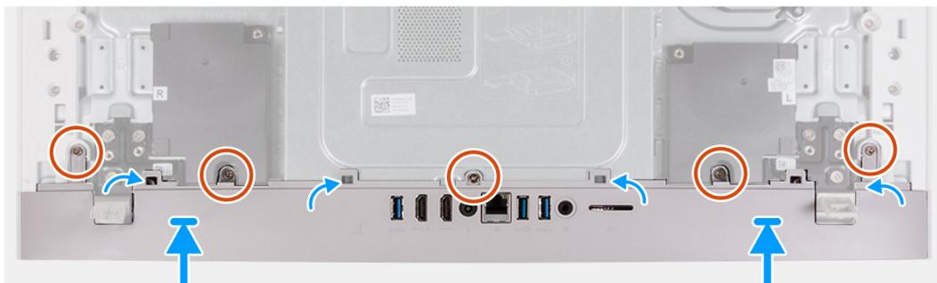
**Ilustración 23. Instalación de la cubierta inferior**
