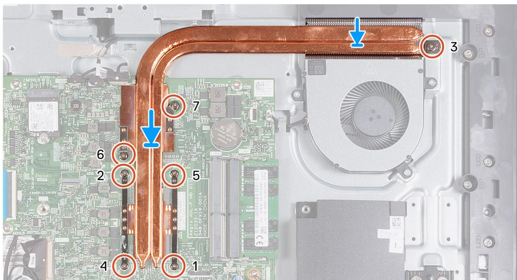
**Ilustración 45. Instalación del disipador de calor: discreto**
