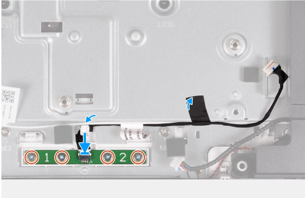
**Ilustración 57. Instalación de los micrófonos**
