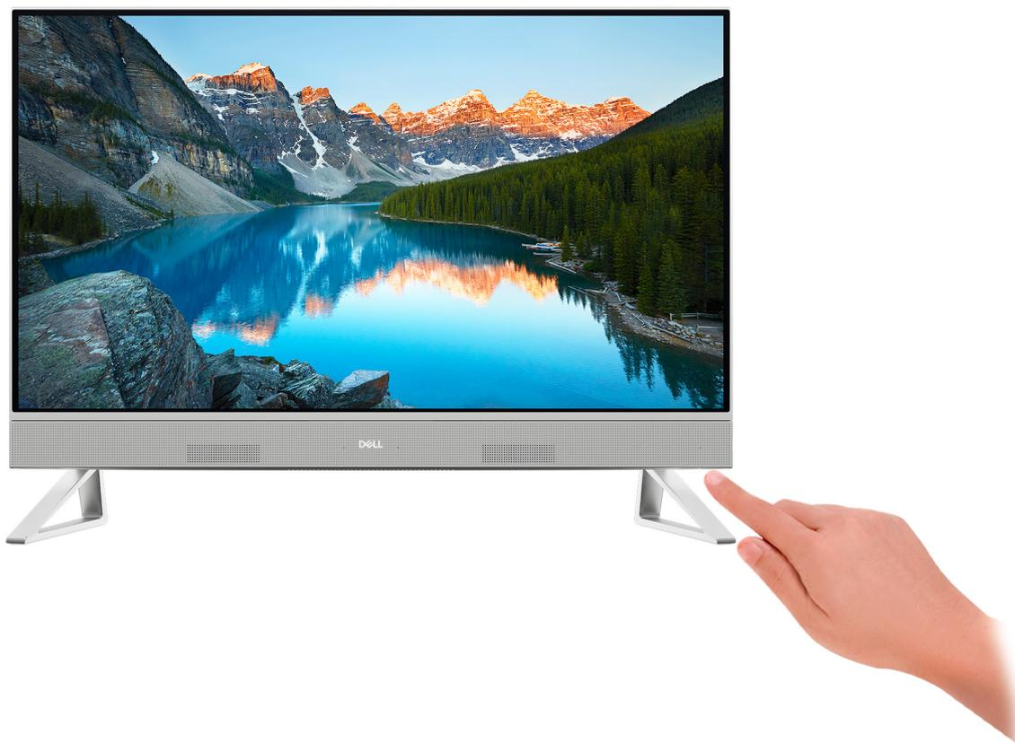
**Ilustración 12. Presione el botón de encendido**
