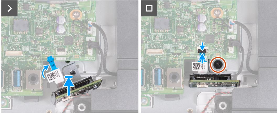
**Ilustración 47. Instalación del lector de tarjetas de medios**
