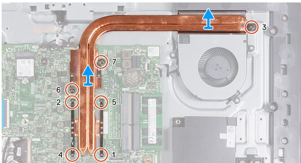
**Ilustración 44. Extracción del disipador de calor: discreto**
