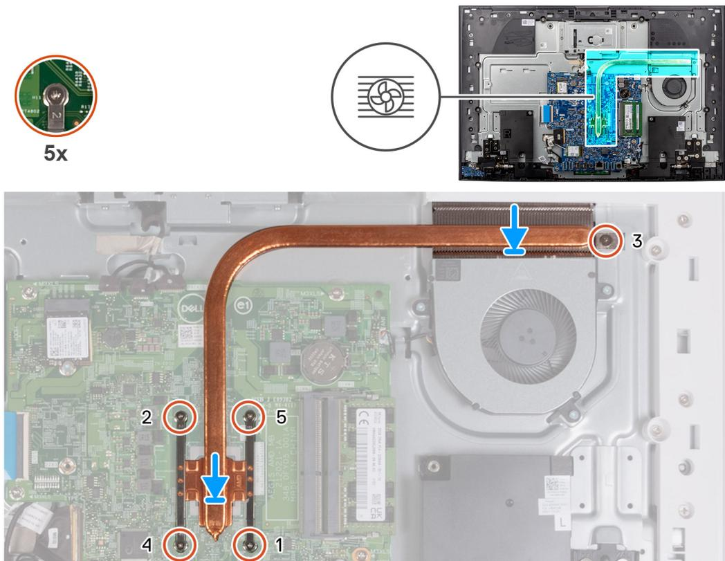
**Ilustración 43. Instalación del disipador de calor: UMA**
