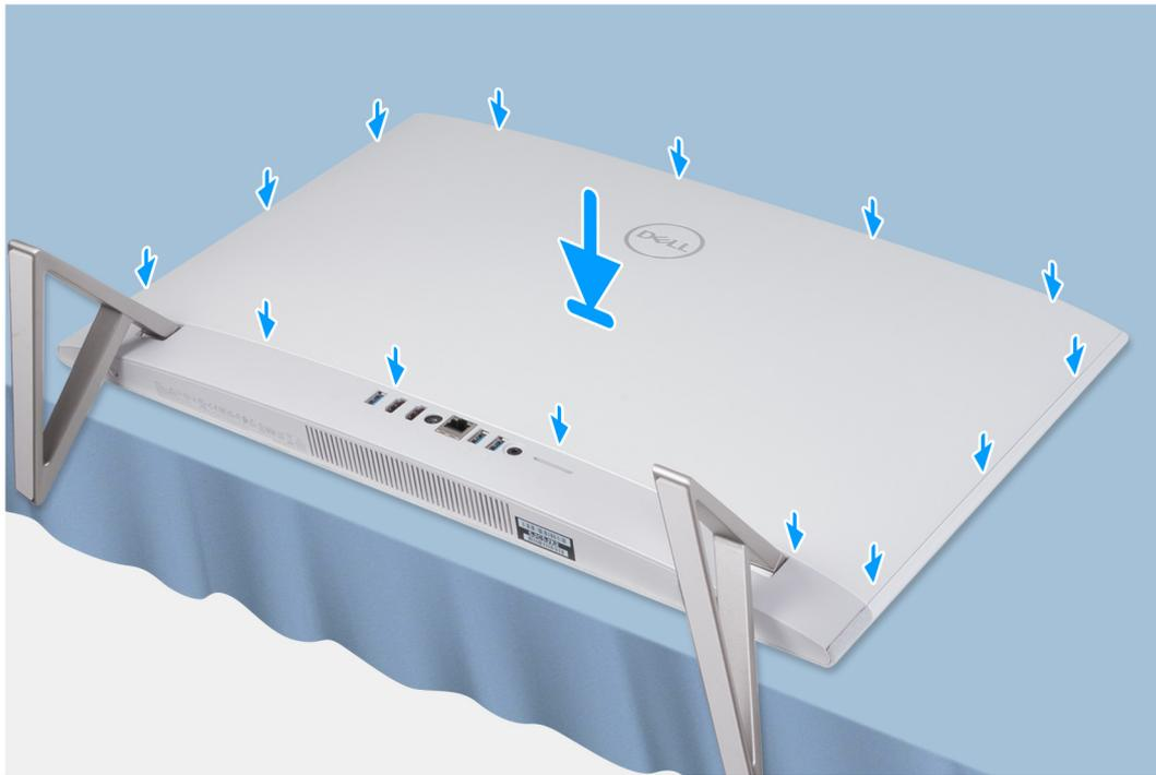
**Ilustración 21. Instalación de la cubierta posterior**
