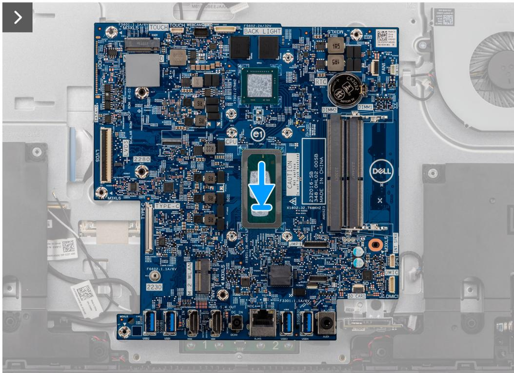
**Ilustración 54. Coloque la tarjeta madre en el chasis**
