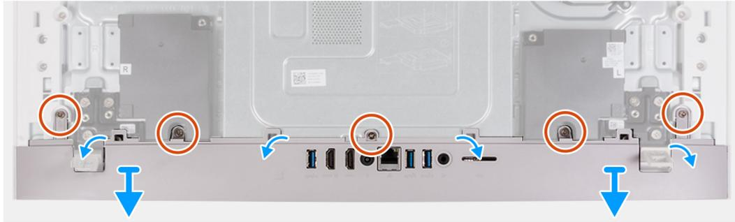
**Ilustración 22. Extracción de la cubierta de I/O**
