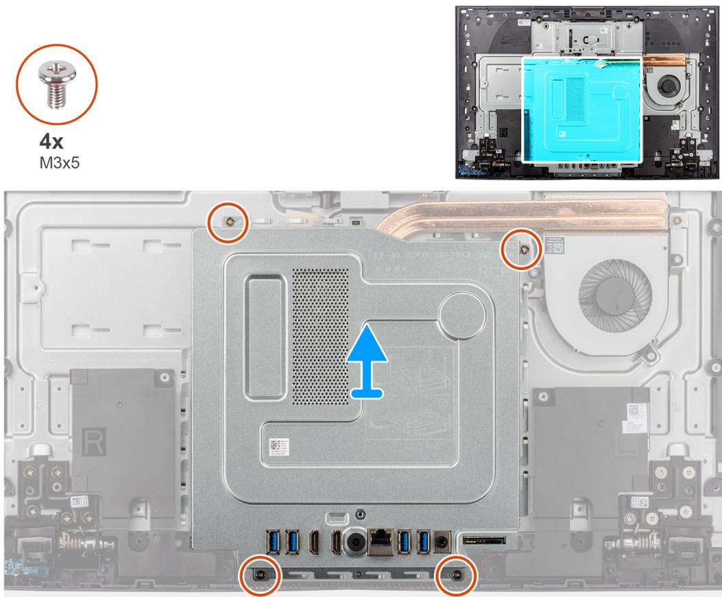
Ilustración 26. Extracción del protector de la tarjeta madre
