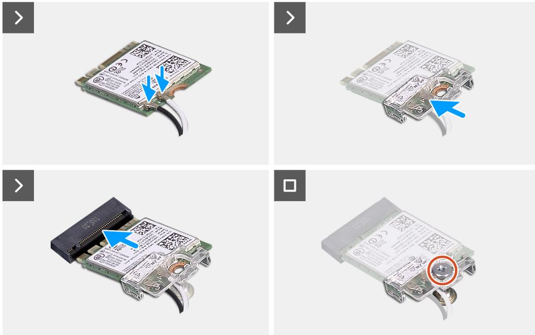
**Ilustración 33. Instalación de la tarjeta inalámbrica**
