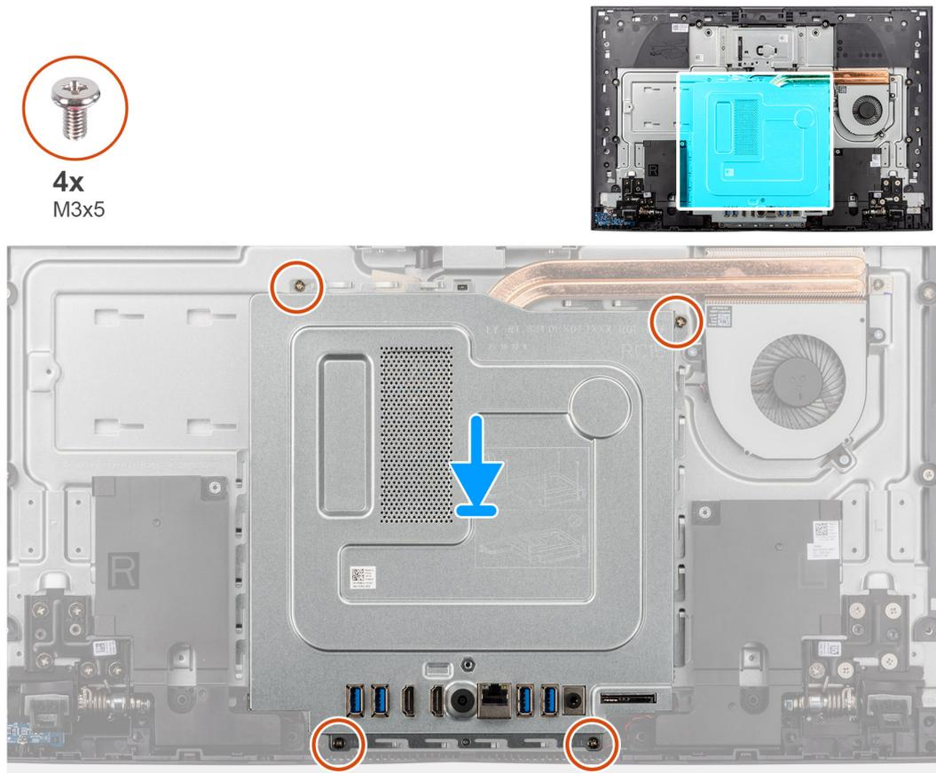
**Ilustración 27. Instalación del protector de la tarjeta madre**
