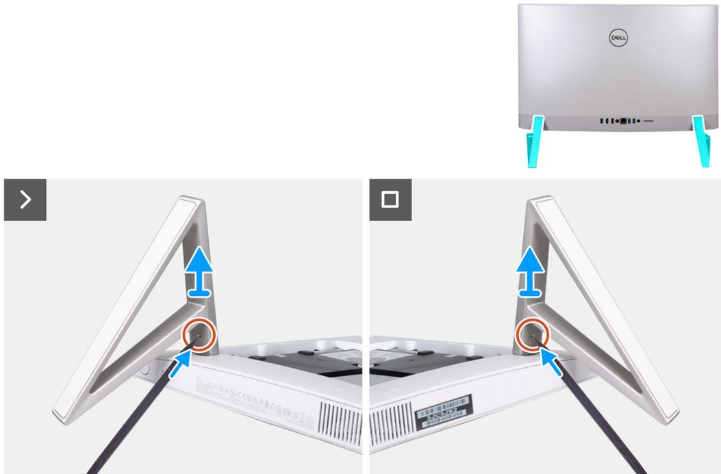
**Ilustración 17. Extracción de la base**
